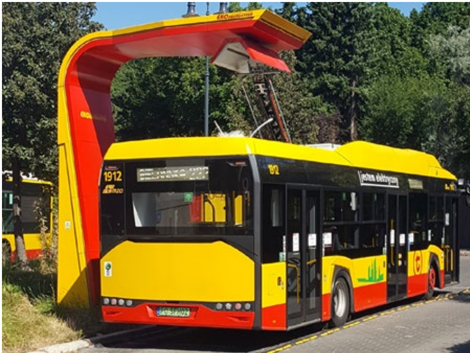
Figura 5 – Ônibus sendo recarregado via pantógrafo em Varsóvia, na Polônia
