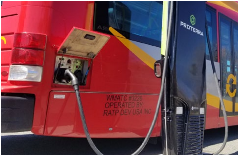
Figura 4 – Infraestrutura de recarga do tipo plug-in tradicional em Washington, D.C., nos Estados Unidos
