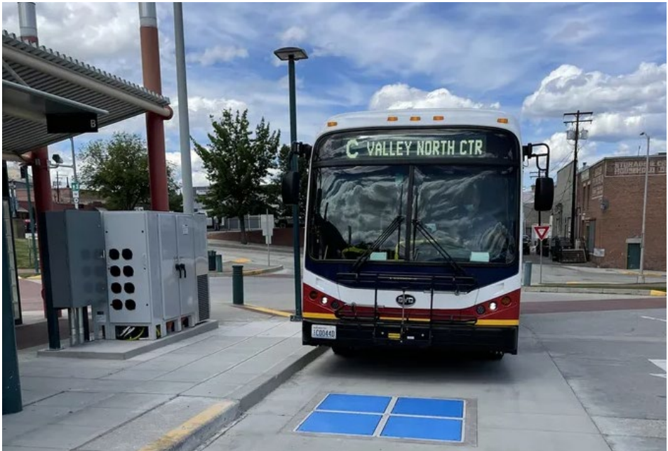
Figura 6 – Ônibus elétrico no estado de Washington, se aproxima de uma infraestrutura de carregamento indutivo embutida no solo
