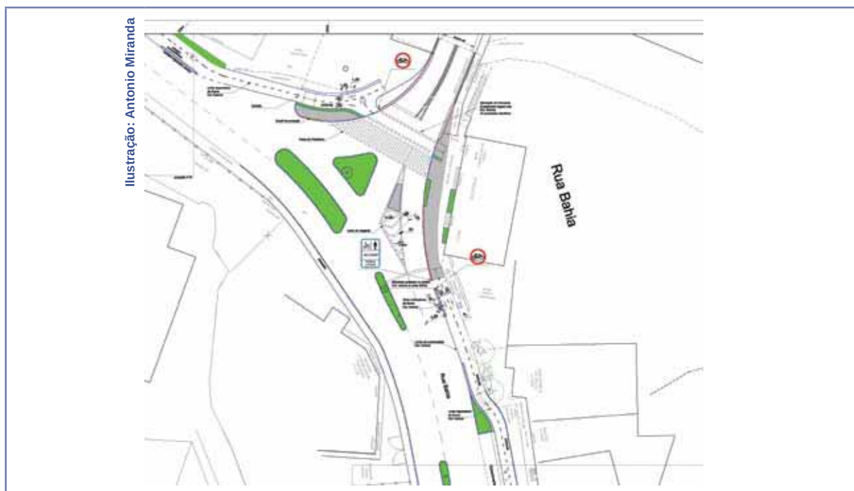
FIGURA 151 - Interseção Ponte do Salto x Rua Bahia, com a inclusão de tramos ciclovitários. Blumenau-SC, Brasil, 2006.
