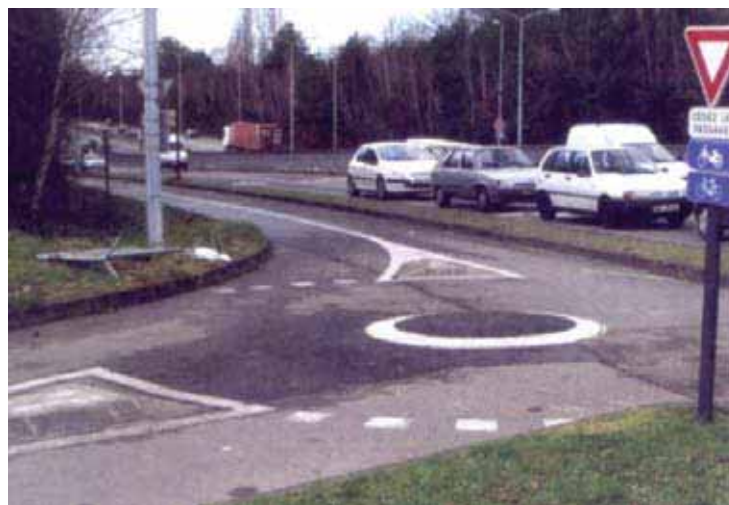
Rotatória pintada no solo, com pequena elevação na ilha central, na junção de dois tramos ciclovitários.
