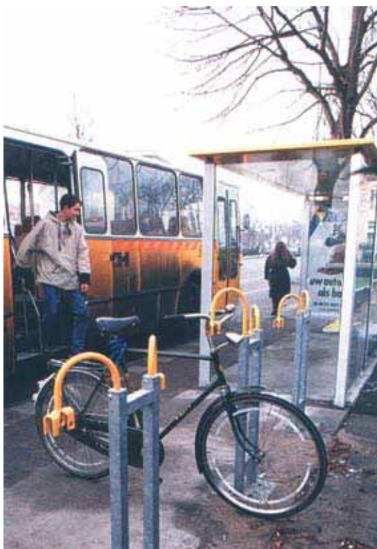
FIGURA 195 - Exemplo de paraciclo com dispositivo para engate junto à parada de ônibus adotado na Europa, 2001.
