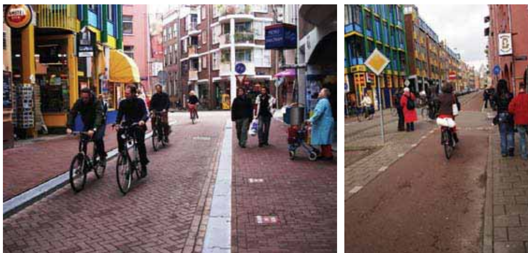
FIGURA 105 - Exemplos de ciclovias em áreas adensadas, com coloração diferenciada e rebaixo do pavimento, Amsterdam – Holanda, 2006.
