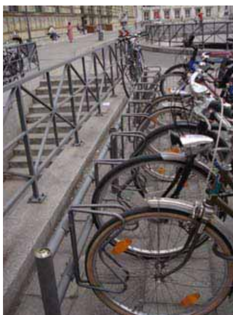
FIGURA 183 - Suporte de fixação em uma das rodas.
