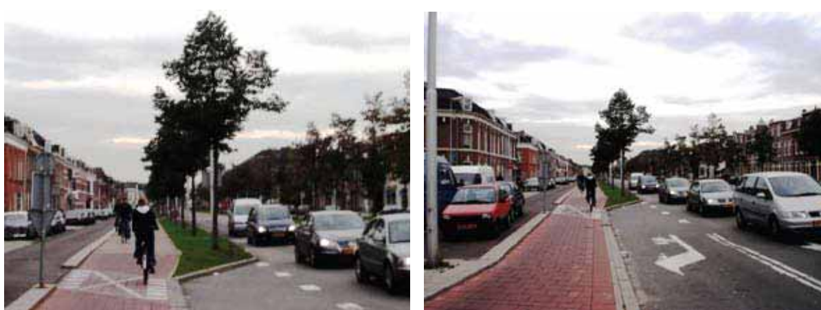
FIGURA 106 - Exemplos de terrapleno separador de ciclovia de via com grande movimentação de veículos motorizados, Utrecht – Holanda, 2006.
