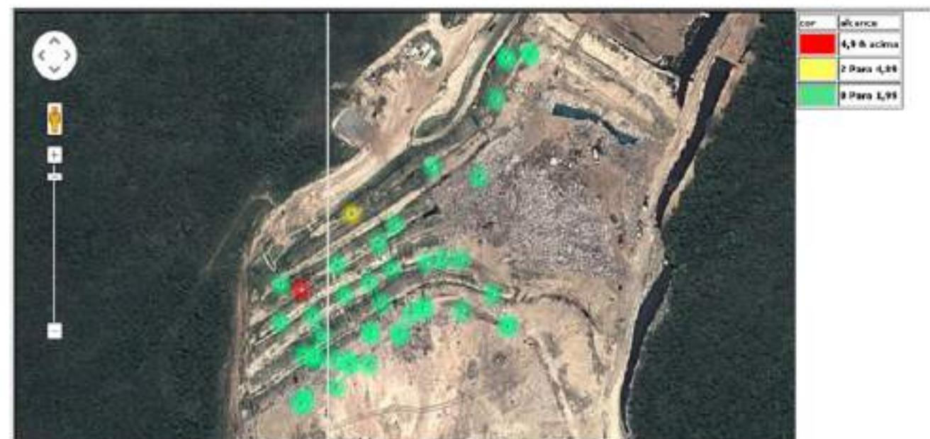
Figura 2 - Spot Map para O<sub>2</sub> evidencia quais poços devem ser evitados para não causar contaminação de O<sub>2</sub> no sistema.
