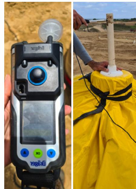
1. Equipamento de medição do biogás. 2. Dreno de gás sendo controlado a vazão e a concentração dos gases efluentes
