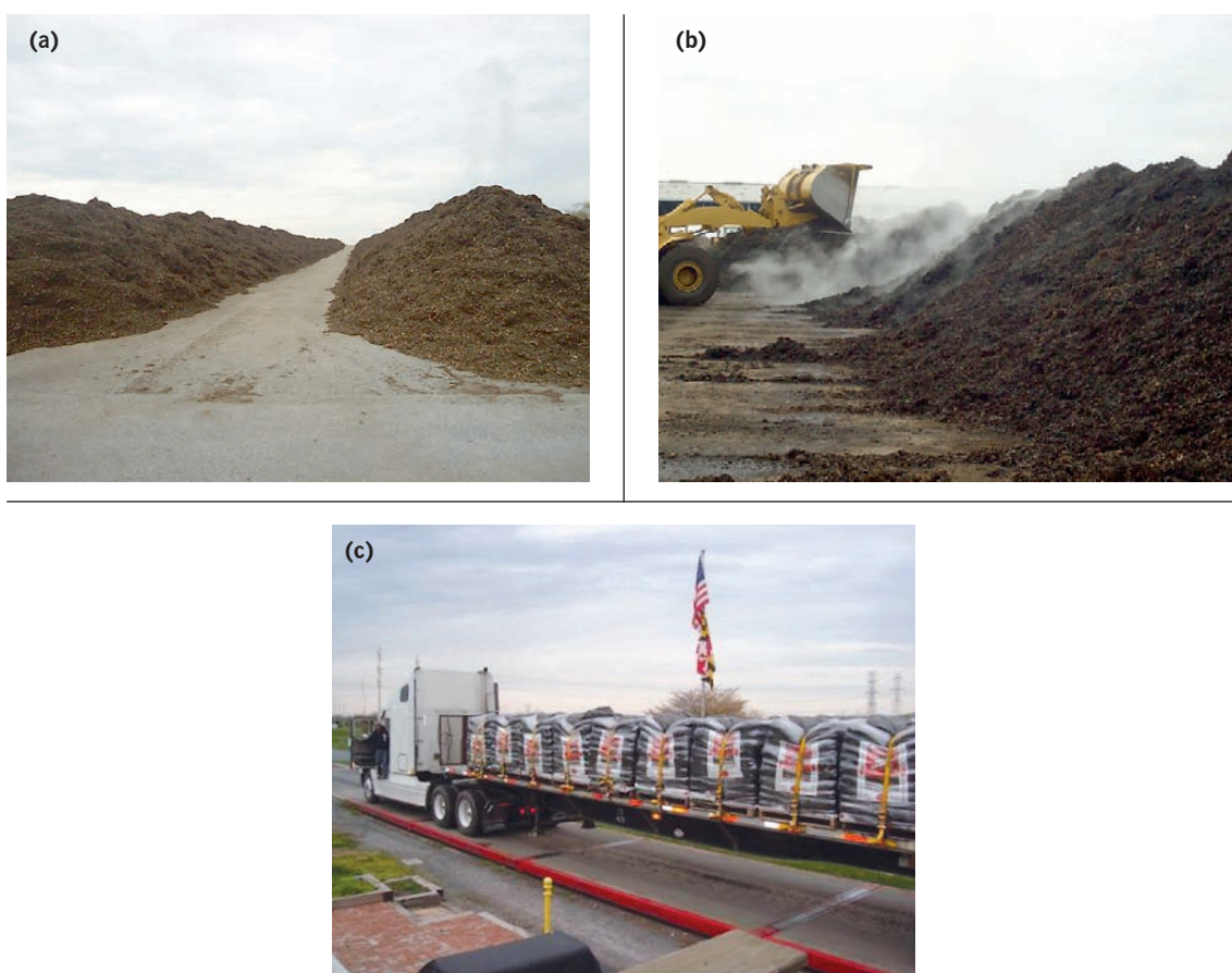
Figura 13 - Unidade de Compostagem do Condado de Montgomery, Maryland (a) Leiras de compostagem, (b) reviramento mecanizado e (c) comercialização do composto (GRS/UFPE, 2012).
