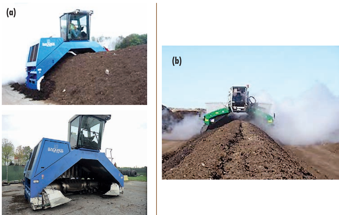
Figura 14 - Método natural de aeração que utiliza reviramento mecânico das leiras. (a) Unidade de compostagem de Montgomery e (b) detalhamento do equipamento utilizado (GRS/UFPE, 2012).
