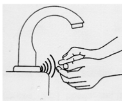
Figura 18- Torneira acionada por infravermelho.
