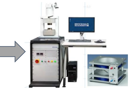
Caracterização Magnética (Bobina de Helmholtz e Histeresígrafo)
