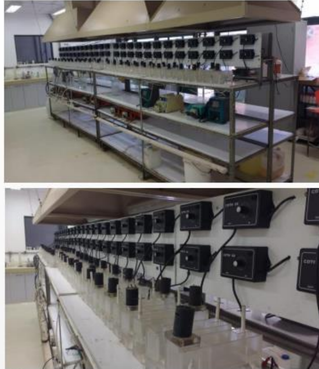
7º Sistema de extração por solventes contínuo com bateria de misturadores-decantadores micropalito da Sonal-Polux, bateria de misturadores-decantadores em policarbonato (50 estágios), bombas peristálticas e sistema automático de controle de pH
