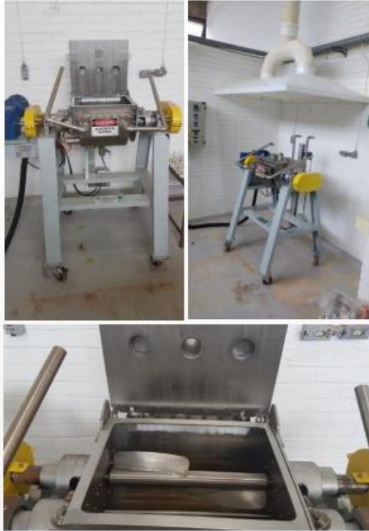
6º Digestor de cura ácida em batelada com agitação e controle de temperatura via óleo térmico
