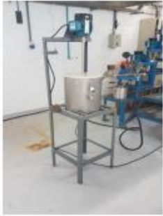
1º Reator de lixiviação em batelada com agitação e controle de temperatura via circulação de vapor
