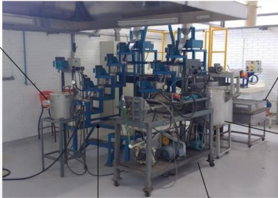
1º Reator de lixiviação em batelada com agitação e controle de temperatura via circulação de vapor
