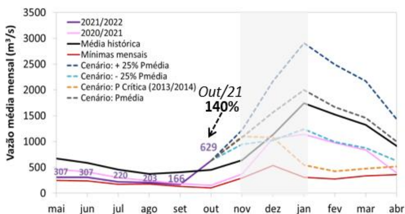
Figura 5 – Histórico e projeções (novembro de 2021 a janeiro de 2022) de vazão natural média mensal ( \text{m}^3/\text{s} ) ao reservatório da UHE Furnas.
