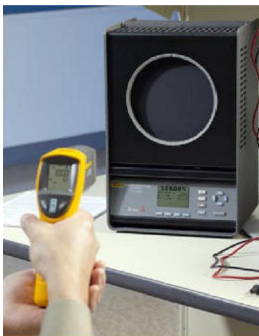
Figura 8.3. Calibrador de placa plana sendo focalizado por um termômetro de IV
