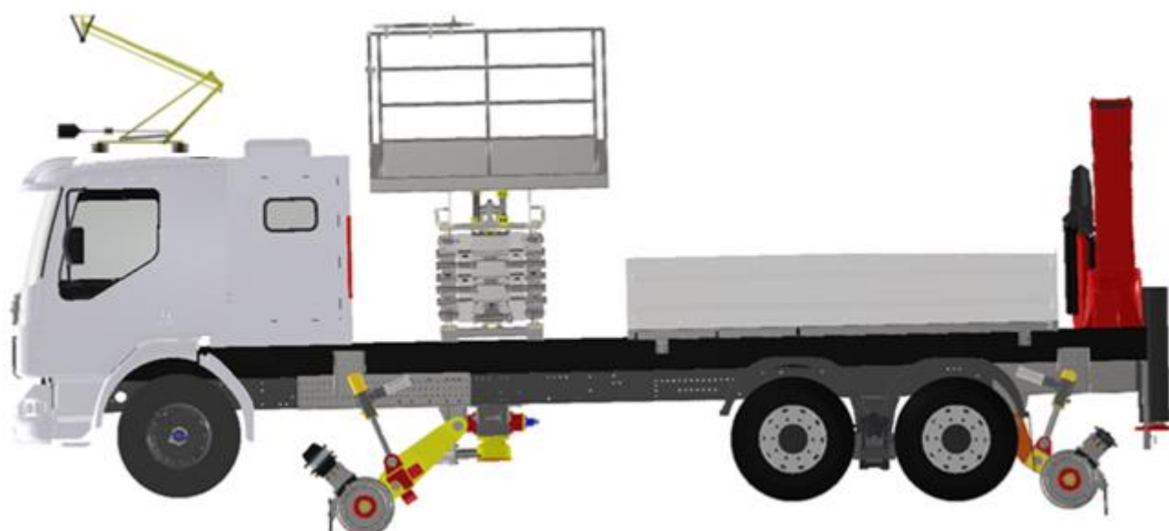
Imagem ilustrativa – Caminhão rodoferroviário para manutenção em rede aérea
