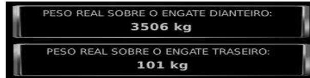
Figura 9 - Indicadores do Peso Real Medido Sobre os Engates
