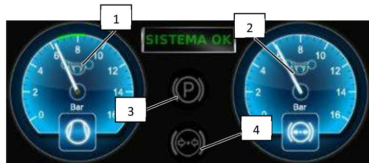
Figura 3 - Manômetros e Indicadores de Freio
