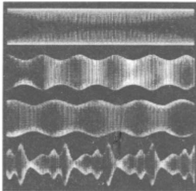
Instabilidade modulacional em uma linha elétrica não-linear
