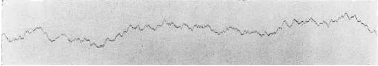
Registrieraufnahme der Brownschen Bewegung (natürlich Größe) Direktionskraft 9,428 \times 10^{-9} abs. Einh. Trägheitsmoment: 1 \times 10^{-3} abs. Einh. Abstand Spiegel-Kamera: 72,1 cm. Zeitmarke: 30 sec dx = 1 mm. a) Atmosphärendruck. Temperatur 13^\circ\text{C}
