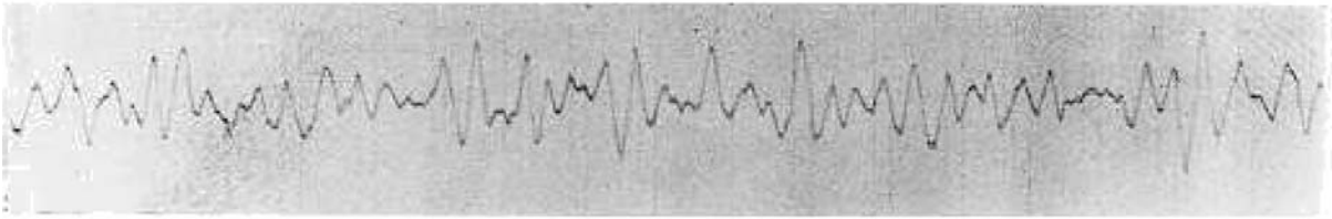
Registrieraufnahme der Brownschen Bewegung (natürlich Größe) Direktionskraft 9,428 \times 10^{-9} abs. Einh. Trägheitsmoment: 1 \times 10^{-7} abs. Einh. Abstand Spiegel-Kamera: 72,1 cm. Zeitmarke: 30 sec dx = 1 mm. b) 1 \times 10^{-3} mm Hg. Temperatur 13^\circ\text{C}
