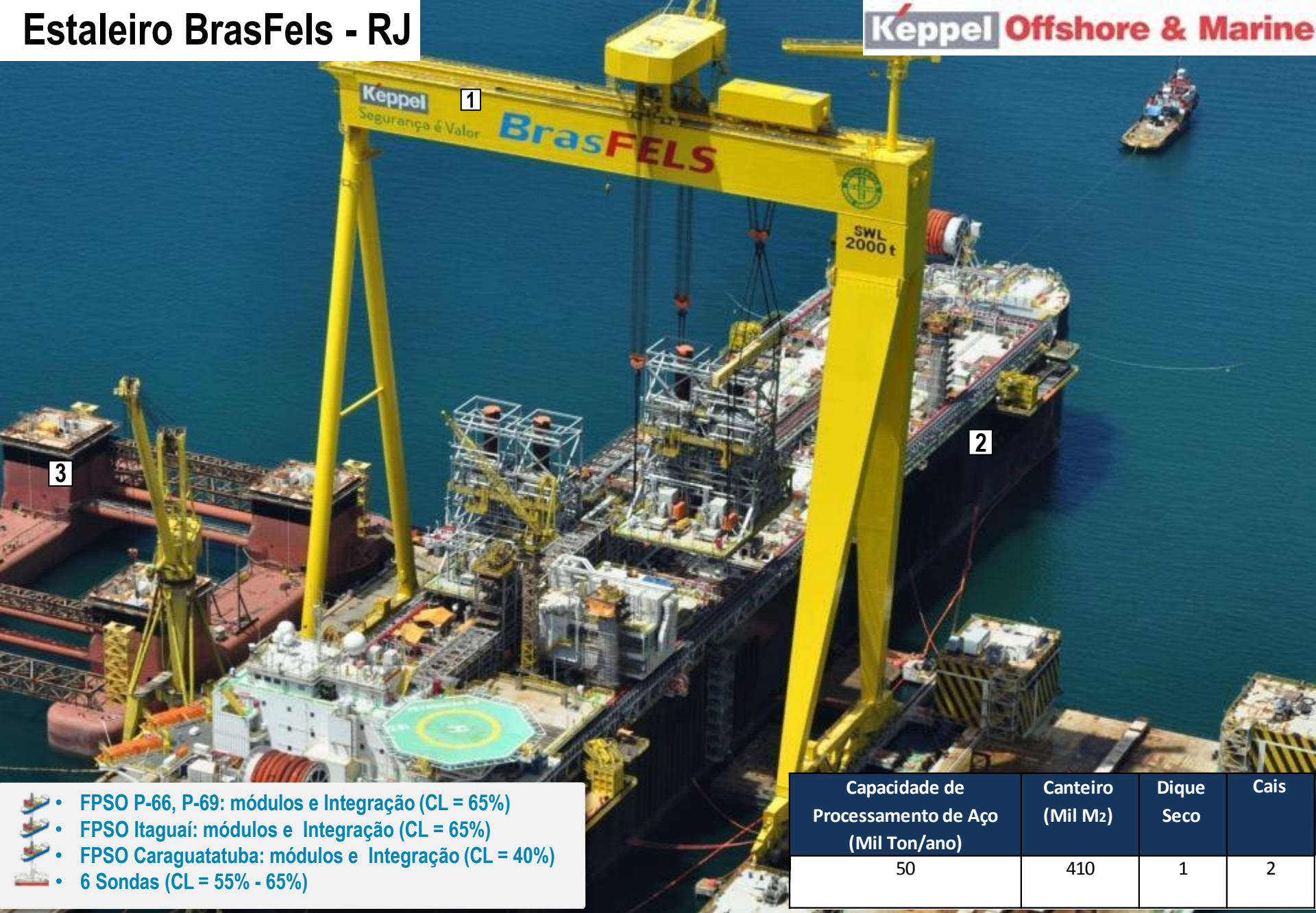
Vista Geral do Estaleiro BrasFels, em Angra dos Reis – RJ (Jan/15). (1) Novo pórtico de 2.000 toneladas; (2) Integração da P-66; (3) Construção Sonda Frade
