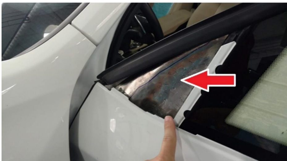
Figura 6 – Chapa de aço inox aplicada na região do retrovisor externo
