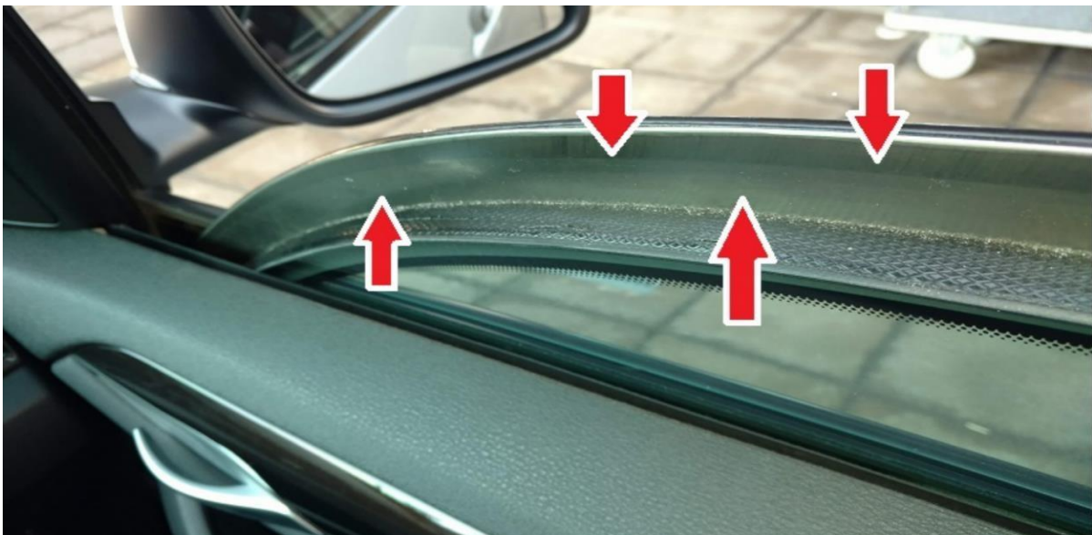
Figura 2 - Detalhe do reforço em aço na região do offset do vidro da porta dianteira
