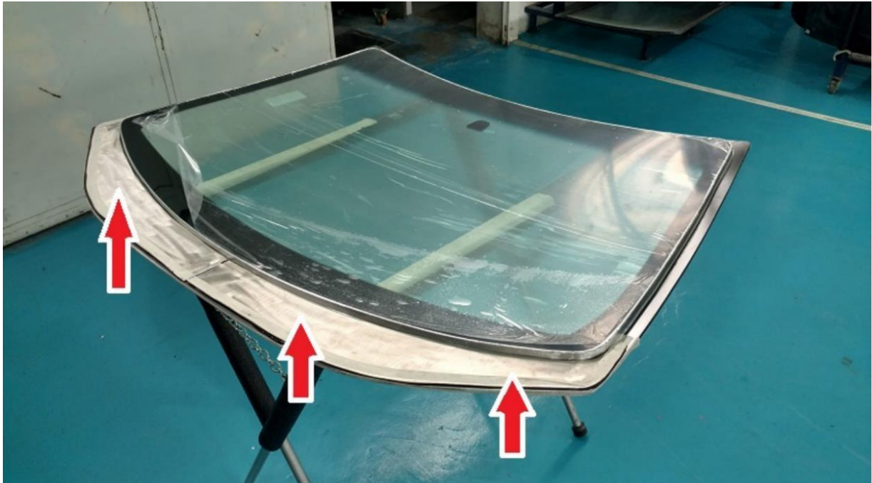
Figura 1 - Reforço em aço inox na região do offset (sorriso) do para-brisa
