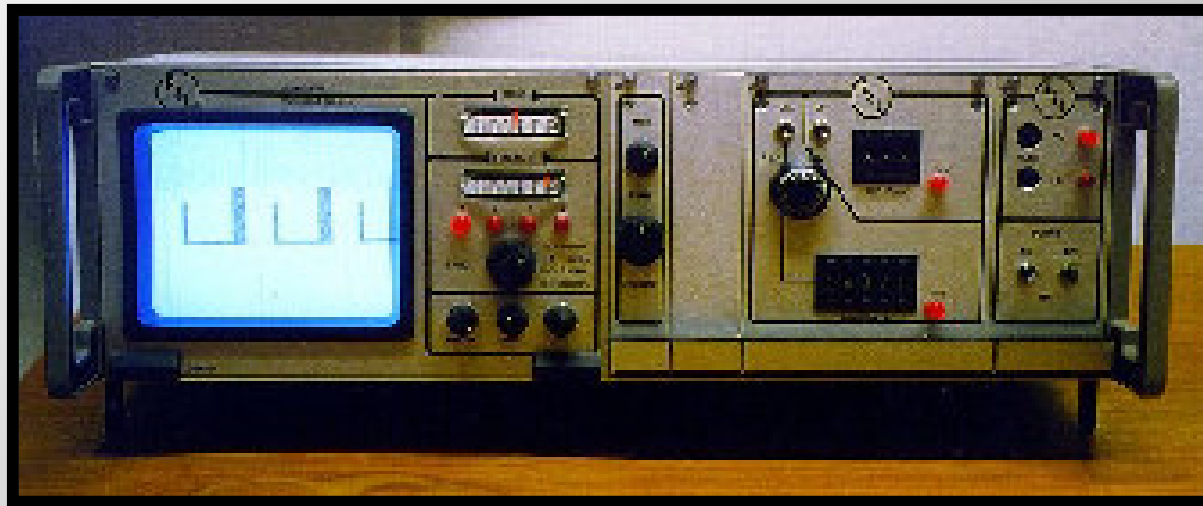
Monitor de emissões TEMPEST DataSafe/ESL 400 ( década de 80 )
