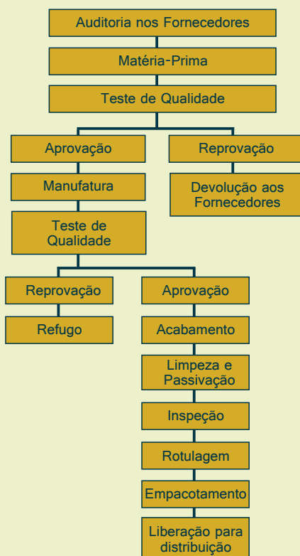
Figura 17 - Fluxograma exemplificando erro comum no envio das etapas de fabricação do produto.
