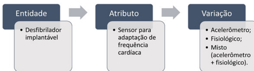
Figura 2 - Exemplo esquemático da definição de atributo técnico e sua variação para desfibriladores implantáveis.
