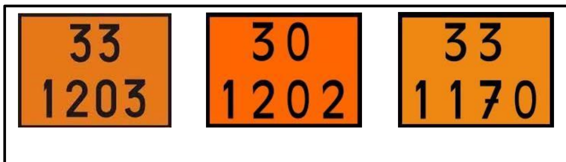
Figura 20 – Painéis de segurança de Gasolina / Diesel / Etanol. Fonte: VCR-ESS-INS 150 – 01/2025.
