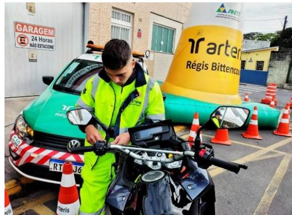
Figura 30 - Equipe da Arteris instalando antena corta pipa, na concessionária Honda em Registro/SP, em 31 de julho de 2022.
