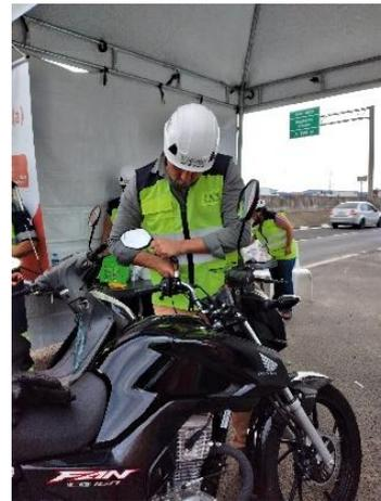
Figura 32 – Equipe da Arteris realizando instalação de antena corte pipa na 5ª DEL - PRF de Registro/SP, em 27 de julho de 2022.
