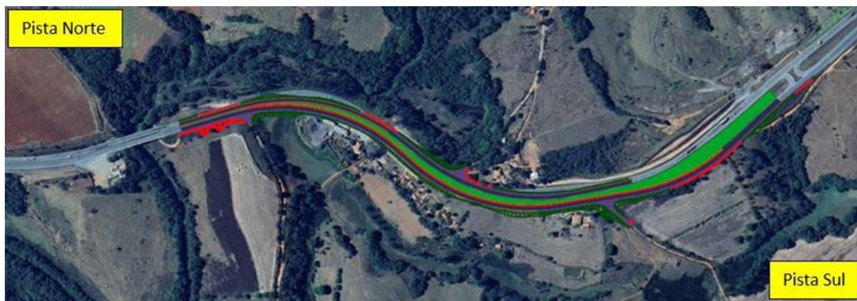
Figura Apêndice B 10: Layout de melhoria de traçado no km 707
