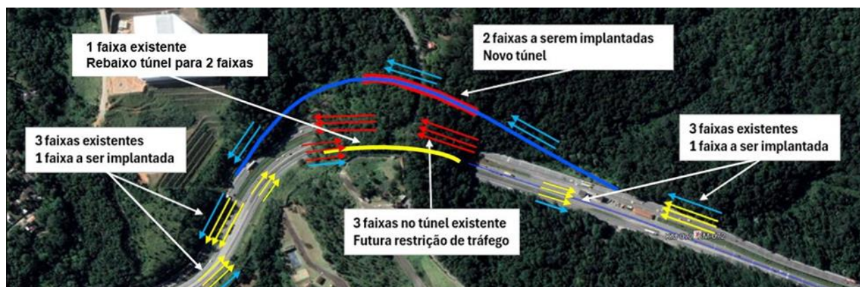
Figura Apêndice B 6: Novo túnel pista norte (superior) rebaixamento do túnel existente pista sul (inferior)
