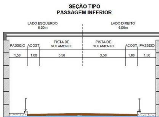
Figura Apêndice B 16: Seção transversal da trincheira
