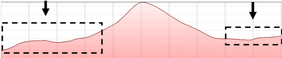
Figura Apêndice B 8: Perfil longitudinal pelo eixo no novo túnel (indicação da áreas de emboque e desemboque)
