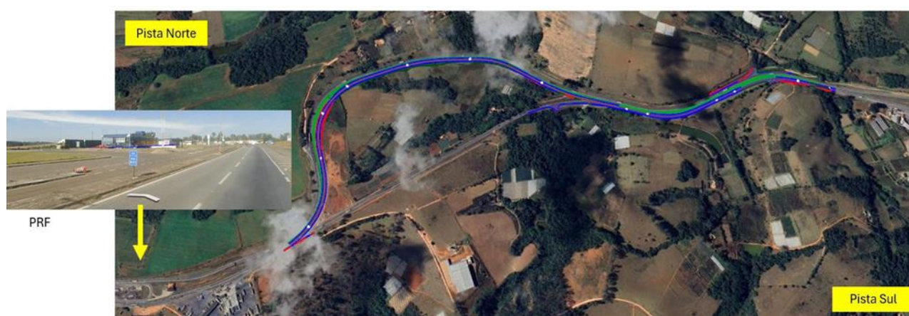
Figura Apêndice B 11: Layout de melhoria de traçado no km 873
