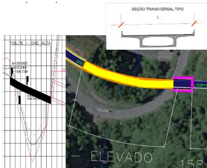
Figura 38 - OAE em balanço sucessivo - km 359,20 ao km 359,36
