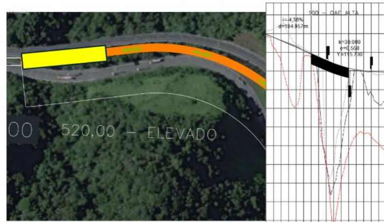
Figura 39 - OAE em balanço sucessivo - km 358,44 ao km 358,54
