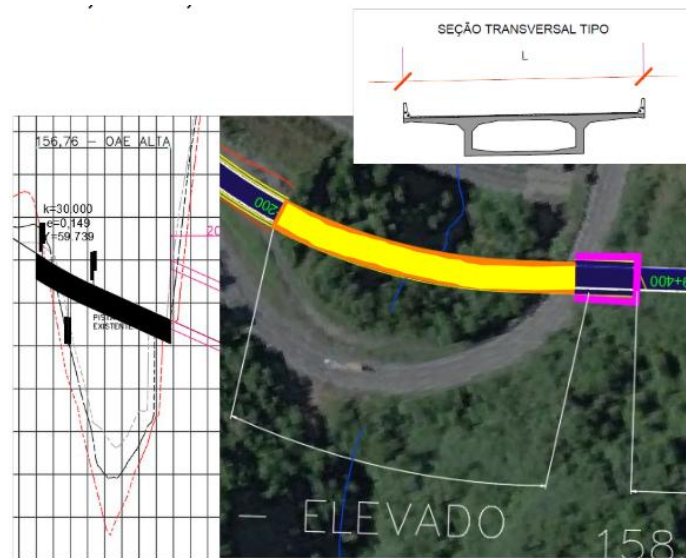
Figura 40 - OAE em balanço sucessivo - km 359,20 ao km 359,36
