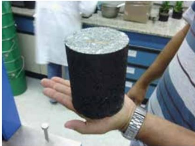
(a) CP do compactador giratório já com as faces serradas
