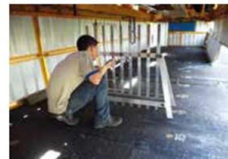
(i) Detalhe de ensaio em pista testada pelo simulador brasileiro móvel tipo HVS – determinação de afundamento em trilha de roda treliça adaptada (foto: Camargo, 2016)
