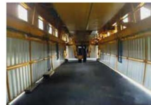
(h) vista da parte interna do simulador de tráfego móvel, protegido lateralmente para melhor controle de temperatura
