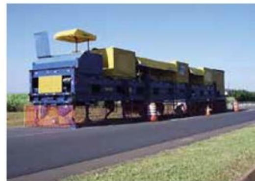
(g) Simulador brasileiro móvel tipo HVS (foto: Arteris)
