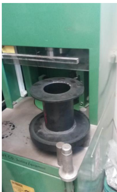
(e) Compactador giratório do tipo SUPERPAVE empregado neste estudo
