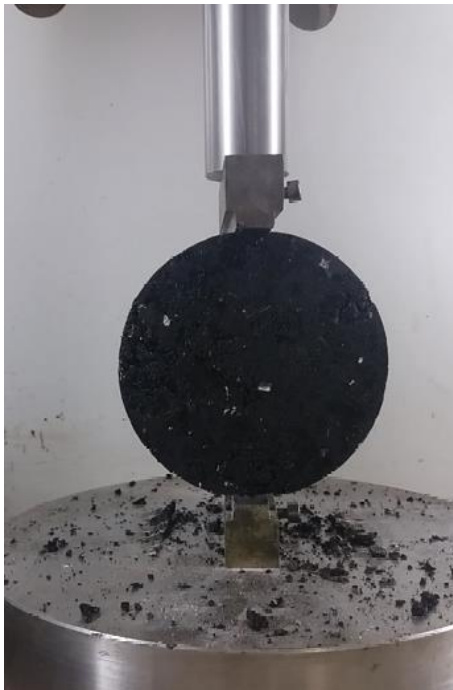
(c) cetalhe do CP durante o ensaio de fadiga.
