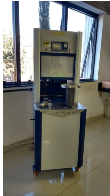
(f) Compactador giratório Superpave.
