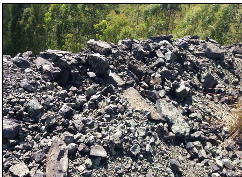
Figura 3.3 - Detalhe evidenciando as diferentes granulometrias da escória estocada.
