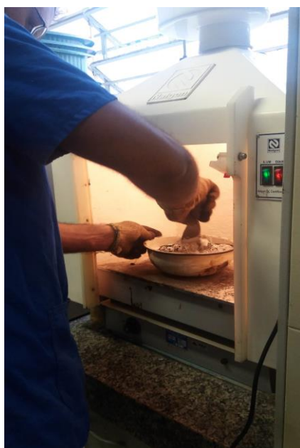
(c) Preparação da mistura à quente do Ligante-Agregado.
