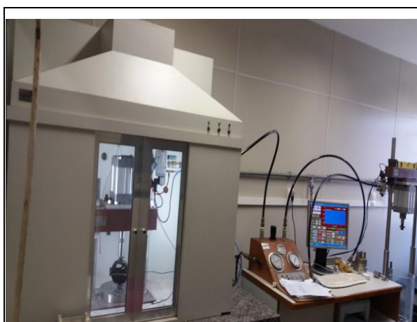
(a) Equipamento CD do Laboratório de Pavimentação da Faculdade de Engenharia/UFJF, utilizado para o ensaio de MR.
