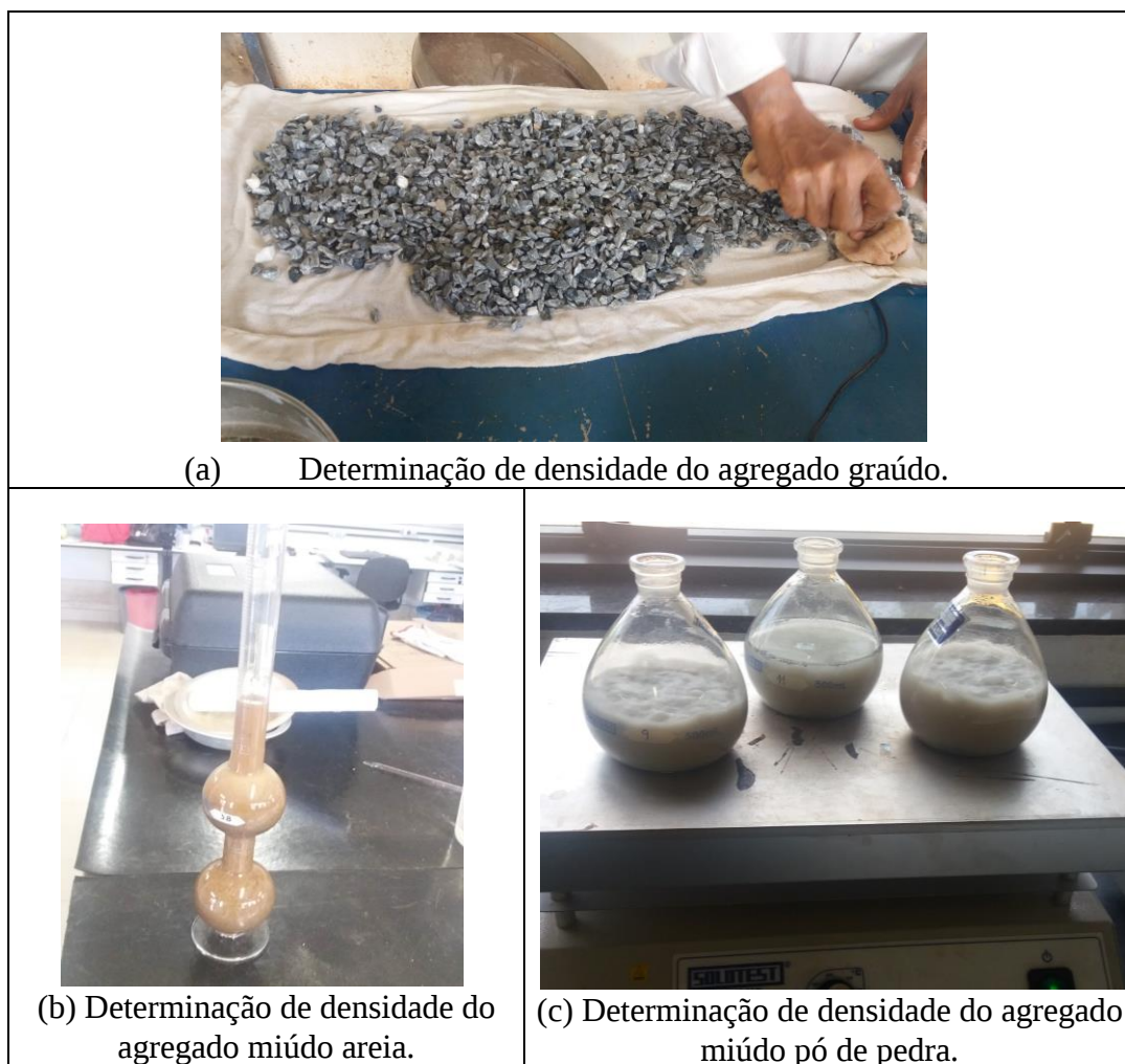
Figura 3.7- Determinação da massa específica real dos agregados graúdos e miúdos.
