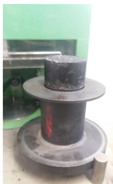
(f) Corpo de prova moldado no CGS.
