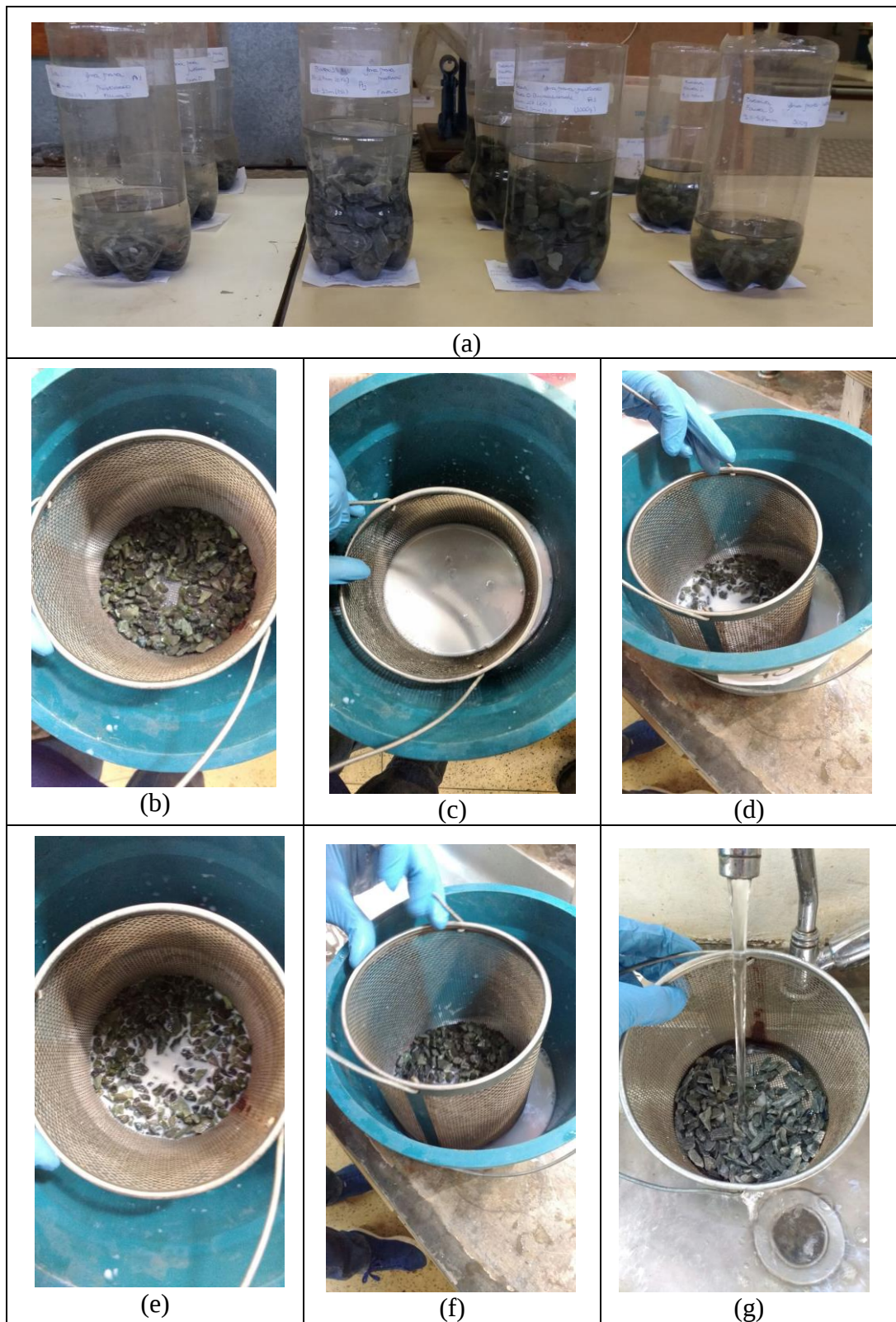
Figura 3.6 - Etapas do ensaio de durabilidade do agregado convencional e escória.
