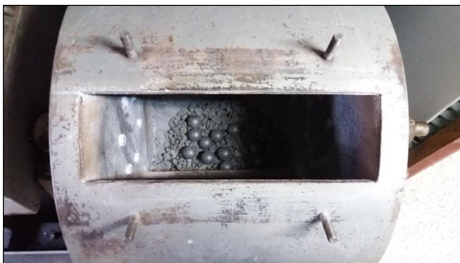
Figura 3.5 - Equipamento e cargas abrasivas usados no Ensaio de abrasão Los Angeles .
