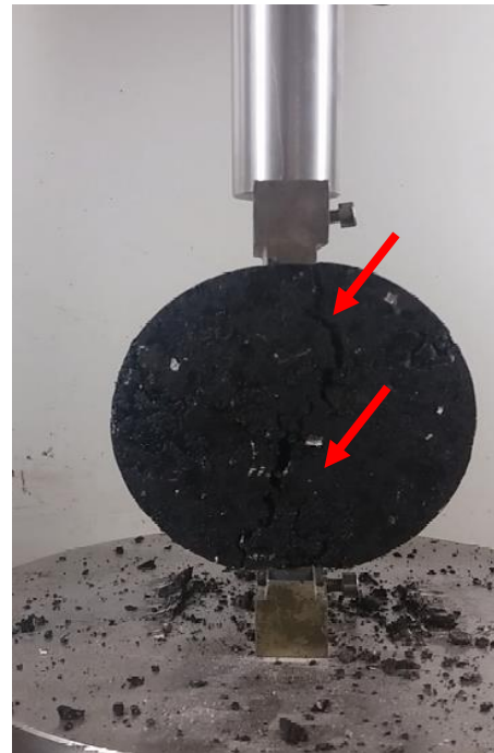
(d) Detalhe do CP quase no final do ensaio de fadiga.
