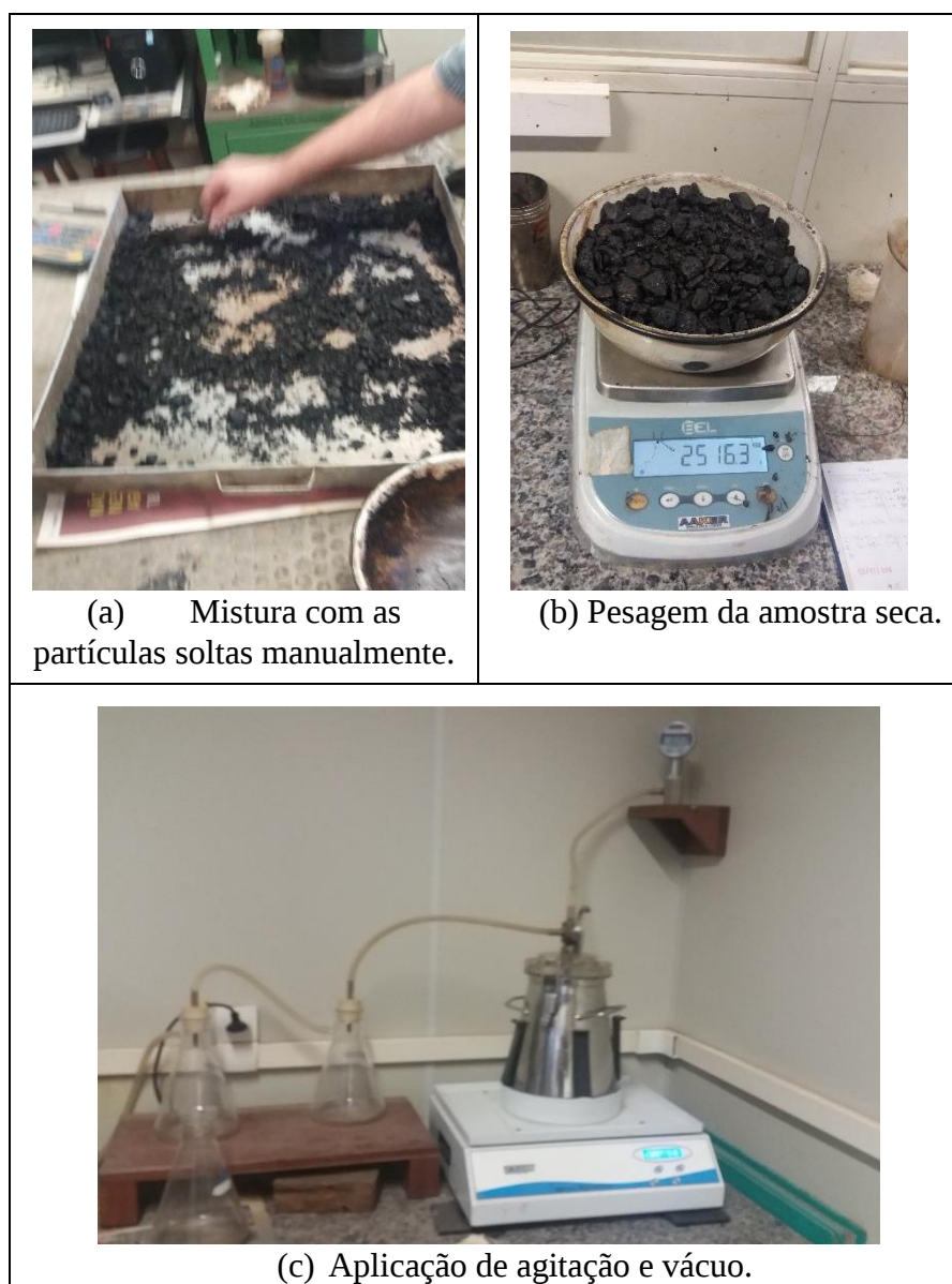
Figura 3.16 – Determinação do Gmm, etapas do ensaio RICE.
