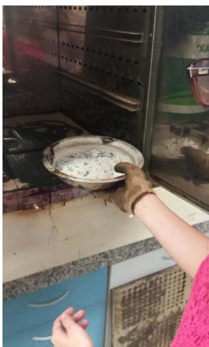
(a) Aquecimento dos Agregados.
