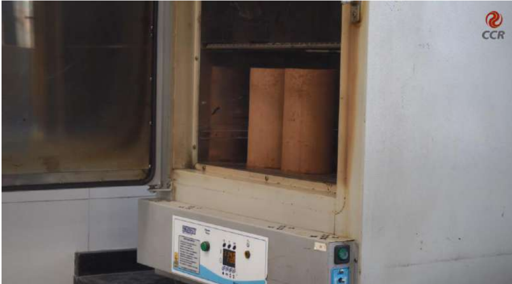
Figura 3 – Realizar a secagem dos corpos de provas na estufa e posteriormente pesa-os.
