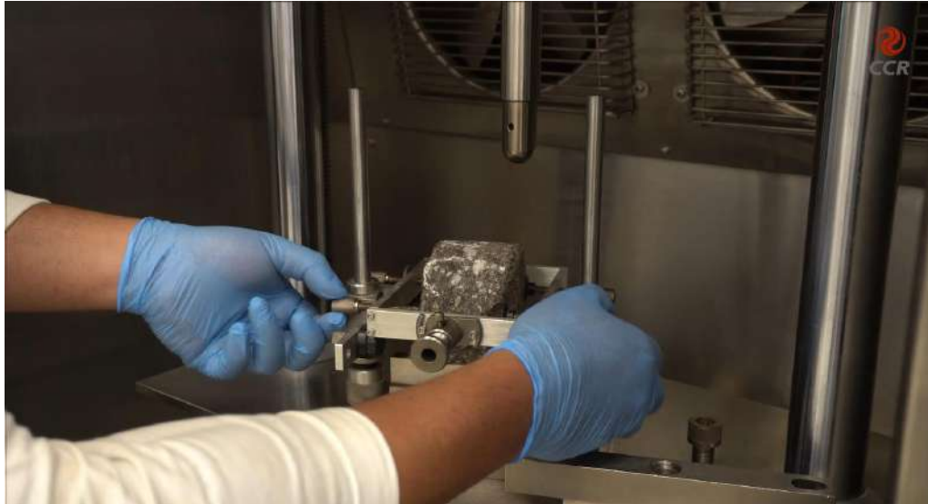
Figura 3 – Moldar o corpo de prova e colocá-lo na prensa UTM-25 para a realização do ensaio.
