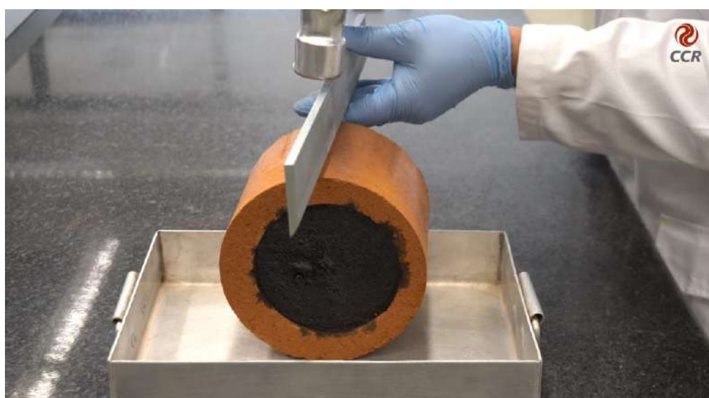
Figura 4 – Com auxílio da régua biselada e martelo partir o corpo de prova.
