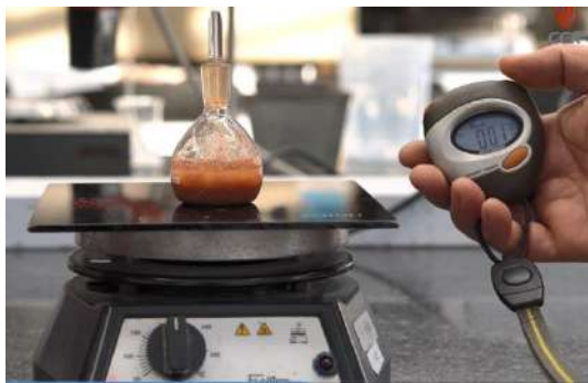
❖ Ferver água do picnômetro + solo;
