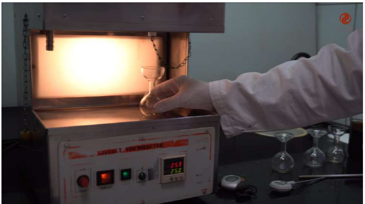
Figura 2 – Coloca-se os frascos de vidro na comporta do equipamento Saybolt Furol.
