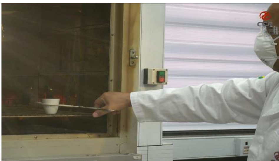
Figura 2 – Coloca-se a amostra na estufa a 105 °C.
