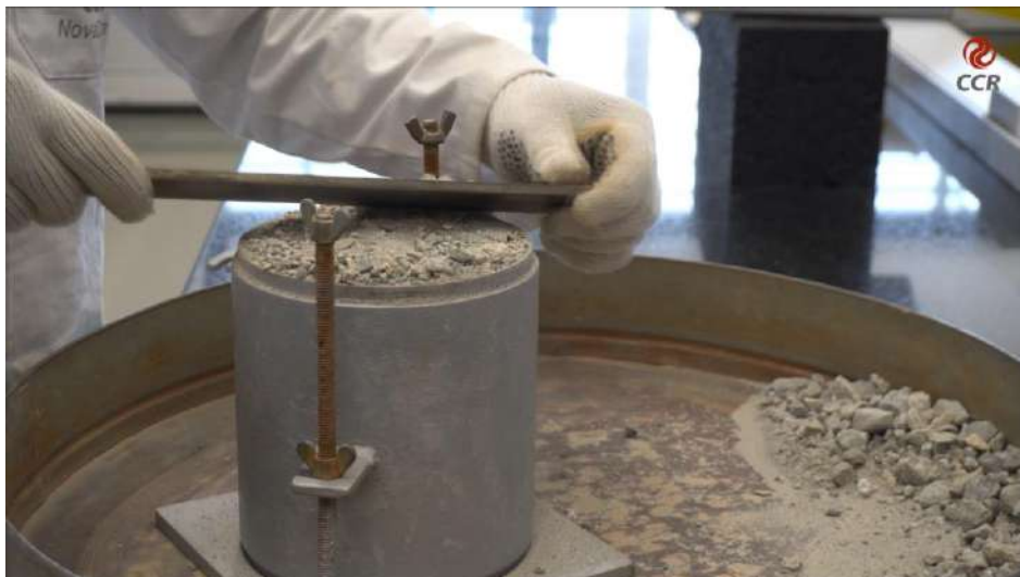
Figura 5 – Rasar o excesso do material com a régua de aço biselada.
