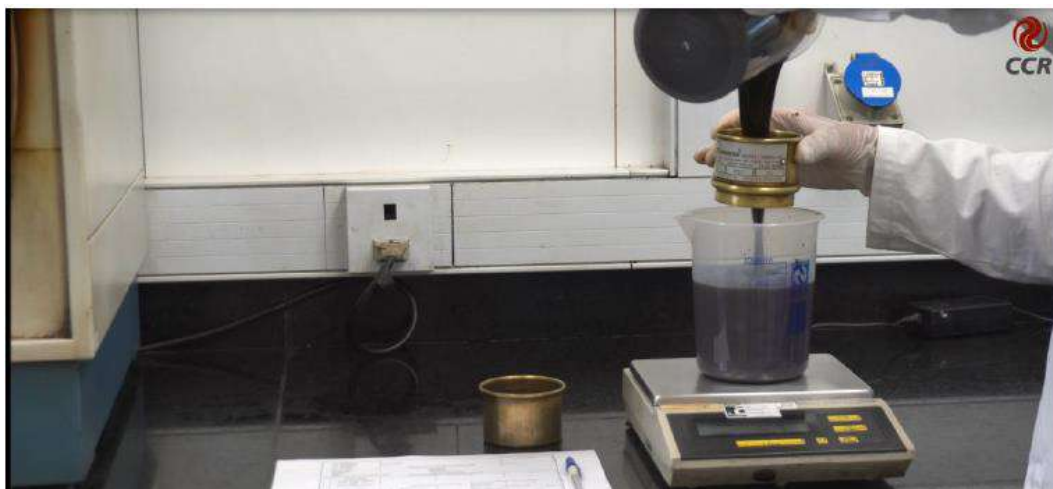
Figura 1 – Peneiramento da amostra de emulsão passando na malha ASTM nº 20.
