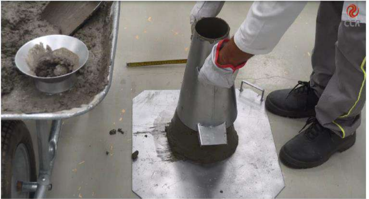
Figura 3 – Retirar o molde metálico.
