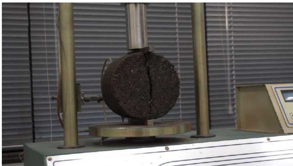
Figura 13 – Realizar a ruptura dos corpos de prova com e sem imersão, a 25 °C.
