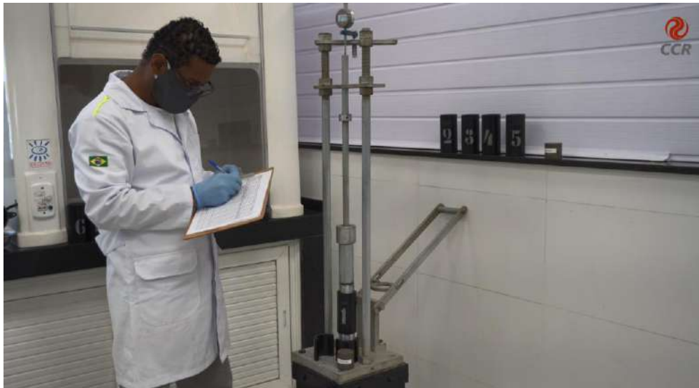
Figura 3 – Compactação do corpo de prova na energia indicada na norma.
