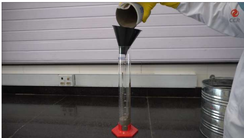
Figura 4 – Colocar a calda de cimento na proveta.
