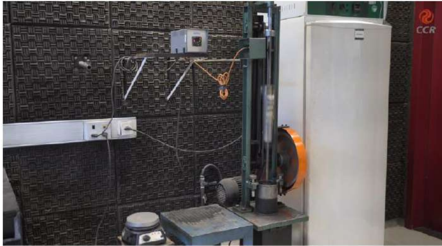
Figura 4 – Realizar a compactação com o equipamento Marshall com 75 golpes por face.
