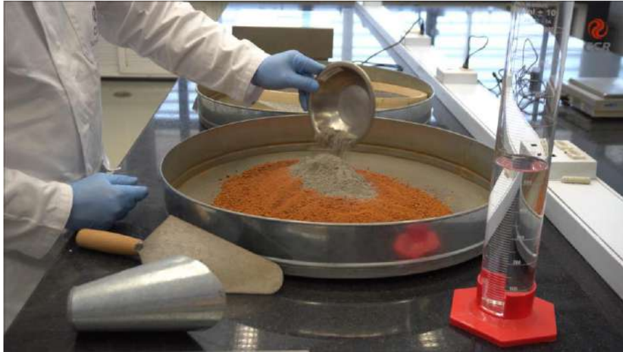
Figura 1 – Adicionar cimento ao solo.
