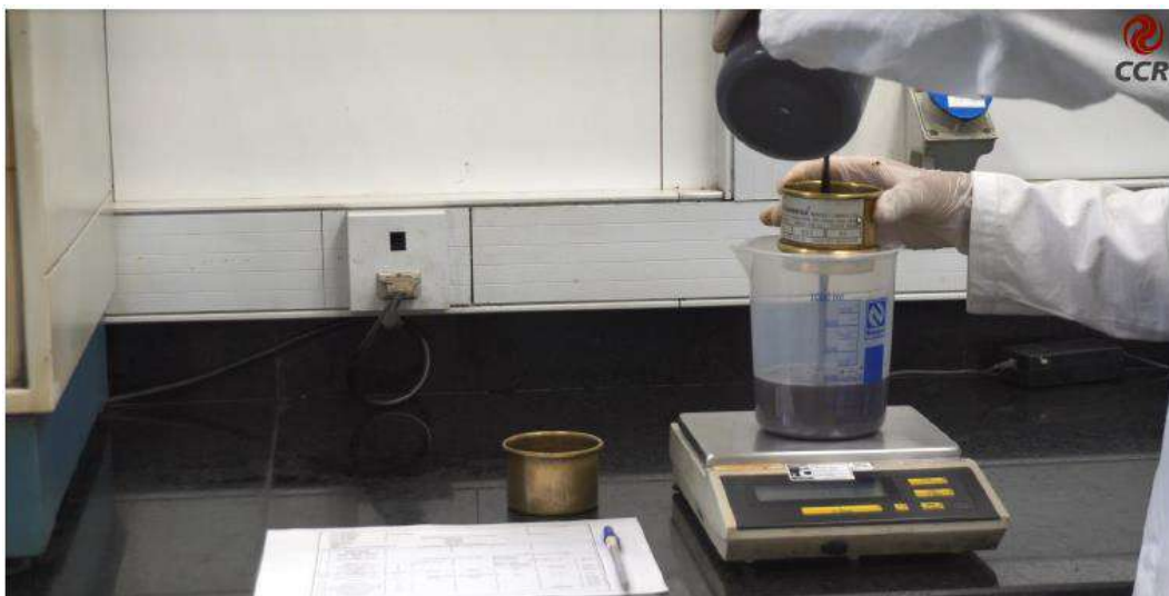
Figura 1 – Peneiramento da amostra de emulsão asfáltica para determinação do resíduo.
