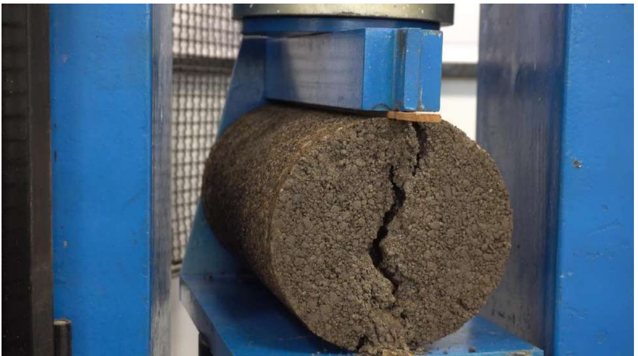
Figura 4 – Ruptura por compressão diametral do corpo de prova cilíndrico.
