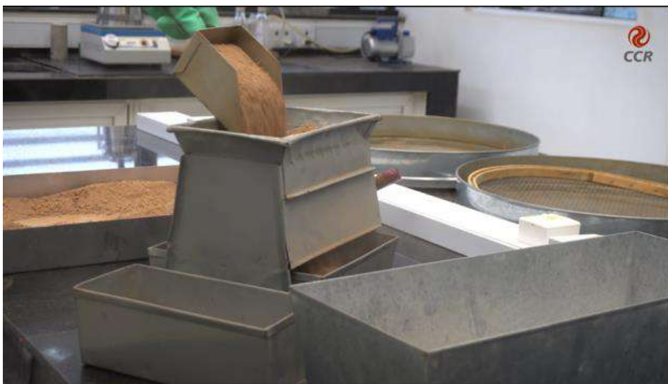
Figura 3 – Realizar o quartearamento do solo.
