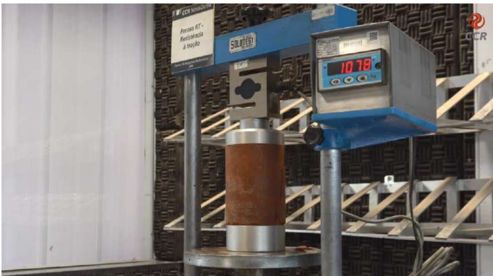
Figura 5 – Aplicar a carga gradualmente até o momento da ruptura do corpo de prova.
