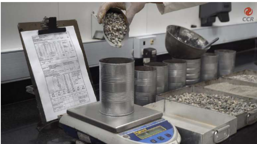
Figura 2 – Pesar a composição granulométrica para cada corpo de prova
