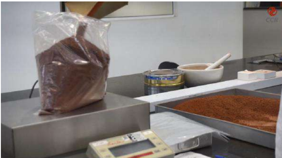
Figura 2 – Pesar 6 kg da amostra de solo previamente peneirada e homogeneizada.
