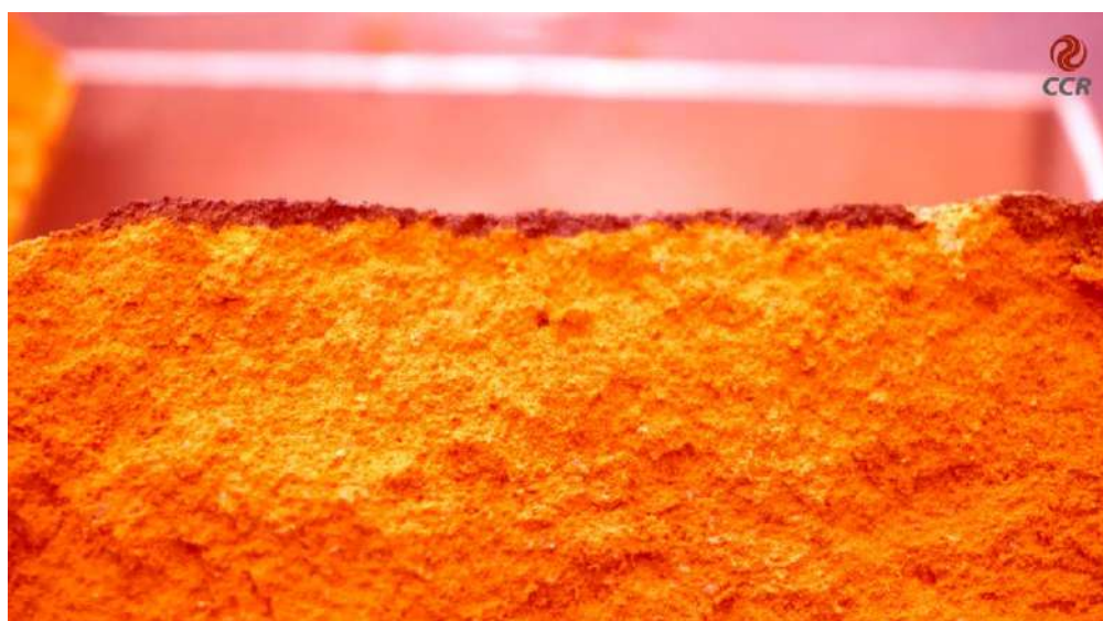
Figura 5 – A taxa é considerada adequada se existir a penetração da emulsão no solo.
