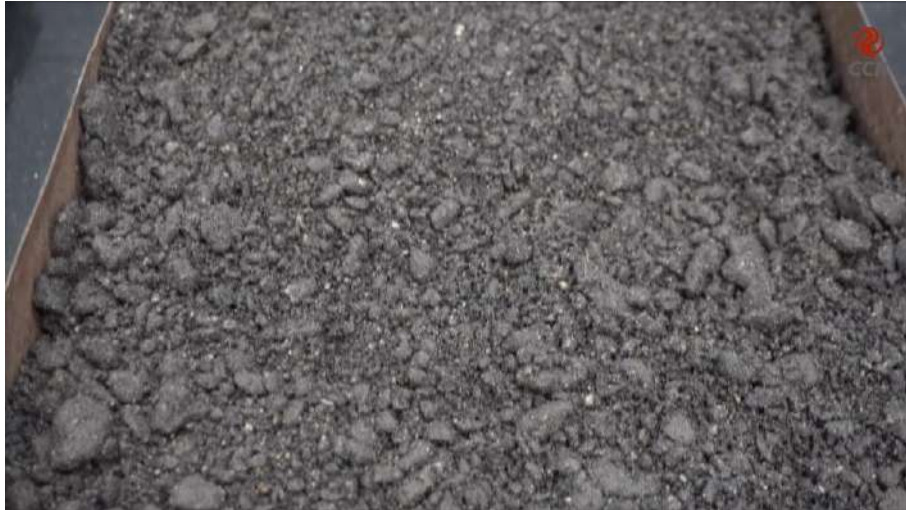
Figura 1 – Previamente deve-se preparar a mistura com fresado seguindo o procedimento especificado na norma, na quantidade mínima para moldagem de 6 corpos de prova.
