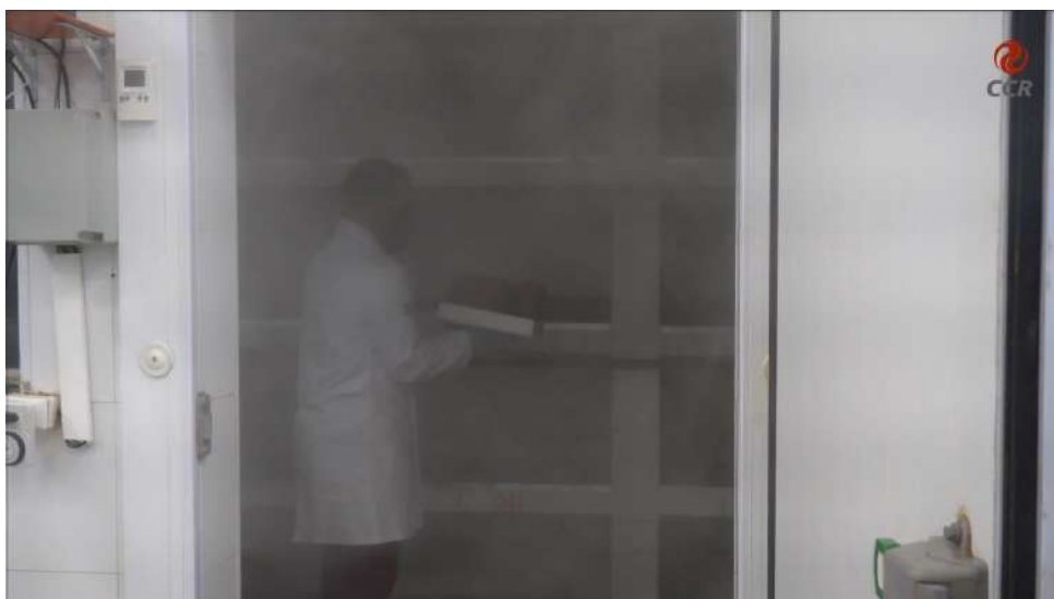
Figura 6 – Manter o corpo de prova na câmara úmida no período especificado.
