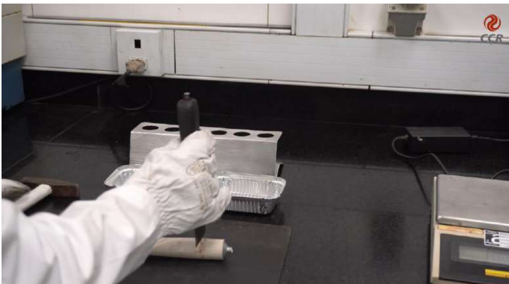
Figura 4 – Com auxílio da espátula cortar a parte superior do recipiente tubular.
