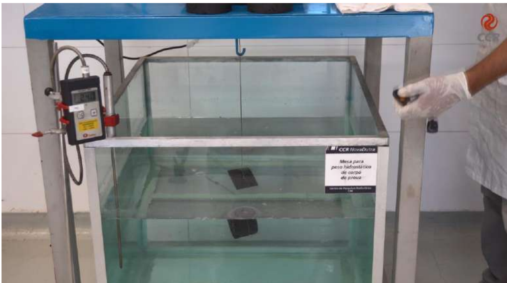
Figura 4 – Pesagem hidrostática dos corpos de prova para a obtenção dos vazios.
