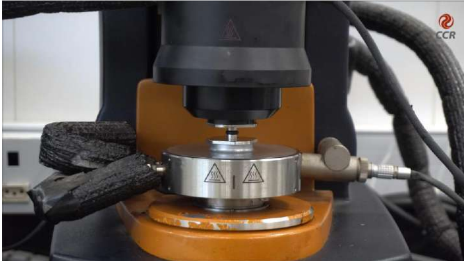
Figura 4 – Realização do ensaio com a amostra de 8 mm na varredura baixa.
