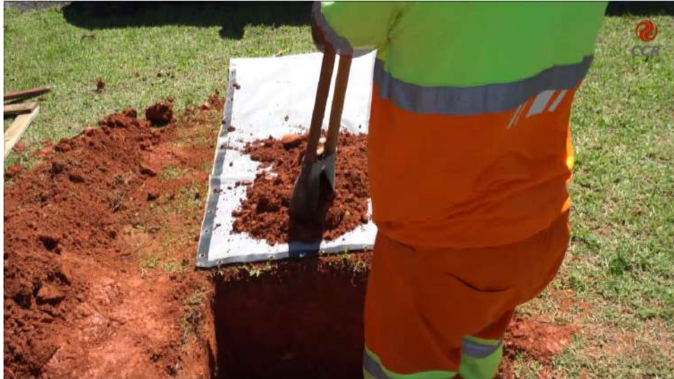
Figura 4 – Retirar a amostra de solo e depositá-la na lona.
