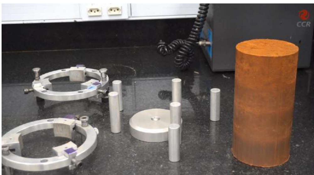
Figura 2 – Acessórios necessários para fixação dos LVDTs
