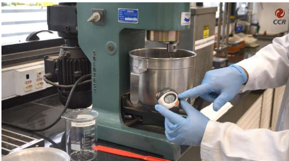
Figura 3 – Misturar os agregados e cimento no misturador mecânico.
