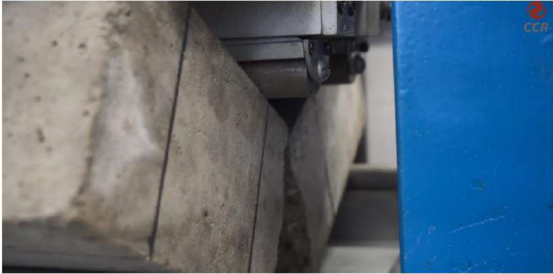
Figura 3 – Ruptura final dos corpos de prova prismáticos.
