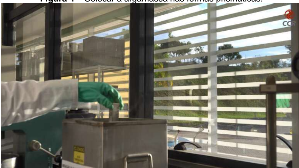
Figura 5 – Colocar as vigas prismáticas dentro da solução e posteriormente realizar as medições.
