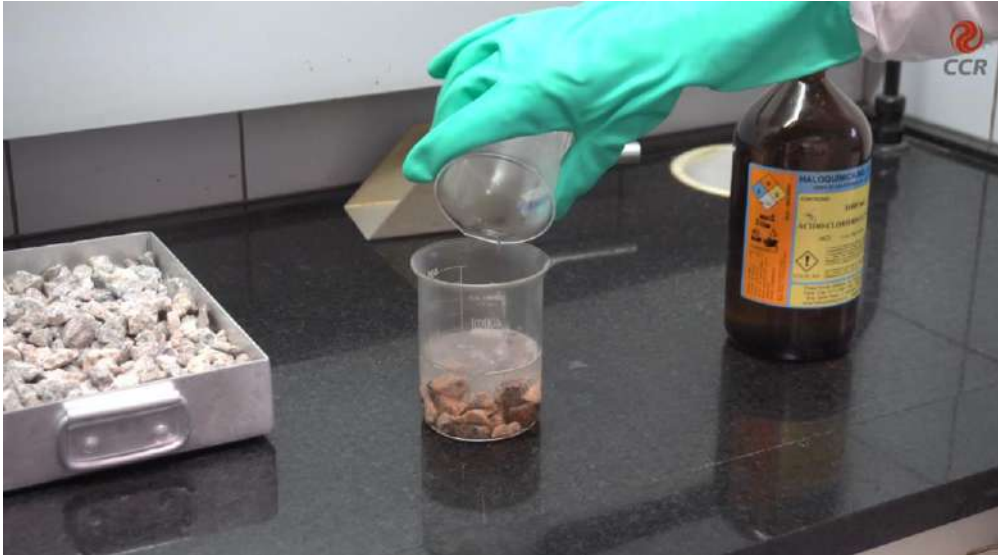
Figura 3 – Colocar o ácido clorídrico de forma que cubra totalmente a porção de agregados
