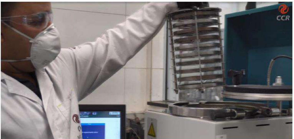
Figura 2 – Colocação das amostras de ligante no equipamento de vaso de envelhecimento sob pressão para serem ensaiadas.
