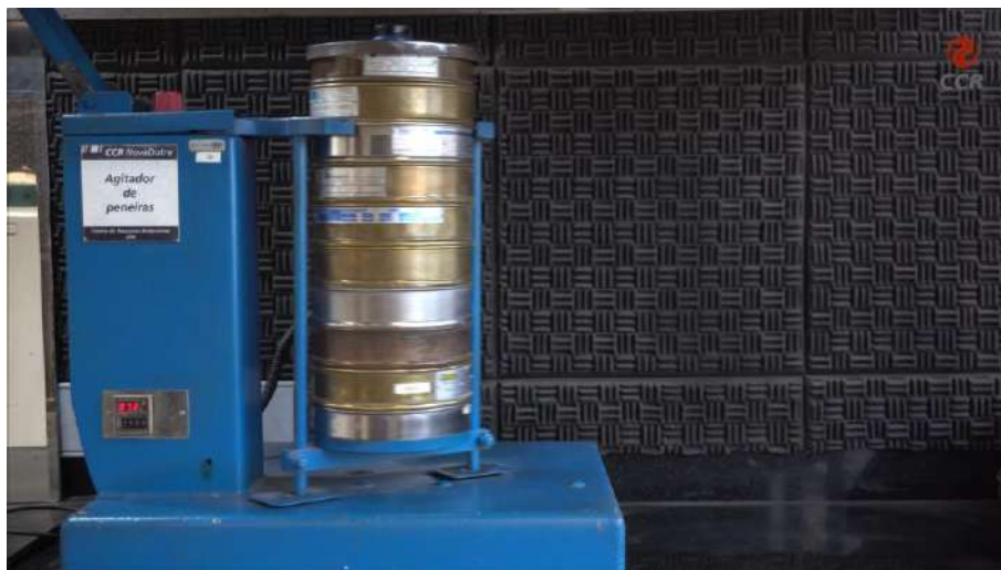
Figura 8 – Executar o peneiramento da amostra de solo com auxílio do agitador de peneiras.
