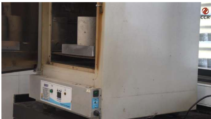
Secagem dos corpos de prova na temperatura de 110^\circ\text{C} .
