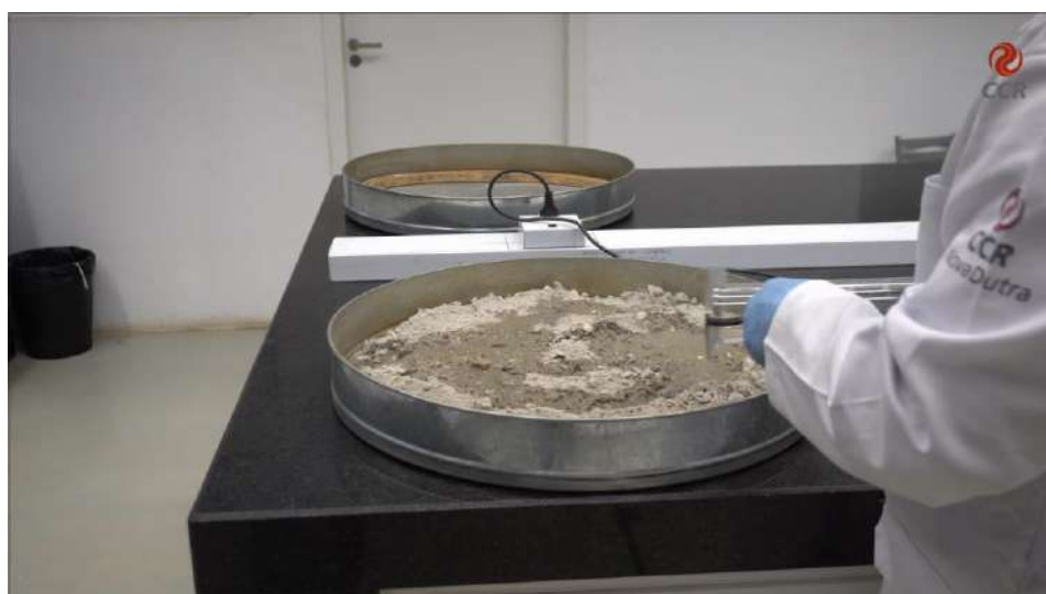
Figura 3 – Adicionar a quantidade de água especificada na mistura.
