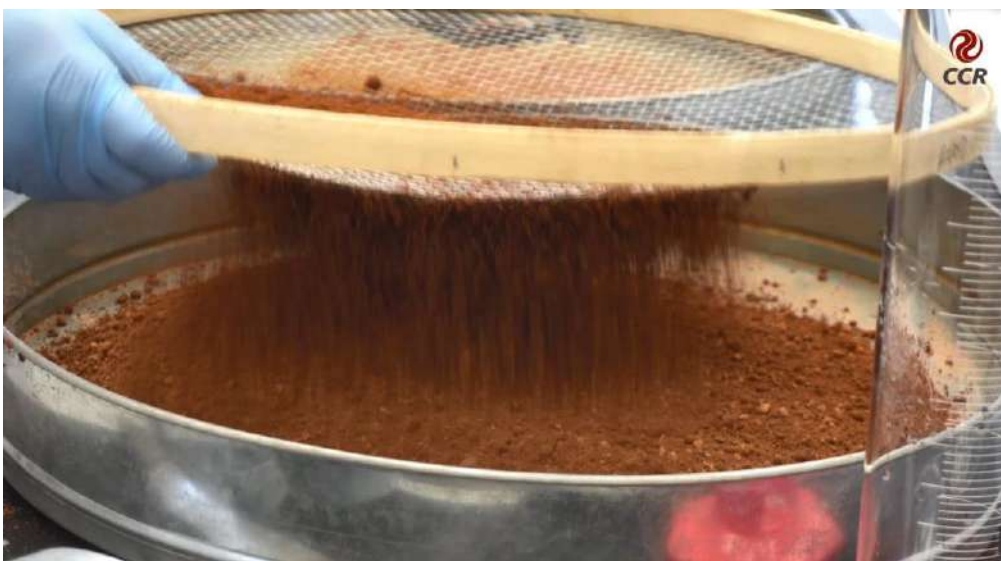
Figura 2 – Homogeneizar e peneirar o solo cimento.
