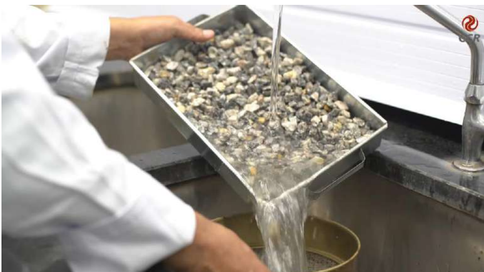
Figura 2 – Lavar os agregados até a água ficar cristalina e posteriormente secar na estufa.
