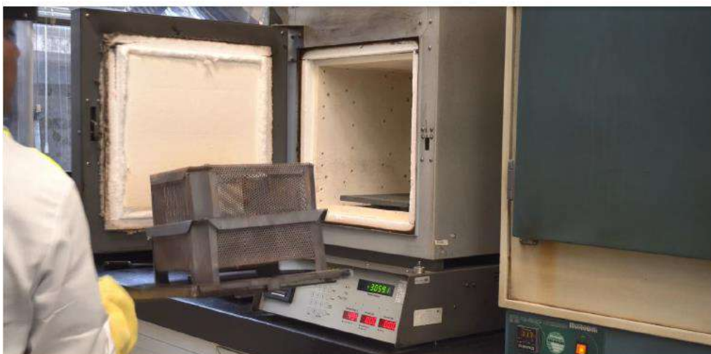
Figura 3 – Coloca-se a vasilha metálica perfurada com a amostra no forno.
