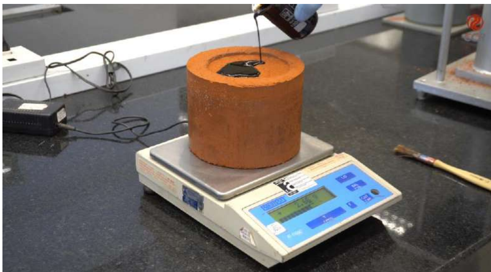
Figura 3 – Aplicar a emulsão na taxa especificada na norma sobre a área demarcada.
