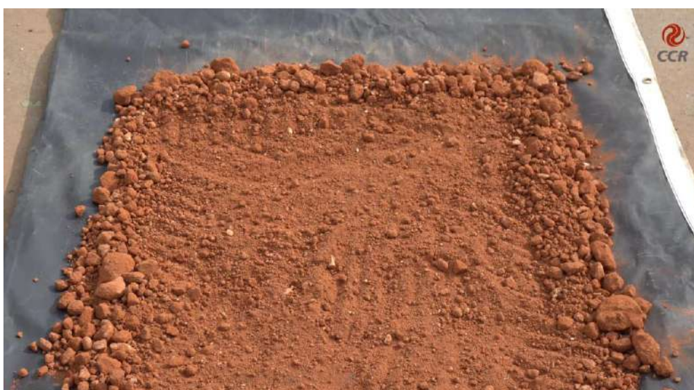
Figura 1 – Secagem ao sol da amostra do solo.
