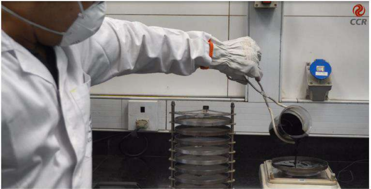
Figura 1 – Pesagem do ligante inserido na bandeja do PAV.
