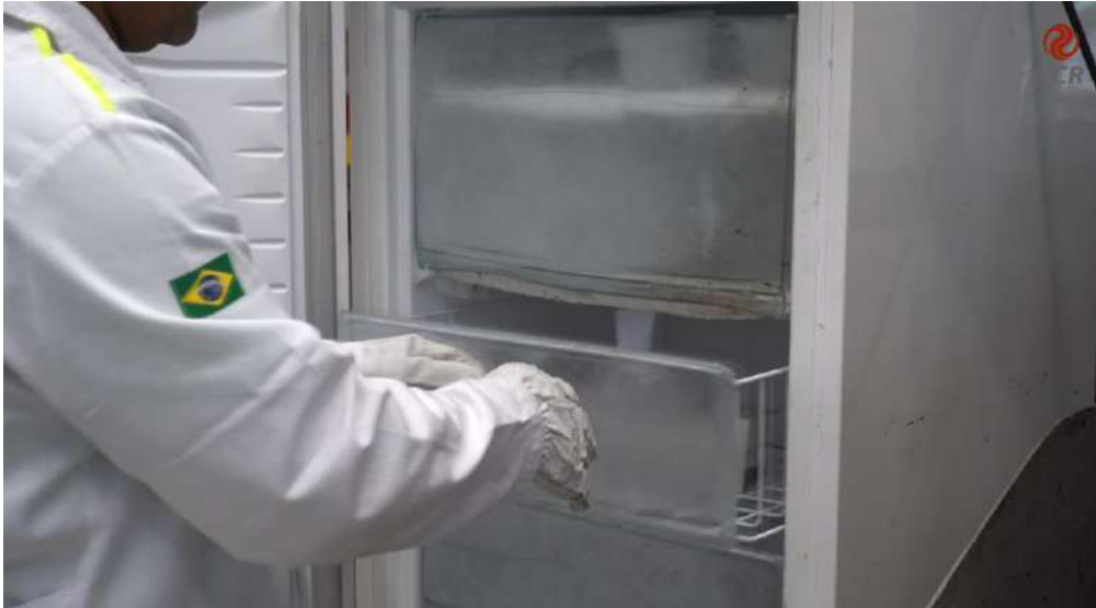
Figura 3 – Colocar o recipiente tubular com o ligante no freezer na temperatura de -18^{\circ}\text{C} .
