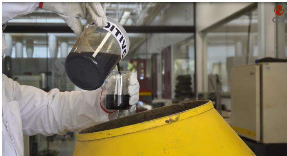
Figura 5 – Adicionar a quantidade indicada do aditivo.
