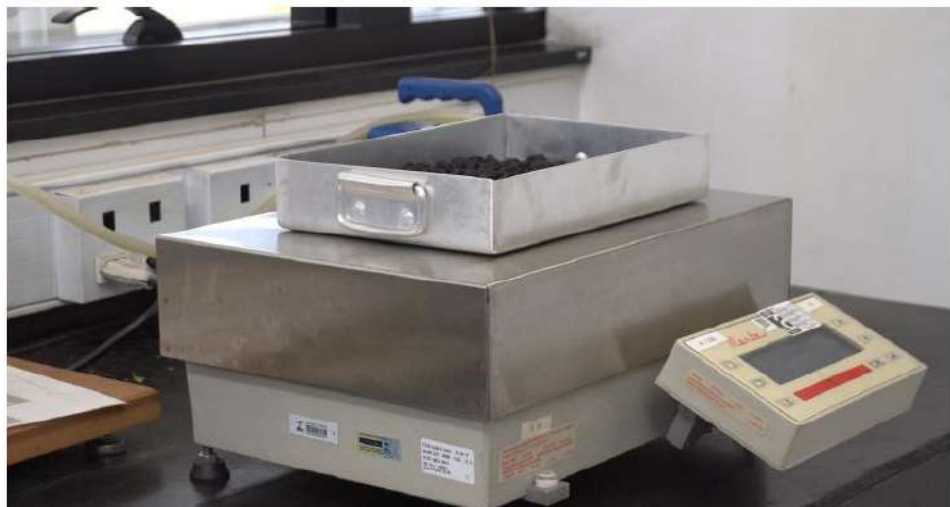
Figura 3 – Pesa-se a amostra com a quantidade necessária para a realização do ensaio.
