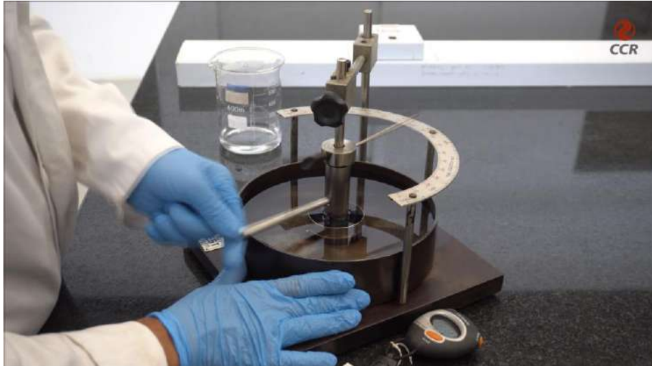
Figura 7 – Realizar a torsão da amostra no aparelho de retorno elástico.
