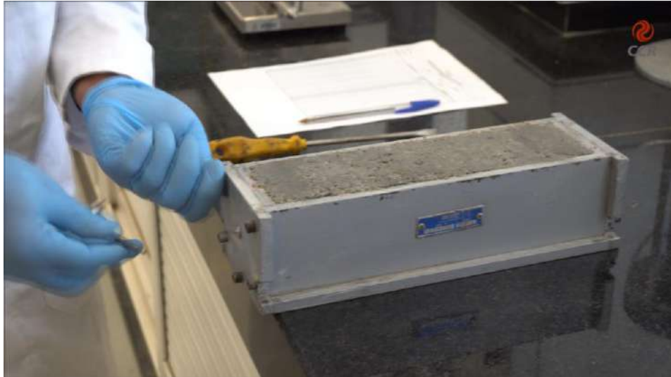
Figura 10 – Desformar a amostra da forma.
