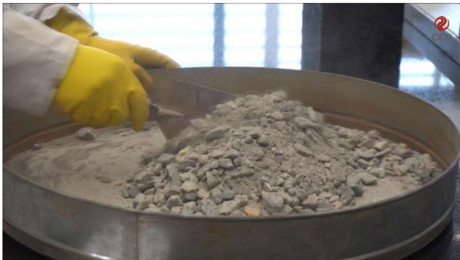
Figura 3 – Realizar a homogeneização dos agregados.
