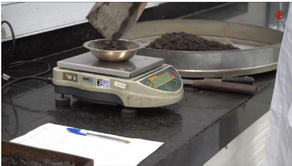
Figura 8 – Pesar uma fração da mistura para determinar o teor de umidade.
