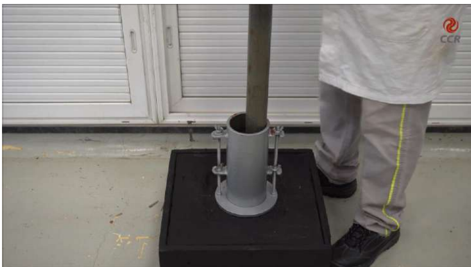
Figura 6 – Compactar a amostra de solo cal.
