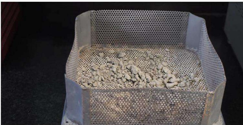
Figura 5 – Amostra após a extração do teor de betume para a realização do ensaio de granulometria.
