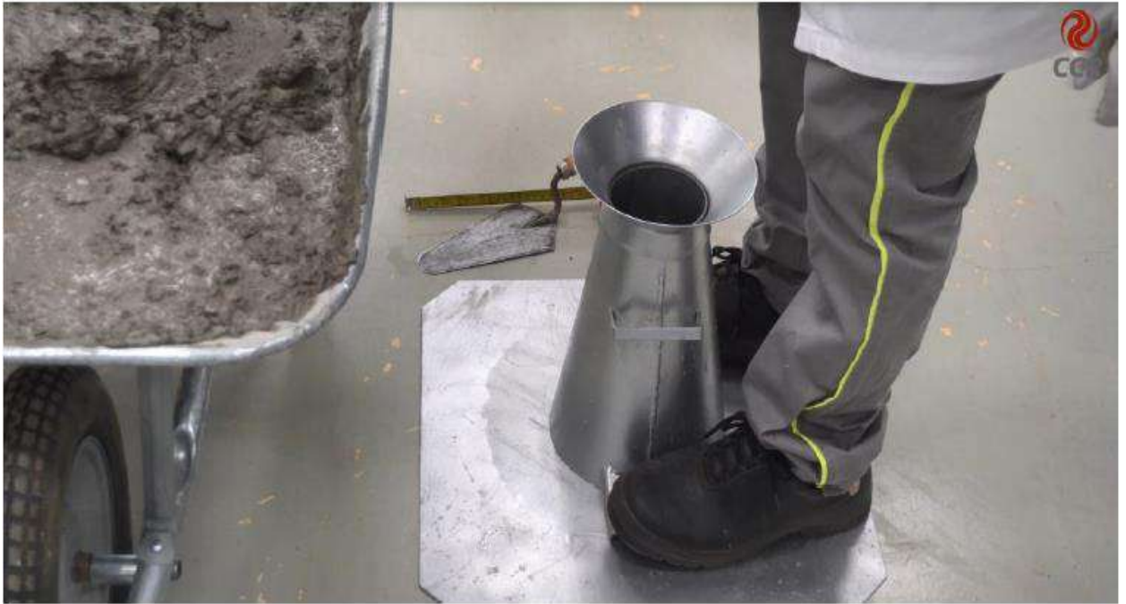
Figura 1 – Posicionar o conjunto do slump test.
