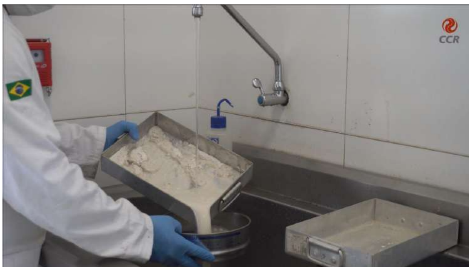
Figura 3 – Executar a lavagem da amostra de Cal pelo método via lavada.
