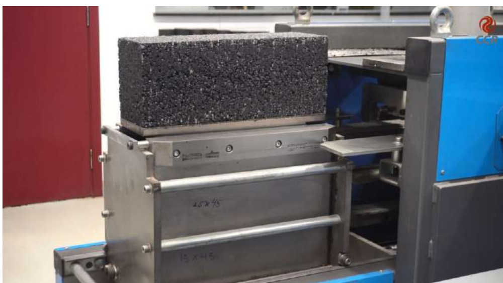
Figura 1 – Moldagem dos corpos de prova e compactação no equipamento presbox.
