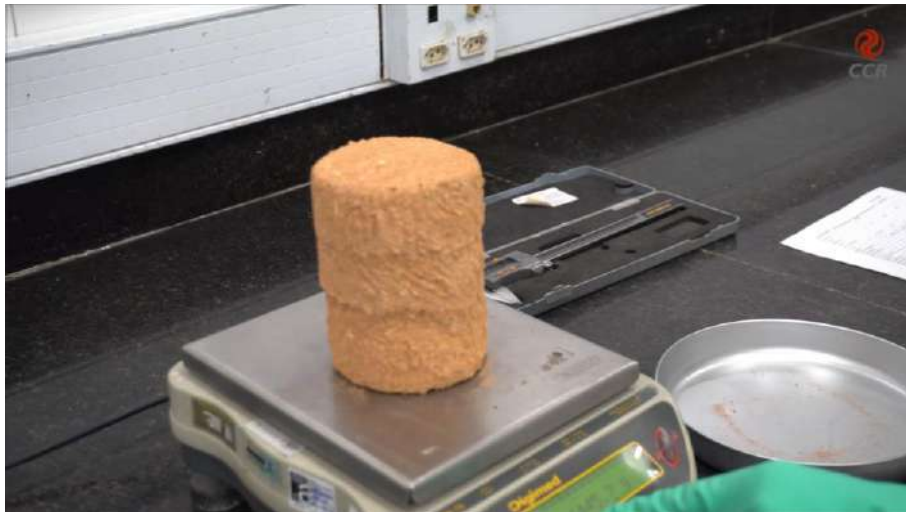
Figura 8 – Pesagem final do corpo de prova para determinação da massa após molhagem e secagem.
