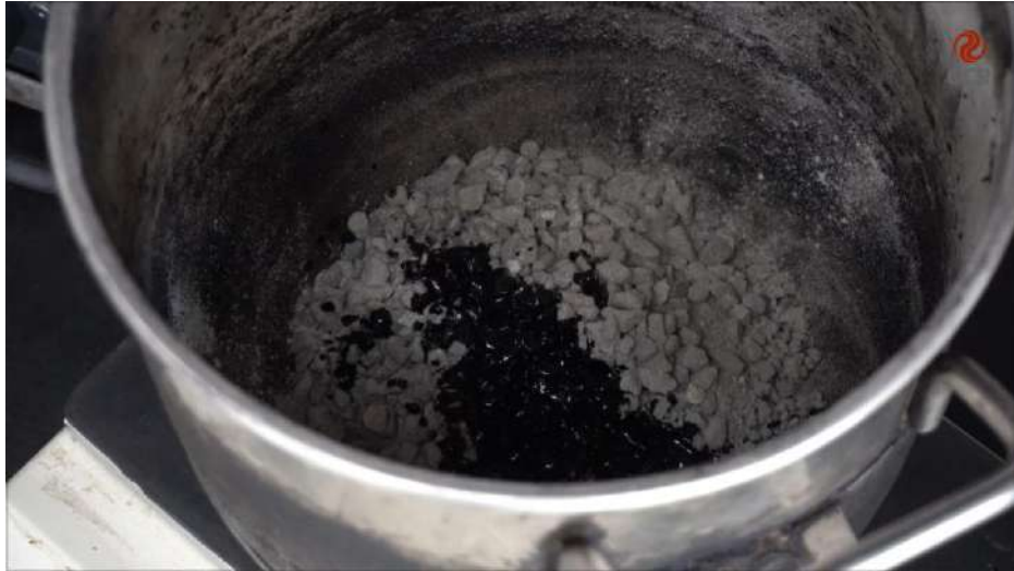
Figura 10 – Adicionar o ligante asfáltico aos agregados referente a cada teor e efetuar a mistura.
