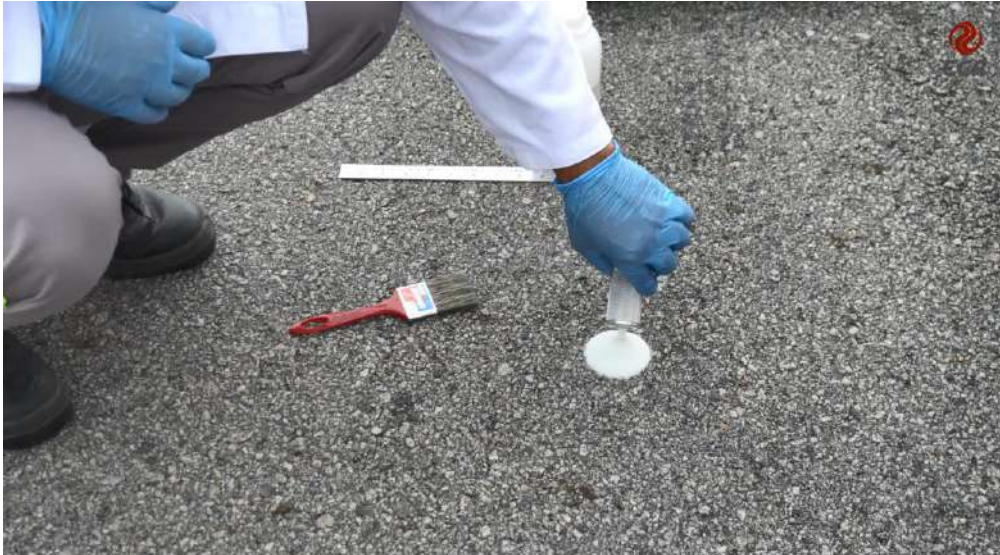
Figura 3 – Despejar os 35,60 gramas de micro esferas de vidro sobre a pista.
