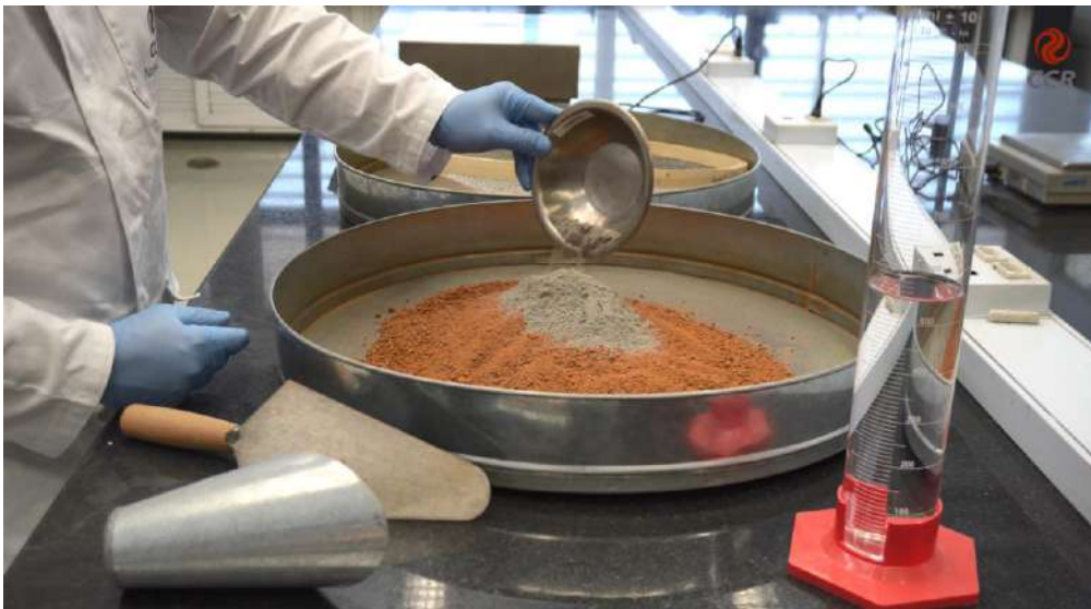
Figura 1 – Adicionar 4% em peso o cimento e realizar a mistura dos materiais.
