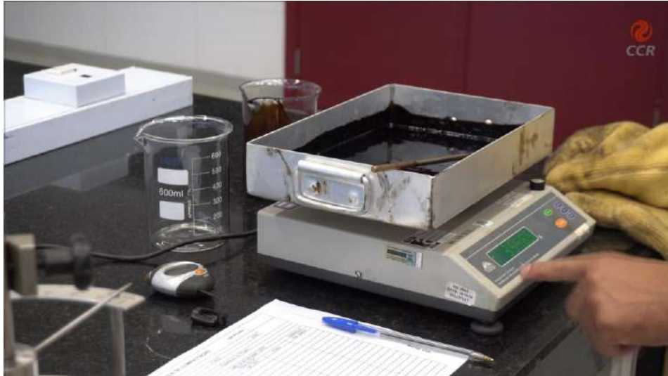
Figura 4 – Realizar a pesagem após retirar a amostra da estufa para verificar a constância de peso.
