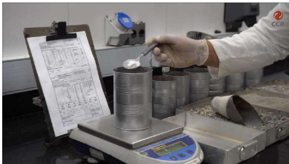
Figura 9 – Realizar as pesagens individuais dos agregados e aditivos para os cinco teores de asfalto.
