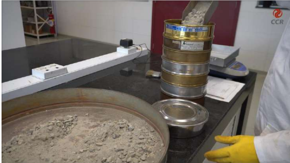
Figura 7 – Realizar a granulometria final para obter o índice de degradação.
