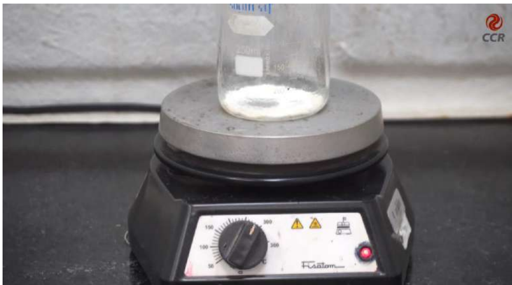
Figura 5 – Após ferver, realizar a pesagem do material remanecente.
