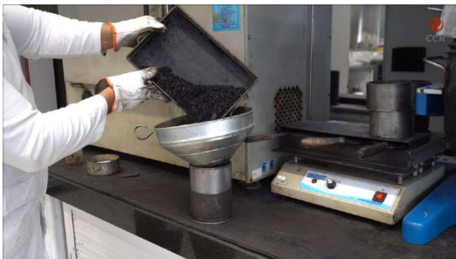
Figura 12 – Colocar a mistura asfáltica no cilindro de aço para realizar a compactação.
