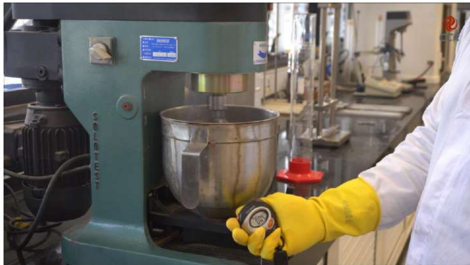
Figura 2 – Realizar a mistura parcial composta por água e cimento.
