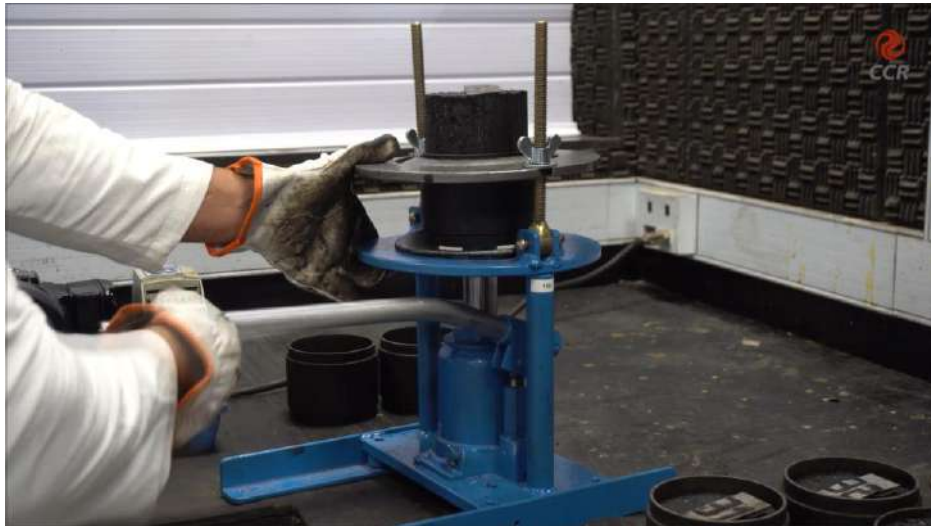
Figura 14 – Extrair o corpo de prova após compactação Marshall.
