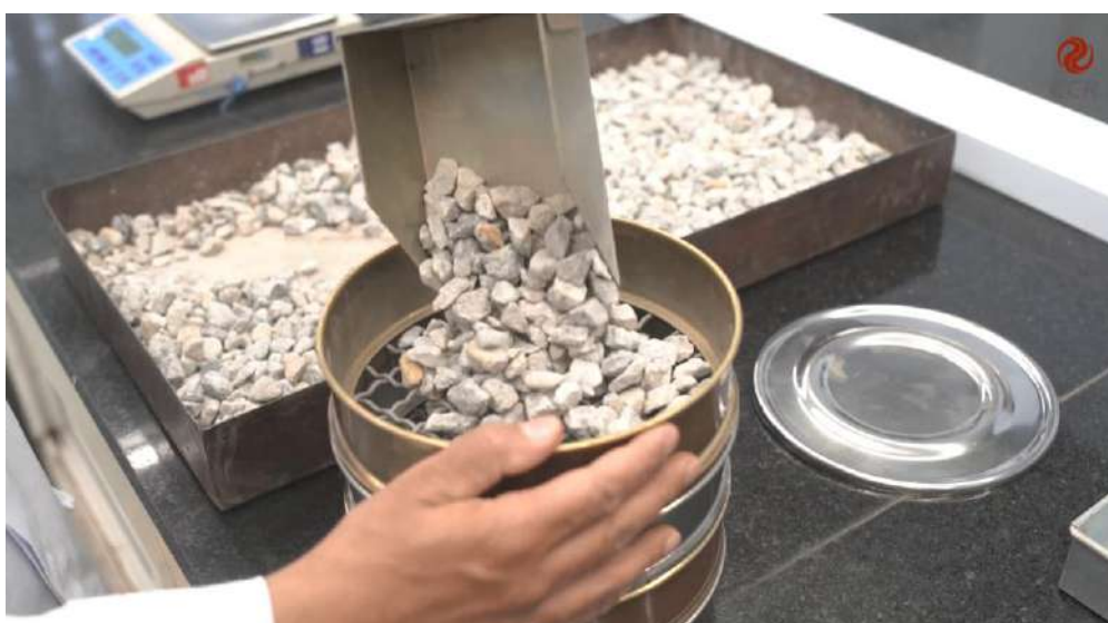
Figura 1 – Realizar o processo de peneiramento dos agregados.
