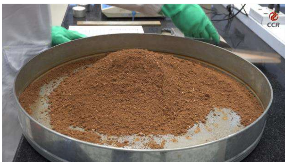
Figura 6 – Realizar a homogeneização final.
