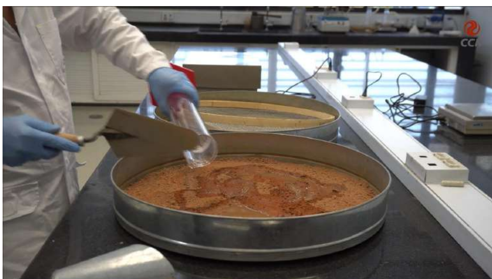
Figura 2 – Adicionar água especificada na mistura.
