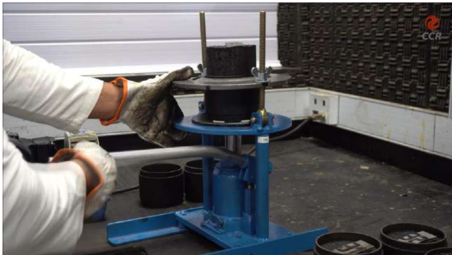
Figura 15 – Extrair o corpo de prova após compactação Marshall.
