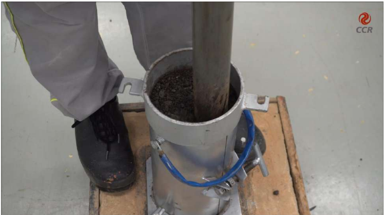
Figura 2 – Compactação da mistura para camada de base com freado.
