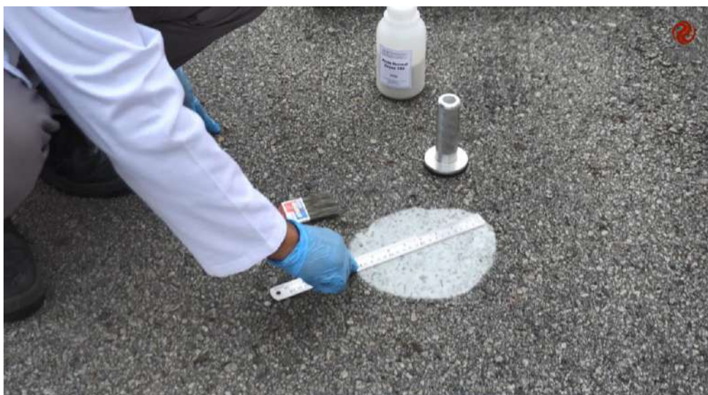
Figura 5 – Com uma régua registrar a medida de dois diâmetros opostos.
