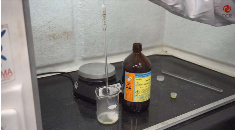
Figura 3 – Colocar 10 ml de ácido clorídrico no béquer que contém a cal.
