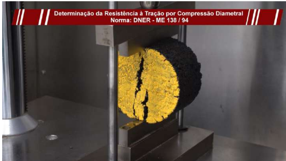
Figura 19 – Determinar a resistência à tração por compressão diametral para cada teor de ligante a 25 °C.
