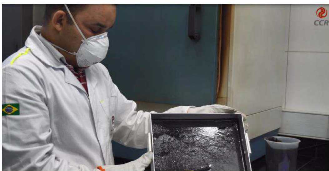
Figura 3 – Após a evaporação da emulsão na estufa determina-se a quantidade de resíduo seco.
