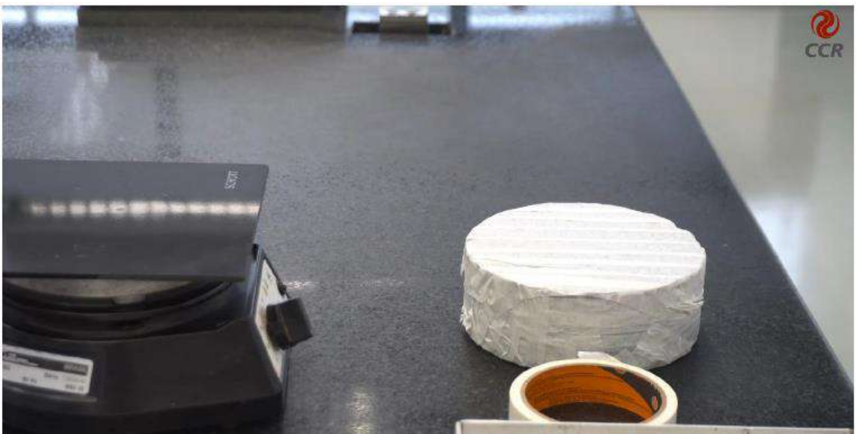
Figura 2 – Coloca-se a fita adesiva nos corpos de prova.
