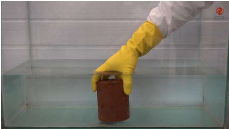
Figura 5 – Após 48 horas em cura na câmara úmida, emergir o corpo de prova.
