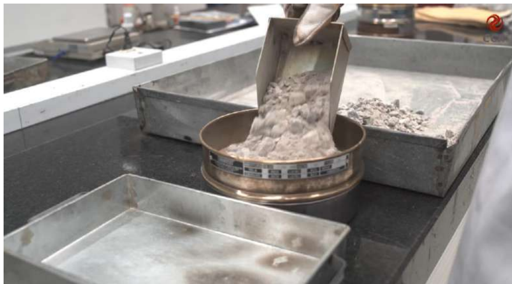
Figura 5 – Realizar novamente o processo de peneiramento dos agregados e determinar a perda.
