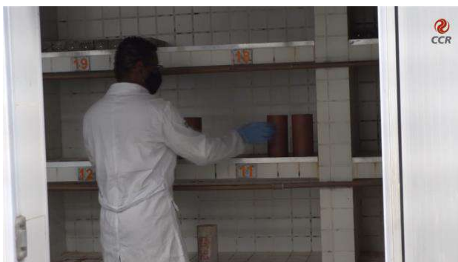
Figura 11 – Extrair os corpos de prova e deixá-los em hidratação na câmara úmida nas idades especificadas em projeto.
