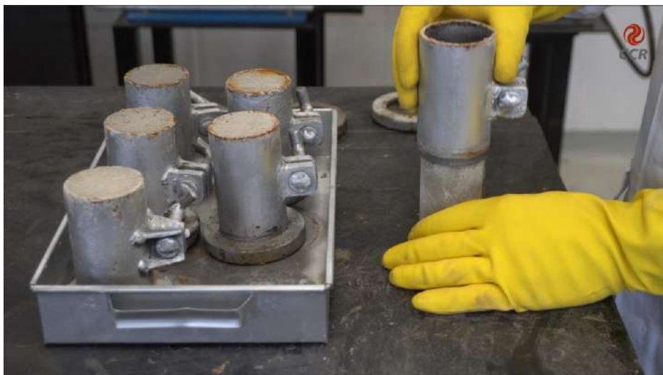
Figura 6 – Após 24 horas na câmara úmida desmoldar os corpos de prova.
