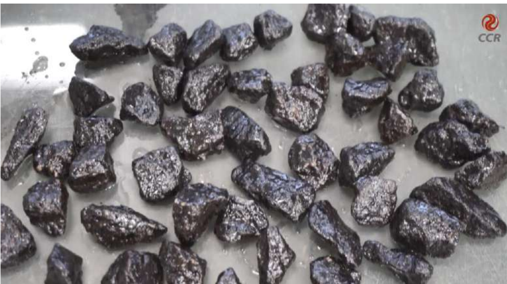
Figura 5 – Após 72 horas na estufa observar se existe desprendimento do ligante do agregado.
