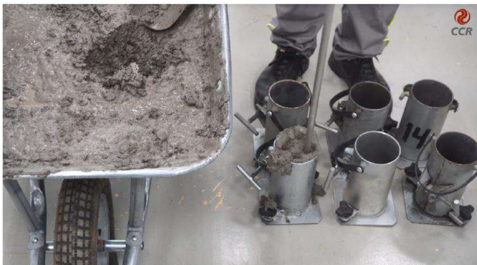
Figura 2 – Realizar a moldagem dos corpos de prova.
