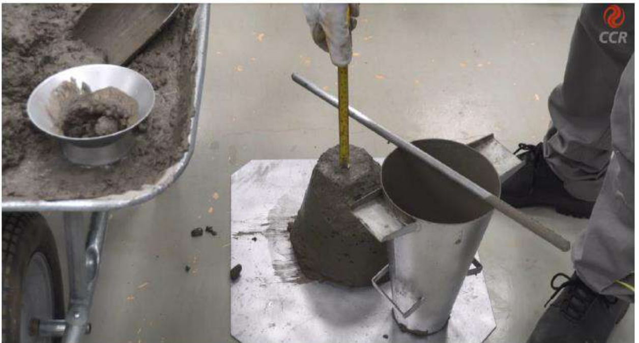
Figura 4 – Realizar o abatimento do tronco cone.
