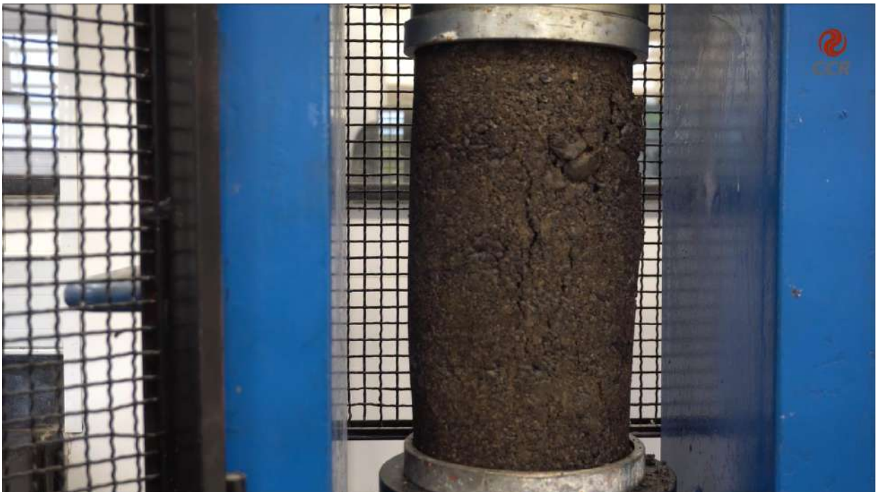
Figura 4 – Ruptura por compressão simples do corpo de prova cilíndrico.
