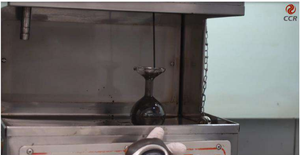
Figura 4 – Mede-se o tempo de preenchimento do frasco de 60 ml em segundos.
