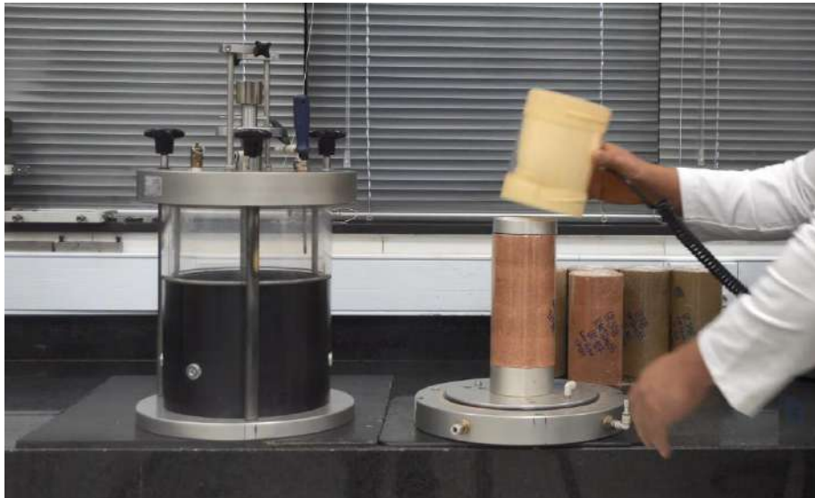
Figura 1 – Colocação da membrana ao corpo de prova com auxílio do encamisador.
