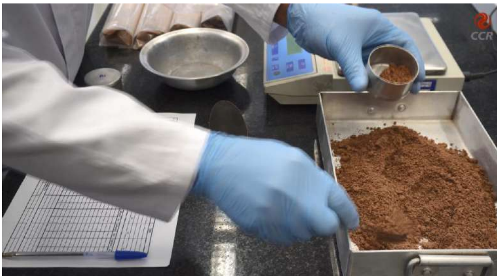
Figura 5 – Obter o teor de umidade do solo.
