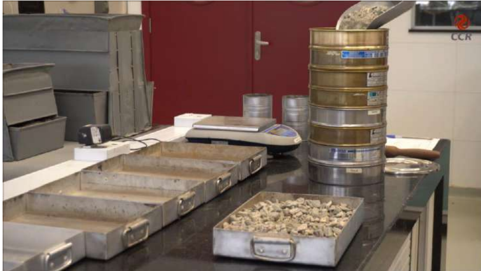
Figura 1 – Realizar o peneiramento dos agregados.
