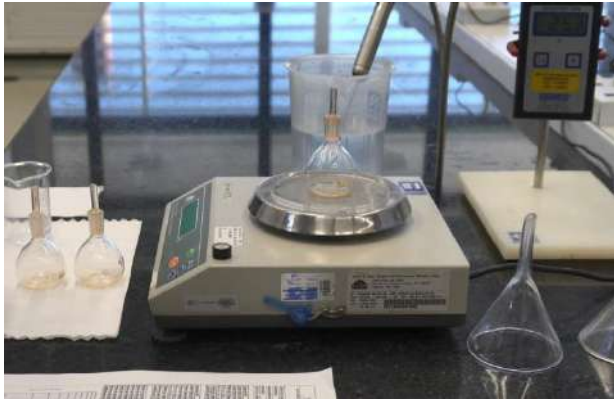
❖ Pesagem do picnômetro seco e vazio;
