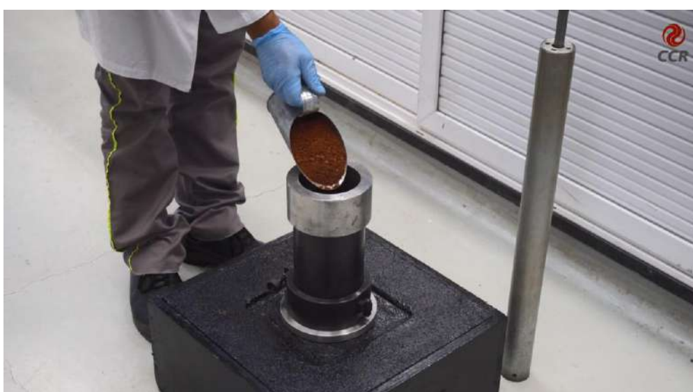
Figura 2 – Compactação do corpo de prova na energia indicada na norma.
