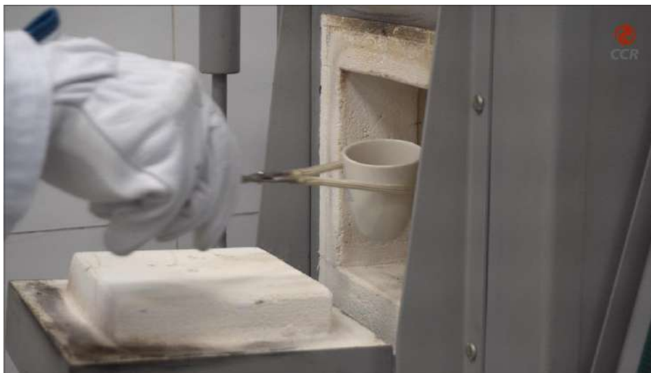
Figura 5 – Retirar a amostra após a queima a 440 °C.
