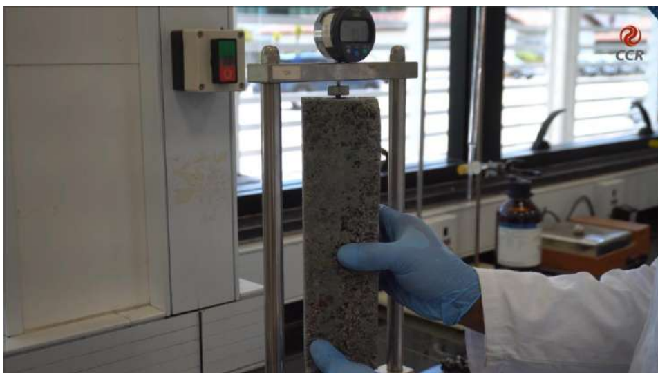
Figura 12 – Realizar a leitura do corpo de prova no equipamento medidor de comprimento.
