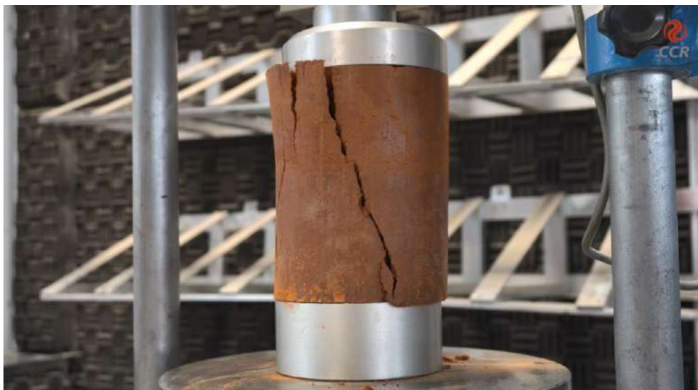
Figura 5 – Aplicar o carregamento até a ruptura dos corpos de prova.
