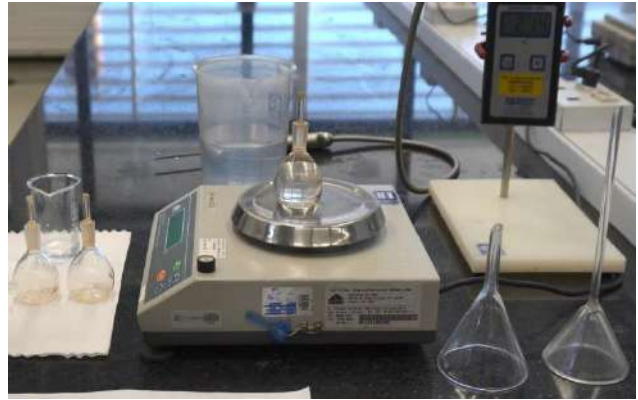
❖ Pesagem do picnômetro + Água;
