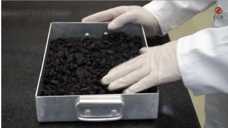
Figura 1 – Amostra na condição destorroada.
