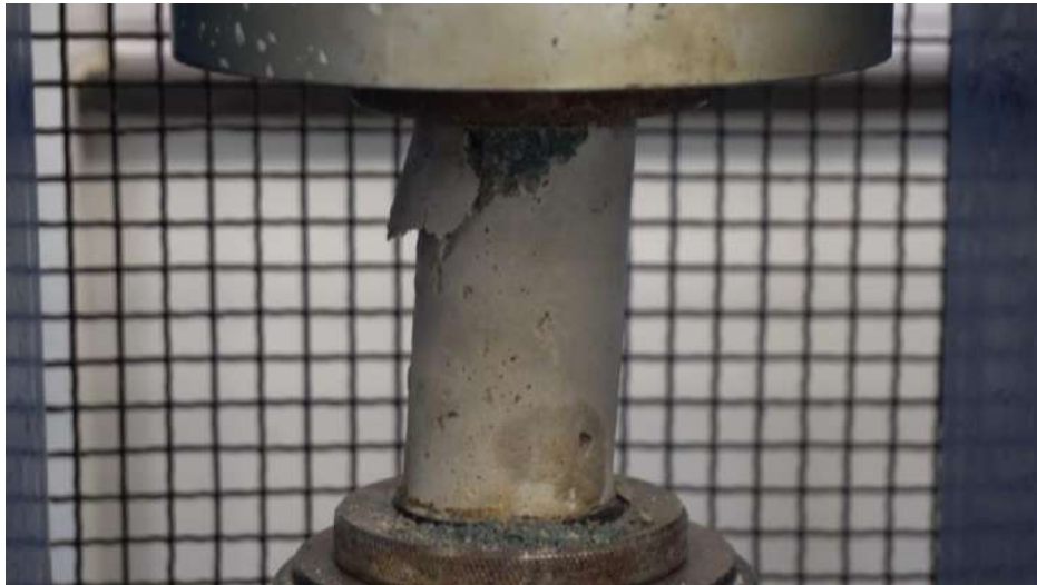
Figura 8 –Ruptura do corpo de prova.
