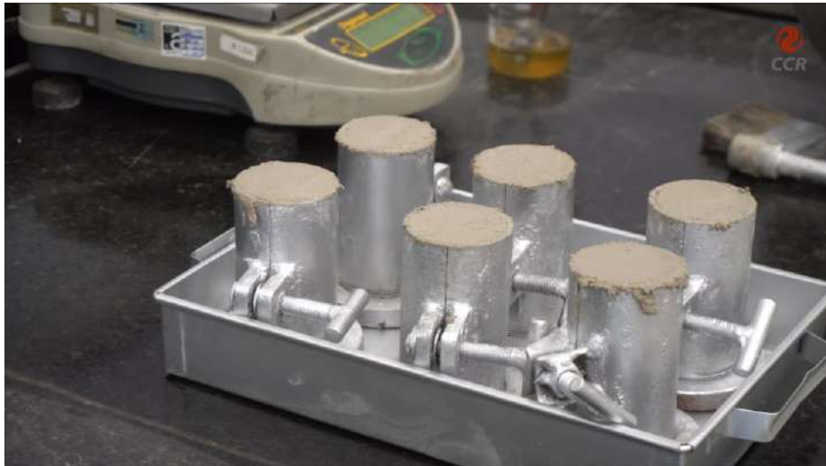
Figura 5 – Moldar os corpos de prova.
