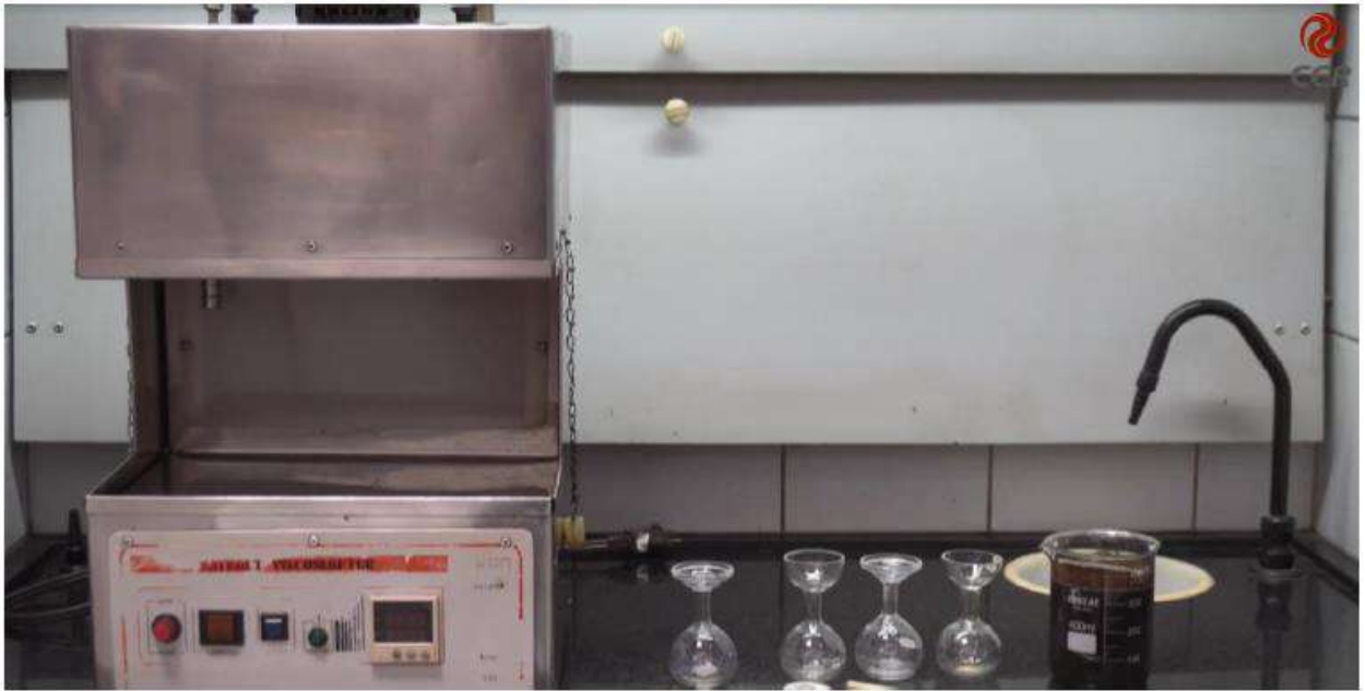
Figura 1 – Equipamentos e recipientes utilizados para o ensaio de viscosidade Saybolt Furol.
