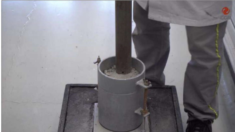
Figura 4 – Realizar a compactação no molde com disco espaçador em 5 camadas iguais.
