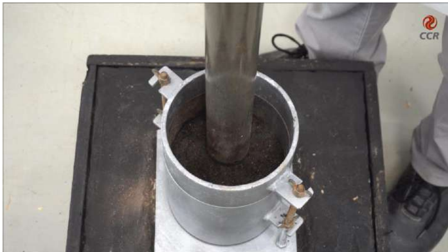
Figura 2 – Realizar a compactação da mistura com fresado.
