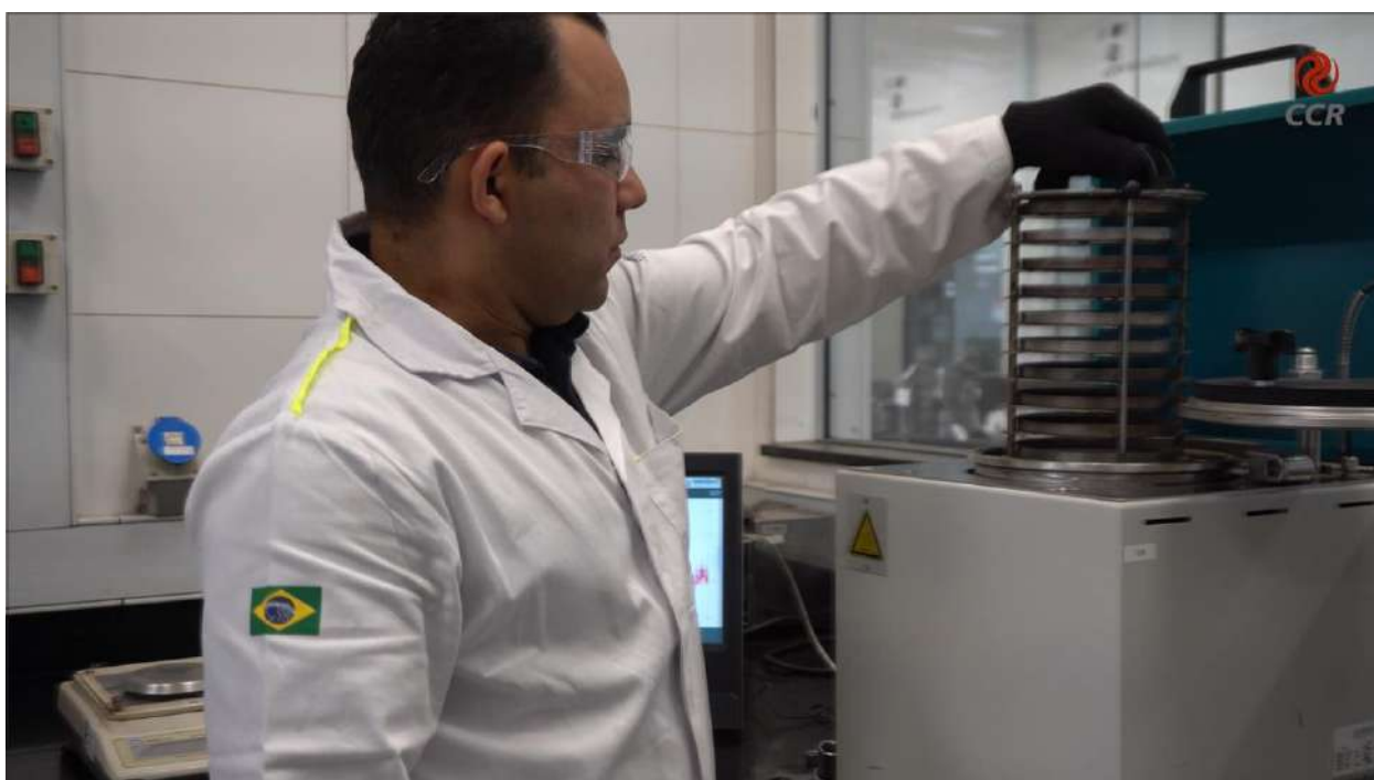
Figura 4 – Retira-se a amostra de ligante envelhecida do PAV.
