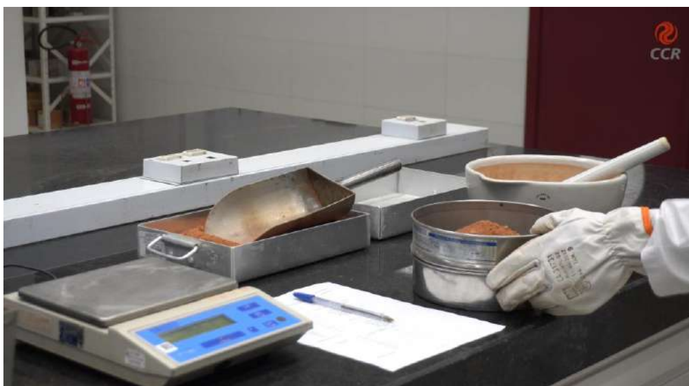
Figura 4 – Realização do processo de peneiramento manual.
