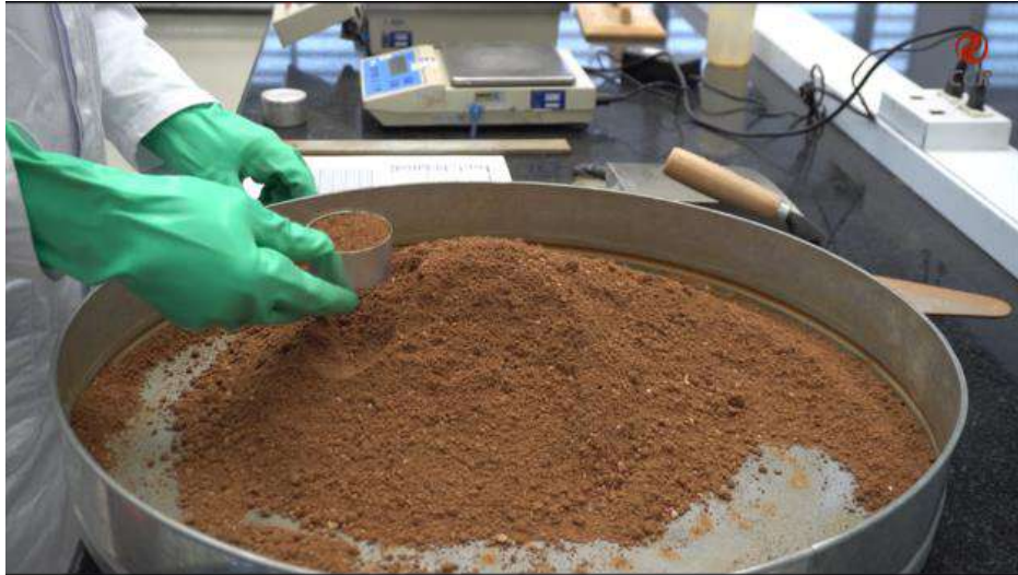
Figura 7 – Retirar uma amostra para determinar o teor de umidade.
