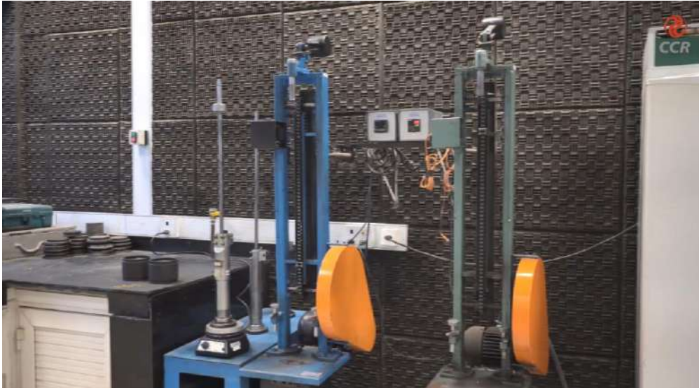
Figura 3 – Compactação marshall com 120 golpes por lado.
