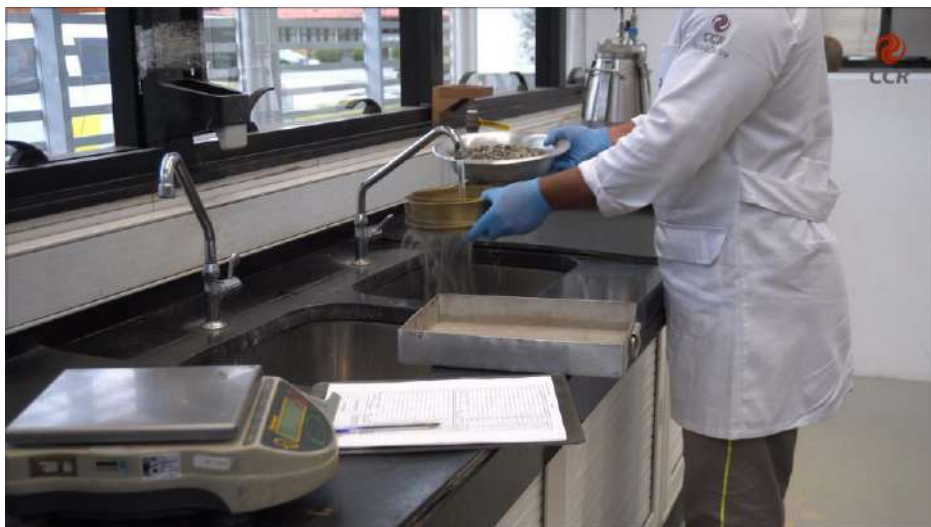
Figura 3 – Lavar os agregados e deixá-los imersos em água por 15 horas.
