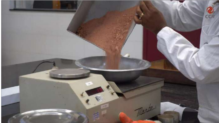
Figura 4 – Pesar a amostra de solo reduzida.
