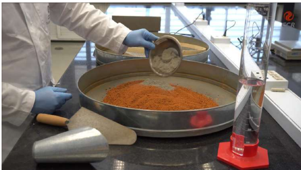
Figura 1 – Adicionar a quantidade especificada de cimento no projeto ao solo.
