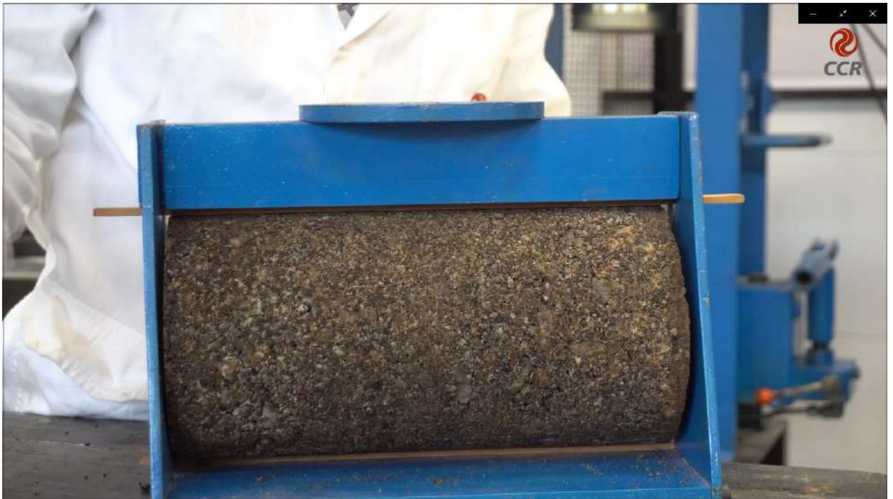
Figura 3 – Inserção do corpo de prova cilíndrico na prensa de compressão.
