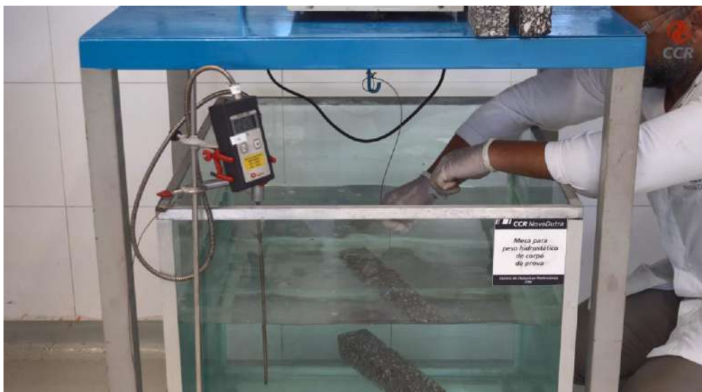
Figura 3 – Realizar a pesagem hidrostática das vigotas para a obtenção dos vazios da mistura.
