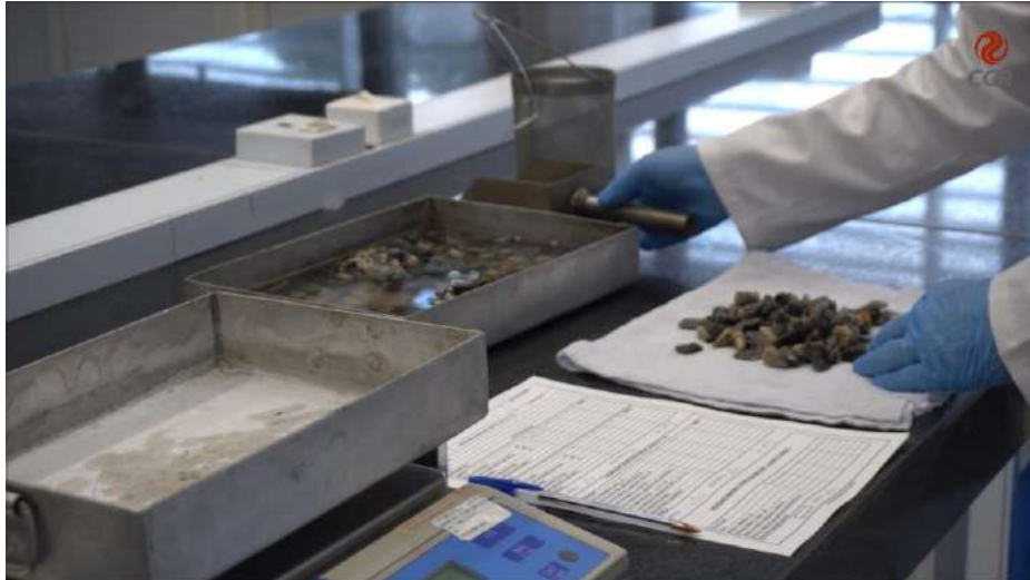
Figura 4 – Determinar a densidade real, densidade aparente e absorção dos agregados graúdos.
