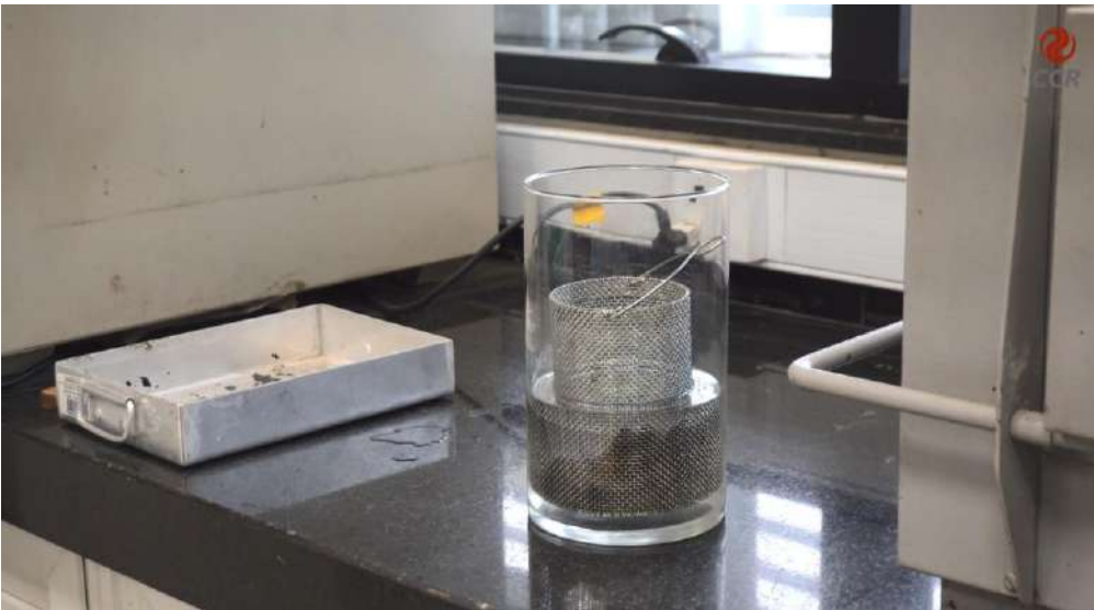
Figura 4 – Após a ruptura da emulsão asfáltica mergulhar os agregados em água e levar a estufa.
