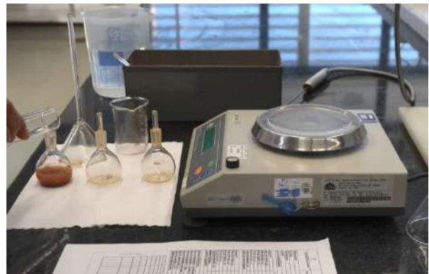
❖ Adicionar água no picnômetro;
