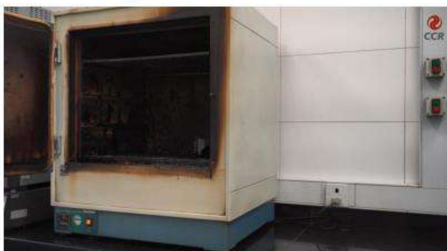
Figura 2 – Aquecer o ligante na estufa até que se encontre na totalmente fluida.
