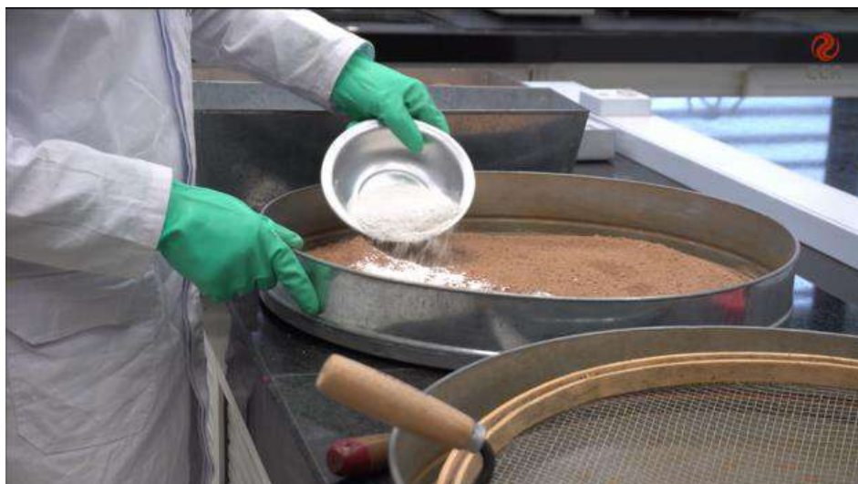
Figura 4 – Pesar a amostra de solo e cal e realizar a mistura.
