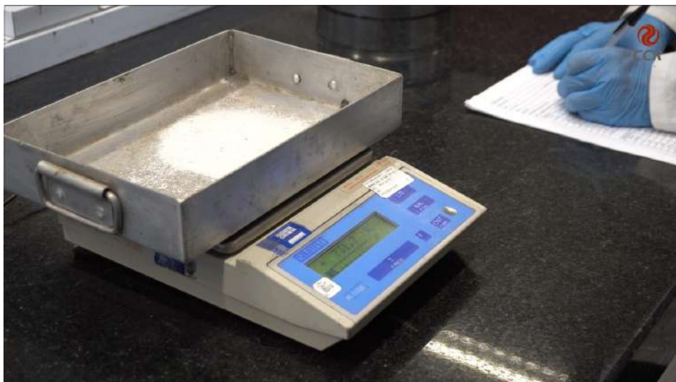
Figura 5 – Pesar a amostra de Cal.
