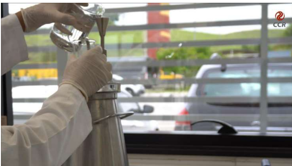
Figura 6 – Adiciona-se água para atingir o nível específico e posteriormente pesa-se o conjunto.
