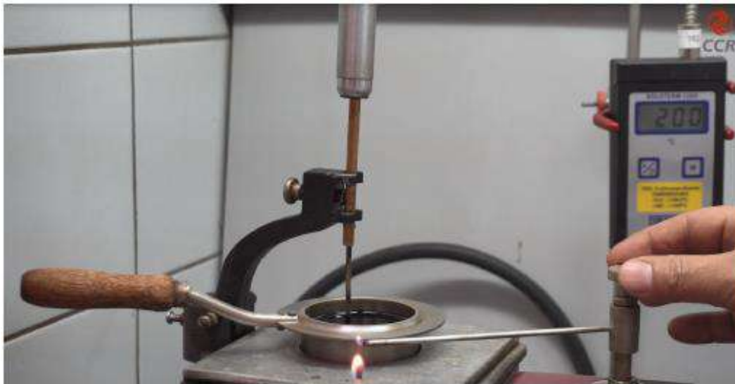
Figura 2 – Aquece-se amostra de CAP, este material libera voláteis, estes ocasionam a combustão a determinada temperatura.
