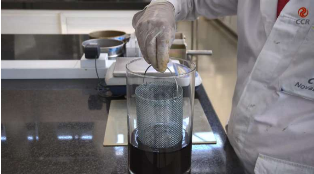
Figura 3 – Mergulhar os agregados na emulsão asfáltica.
