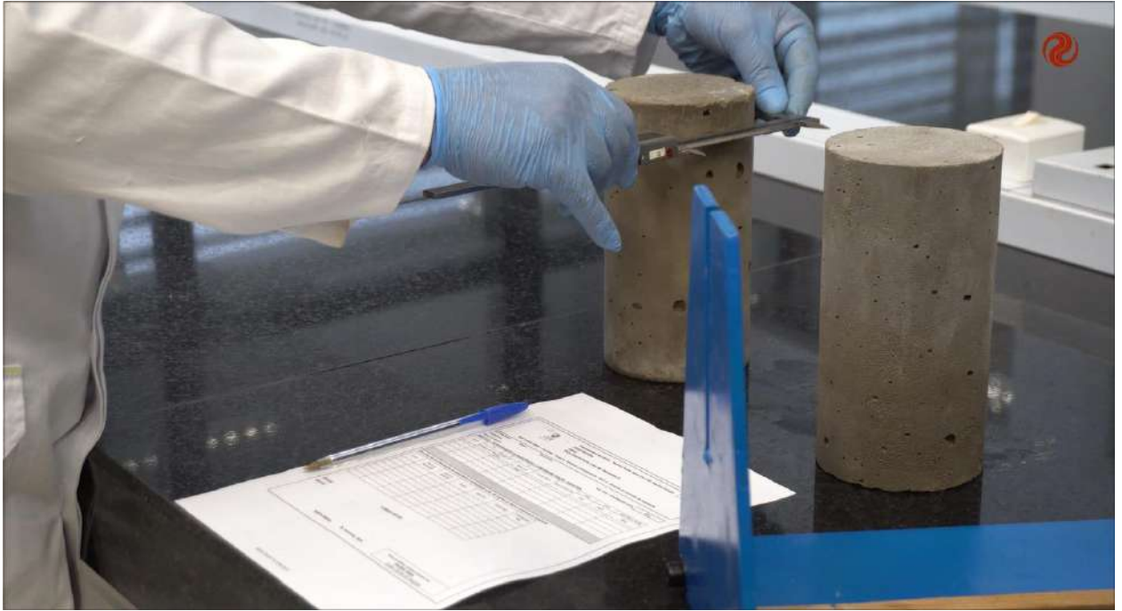
Figura 1 – Medir o corpo de prova com o paquímetro.
