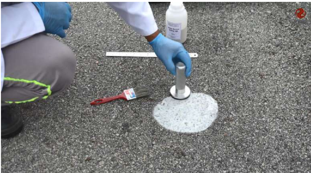
Figura 4 – Com auxílio do disco de base de emborrachada espargir as esferas de vidro.
