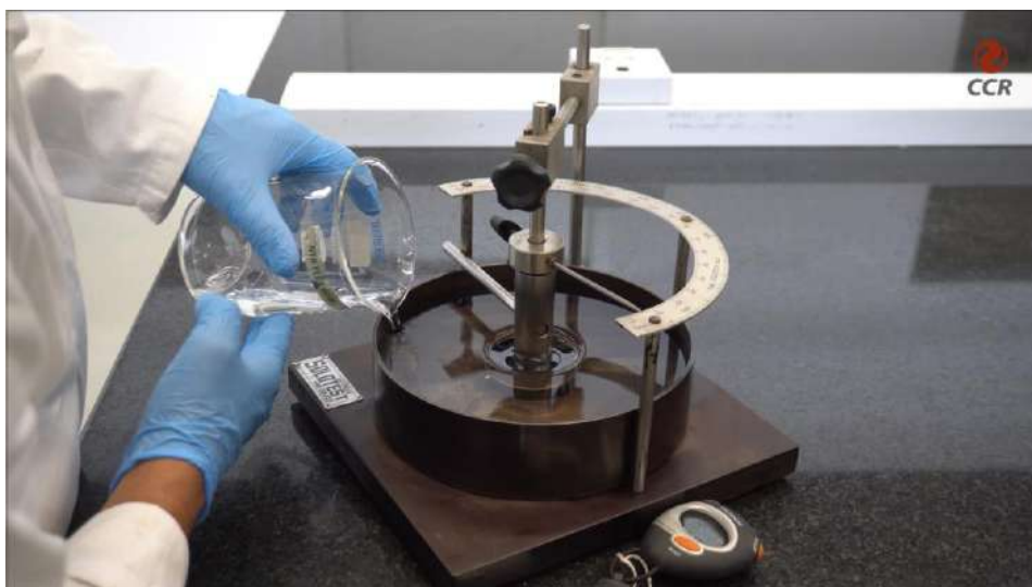
Figura 6 – Adiciona-se água na amostra para mantê-la a 25 °C.
