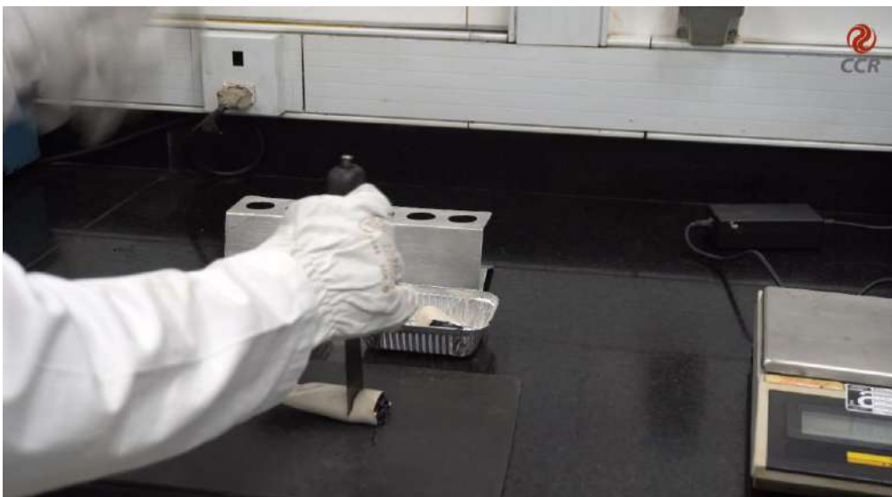
Figura 5 – Selecionar o terço central do recipiente tubular para os diversos ensaios.
