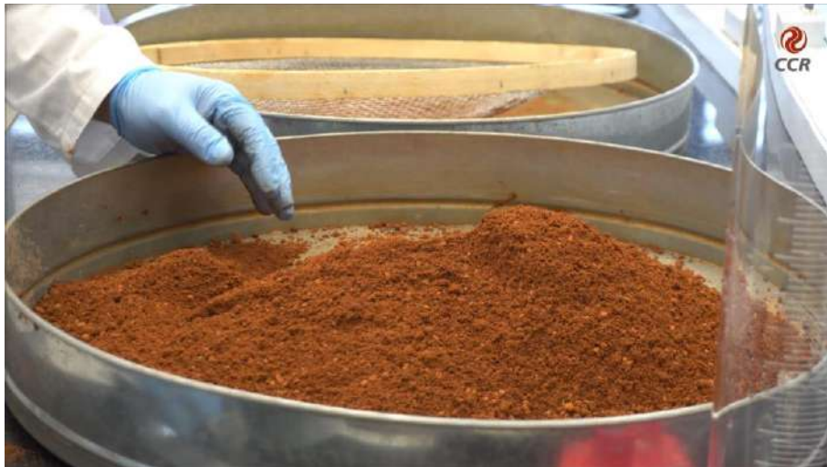
Figura 2 – Mistura solo cimento.
