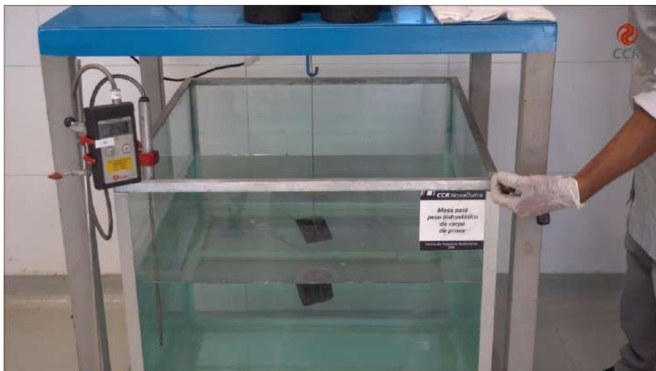
Figura 15 – Determinar a densidade aparente referente a cada teor de ligante.
