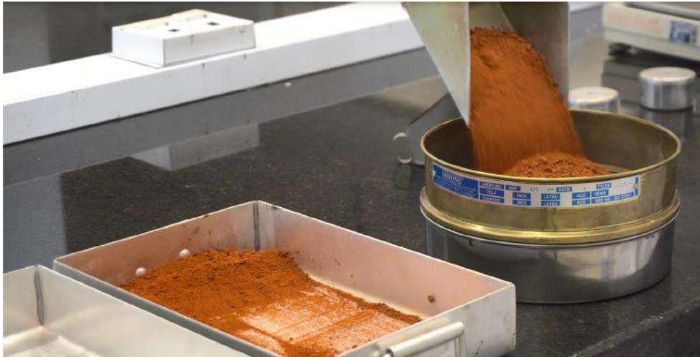
Figura 1 – Coloca-se a amostra em uma bandeja e em seguida passa-se na peneira.
