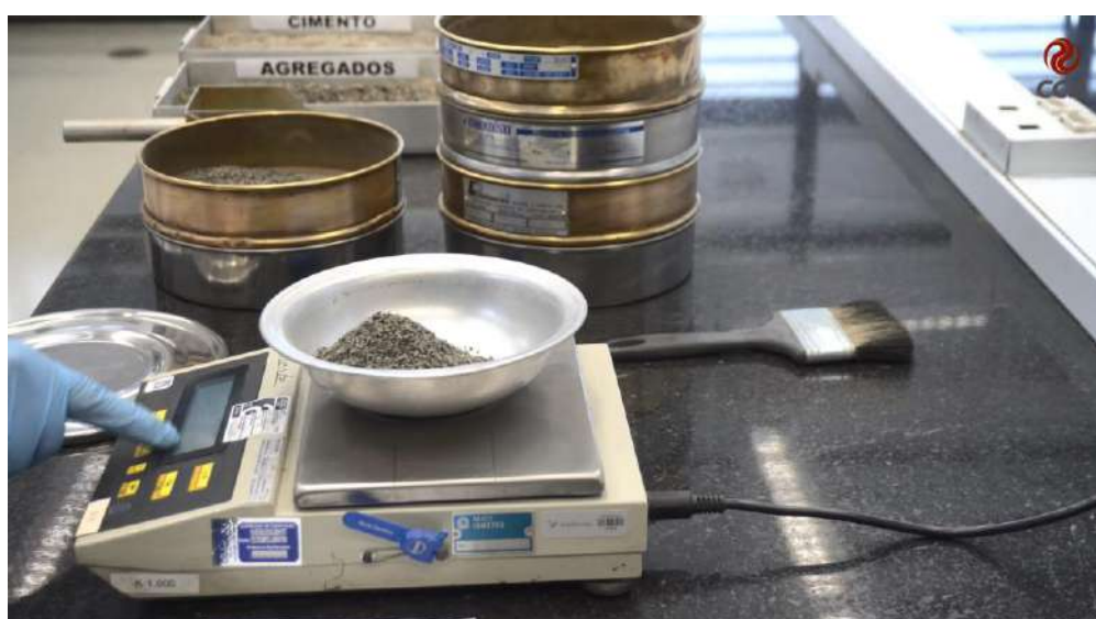
Figura 2 – Pesar as frações dos agregados especificados na norma.
