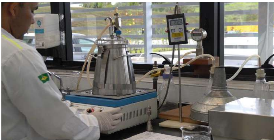
Figura 5 – Amostra sendo ensaiada no conjunto Rice.
