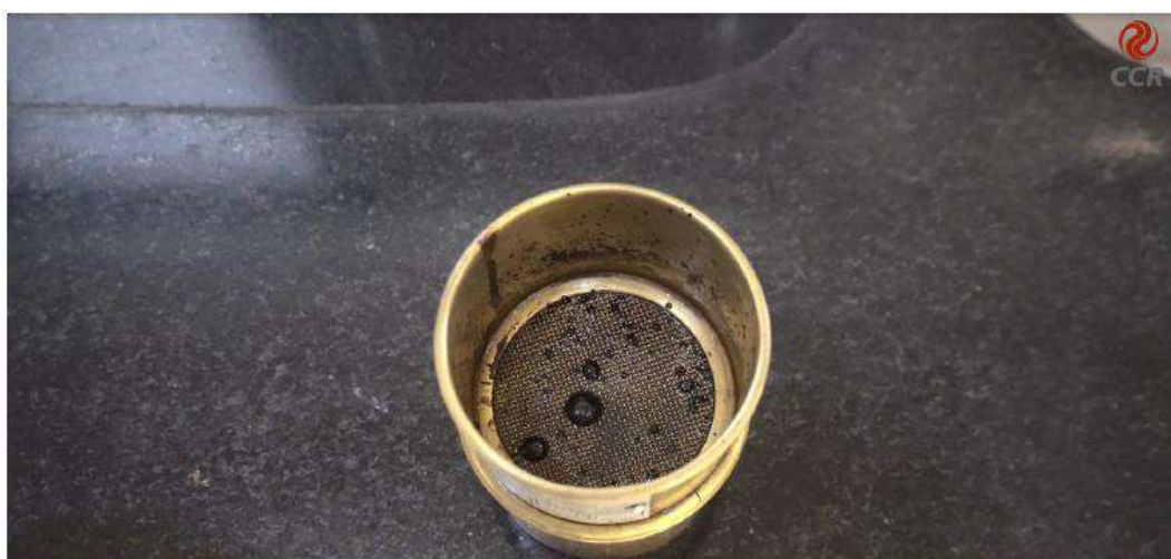
Figura 3 – Após secar em estufa, pesa-se o conjunto para a obtenção do peso do resíduo.
