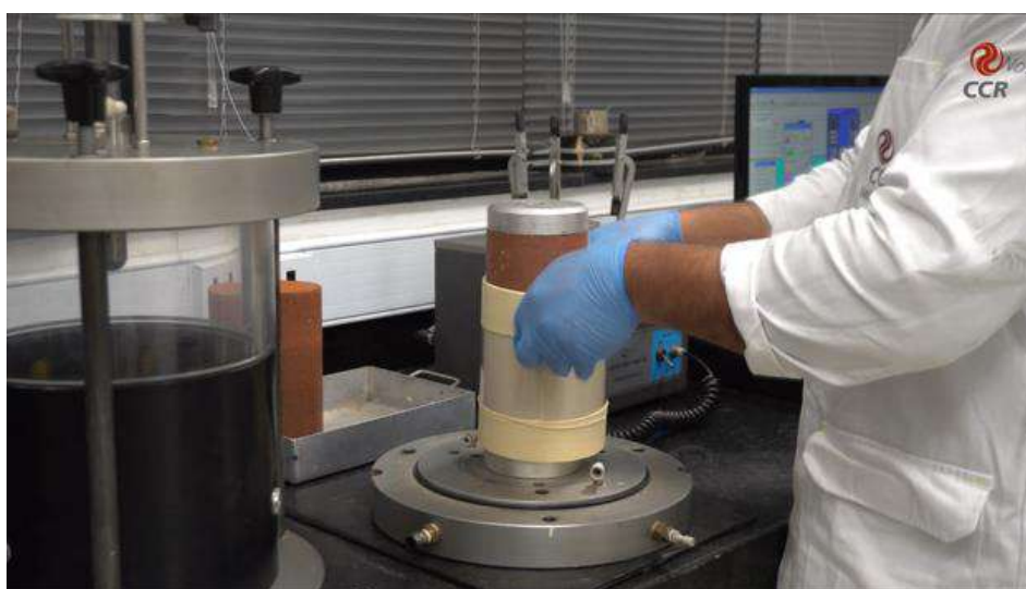
Figura 12 – Preparar o corpo de prova para realizar o teste de Módulo de Resiliência.
