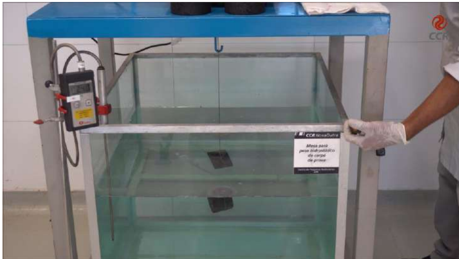
Figura 16 – Determinar a densidade aparente referente a cada teor de ligante.
