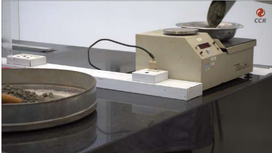
Figura 4 – Coletar uma fração da amostra para verificar o teor de umidade.
