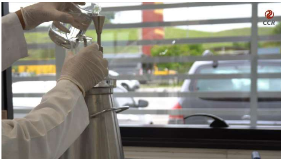
Figura 2 – Calibração do equipamento frasco metálico.
