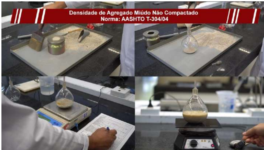
Figura 5 – Determinar a densidade real, densidade aparente e absorção dos agregados miúdos.
