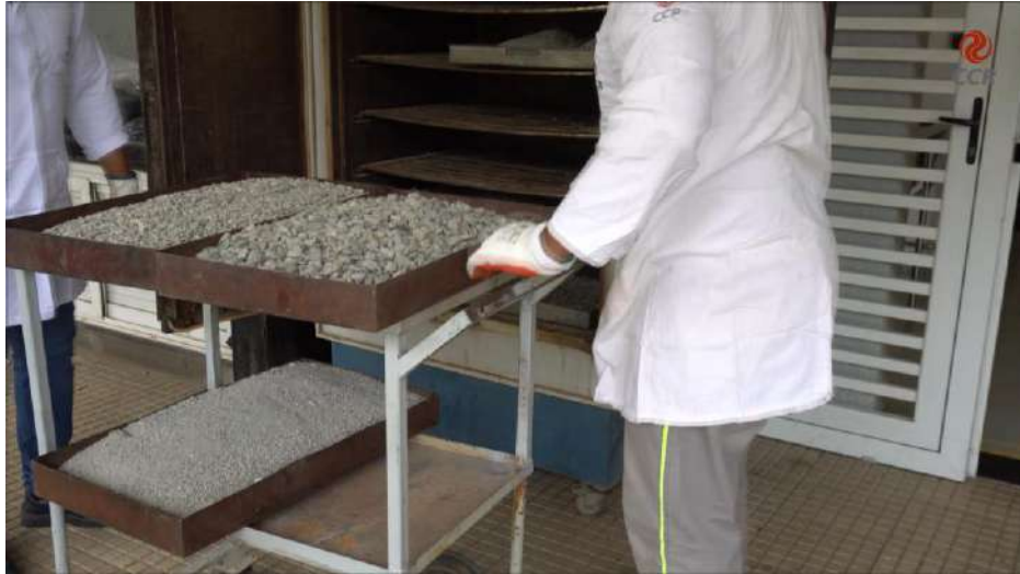
Figura 1 – Secar os agregados na temperatura de 110\text{ }^{\circ}\text{C} \pm 5\text{ }^{\circ}\text{C} .
