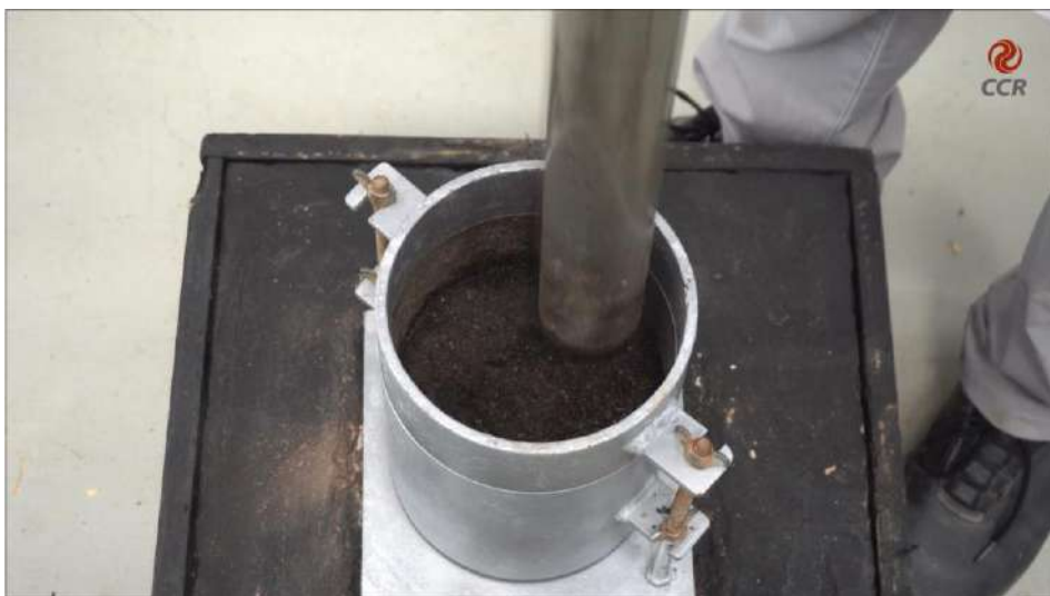
Figura 9 – Realizar a compactação da amostra.
