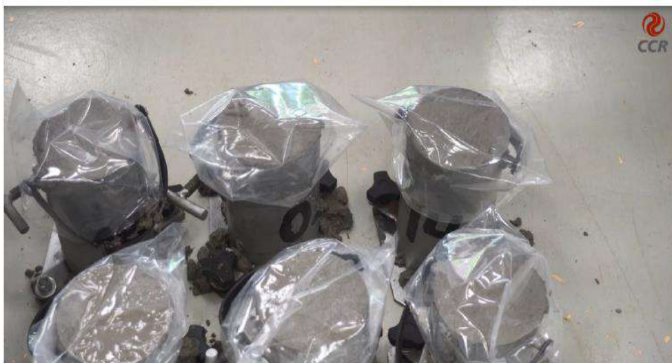
Figura 3 – Colocar uma proteção nos corpos de prova até ser desmoldado.
