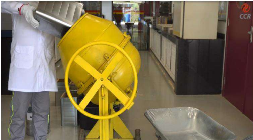
Figura 2 – Adicionar o agregado graúdo na betoneira.
