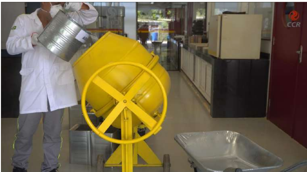
Figura 3 – Adicionar uma fração de água na betoneira.
