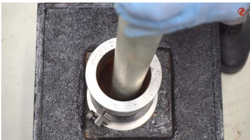
Figura 1 – Moldagem dos corpos de prova cilíndricos.
