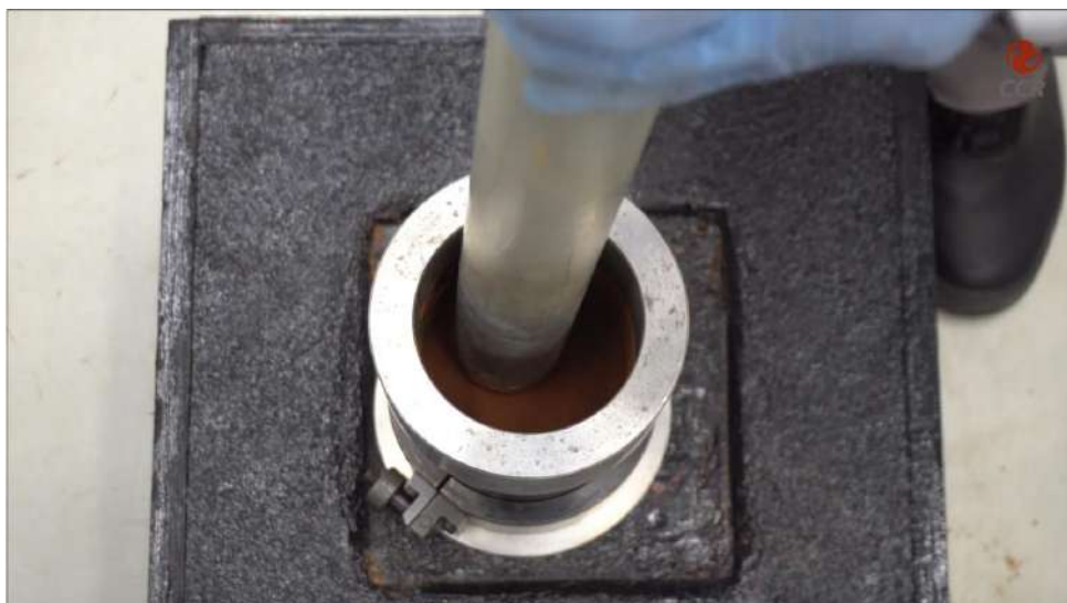
Figura 4 – Realizar a compactação.
