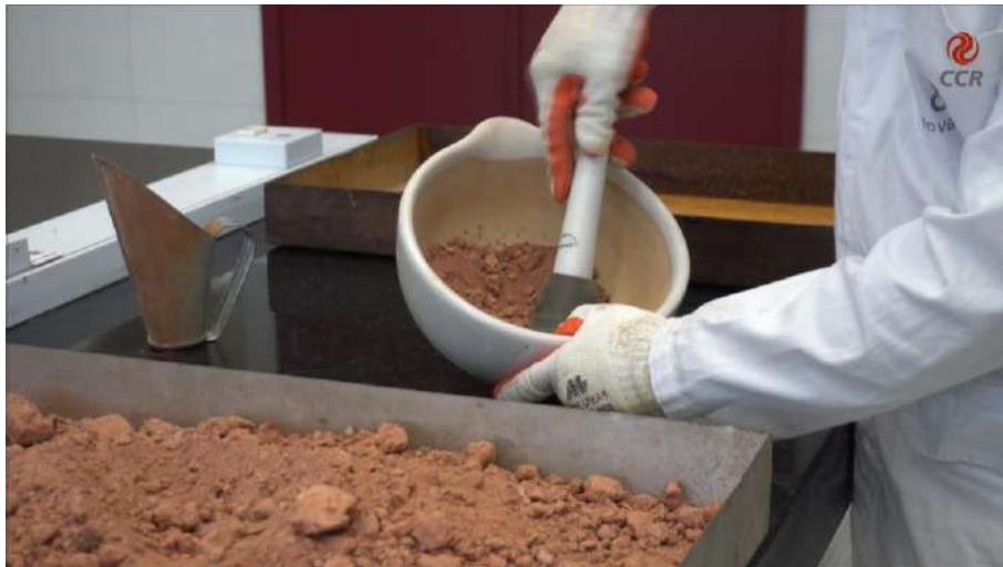
Figura 2 – Destorroar a amostra de solo.
