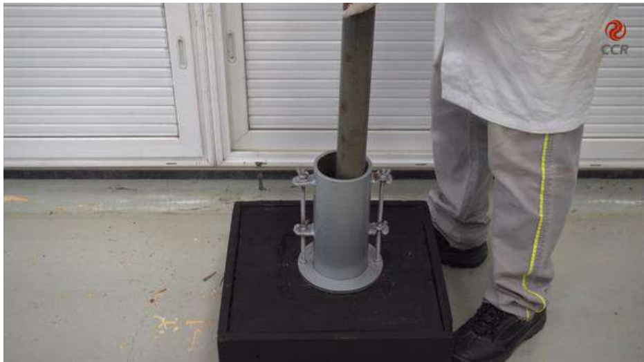
Figura 8 – Realizar a compactação da primeira camada na energia especificada em projeto.
