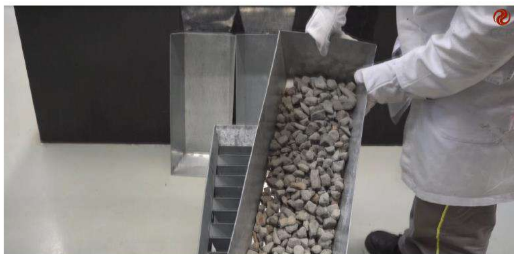
Figura 3 – Amostra pós quarteamento para a realização da granulometria.
