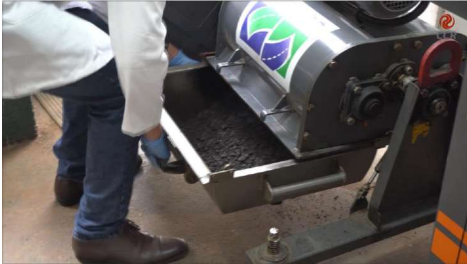
Figura 7 – Retirar a mistura para ensaios de compactação.
