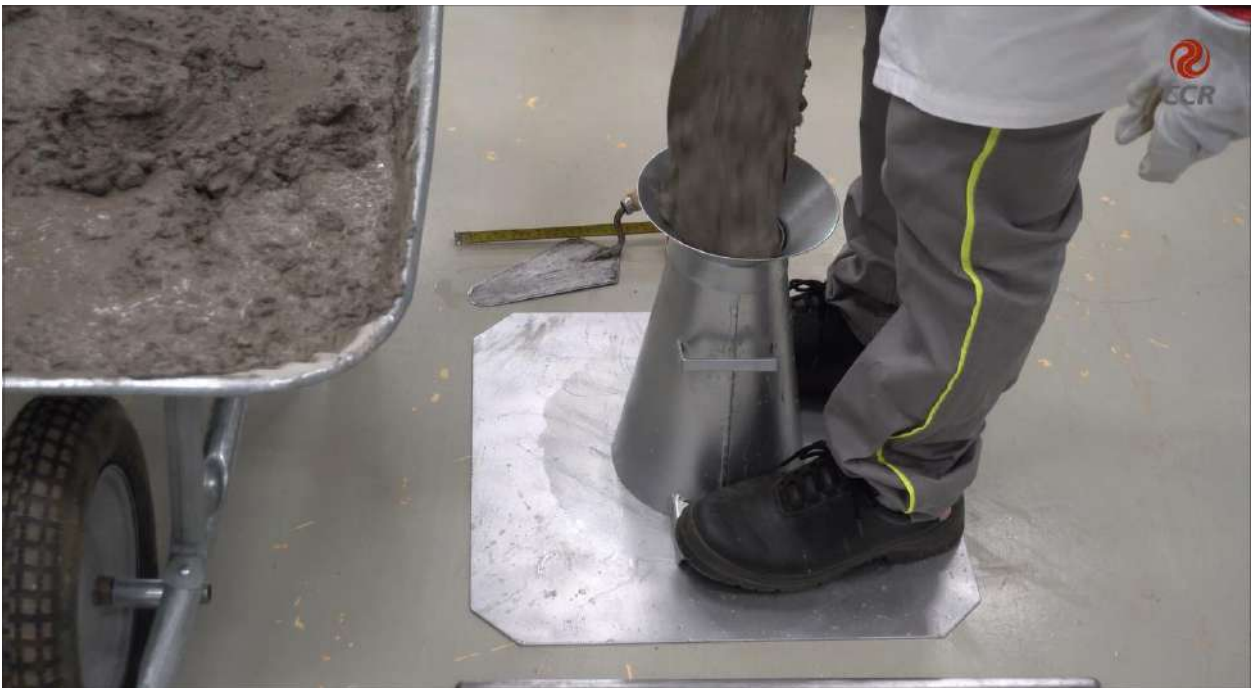
Figura 2 – Colocar o concreto no conjunto do slump test.
