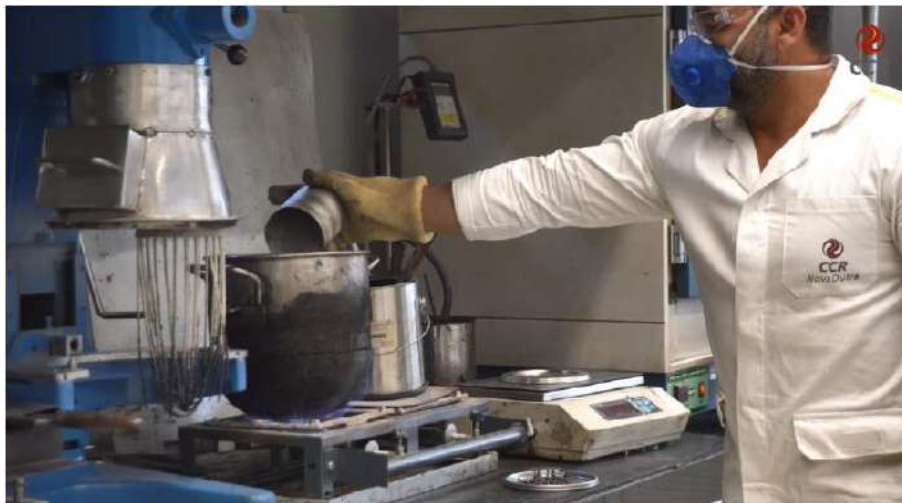
Figura 3 – Despejar os agregados previamente aquecidos no recipiente de mistura
