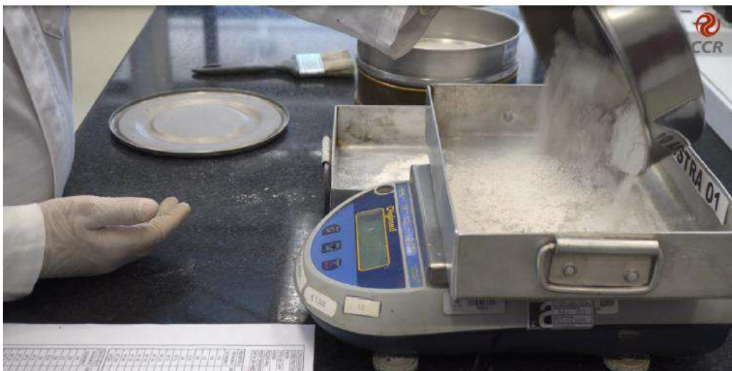
Figura 3 – Pesar a amostra de cal hidratada que passa na peneira nº 200.
