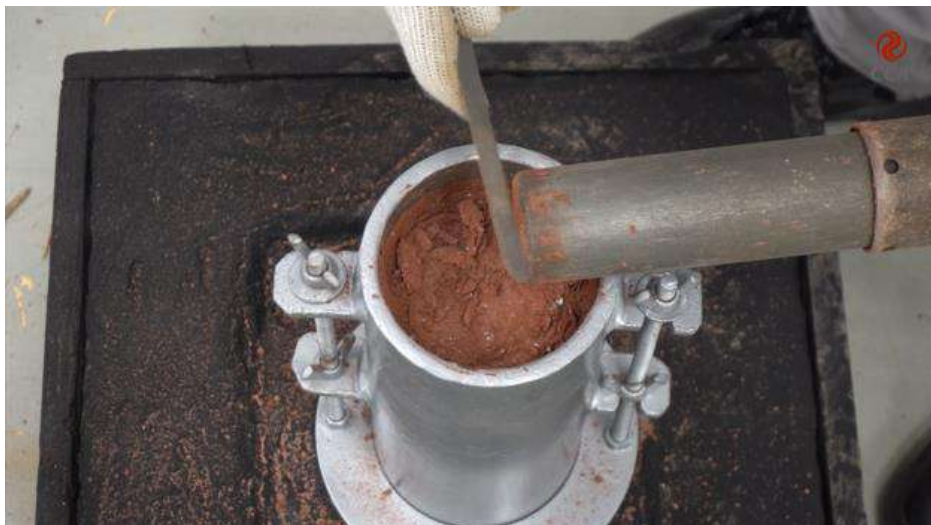
Figura 9 – Realizar a compactação da última camada na energia especificada em projeto.
