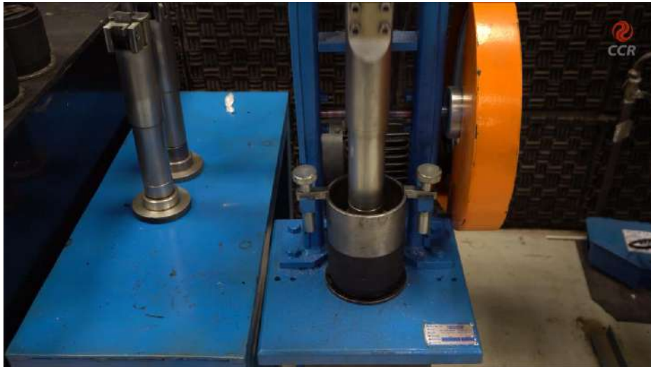
Figura 14 – Compactar a mistura asfáltica utilizando o soquete mecânico.
