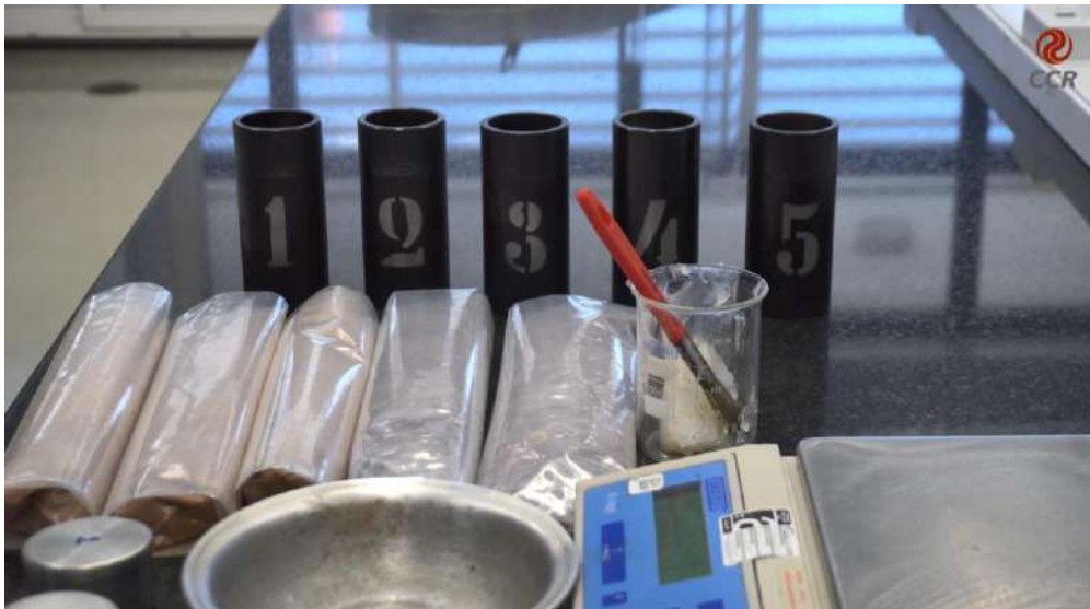
Figura 2 – Com auxílio do pincel aplicar o anti-aderente nas formas de aço.
