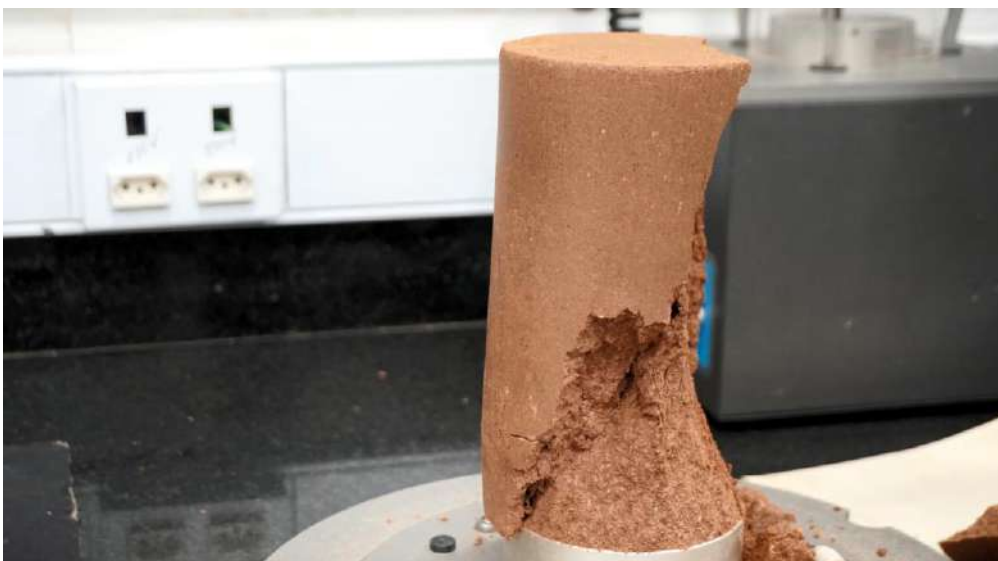
Figura 5 – Ruptura típica dos corpos de prova ensaiados.
