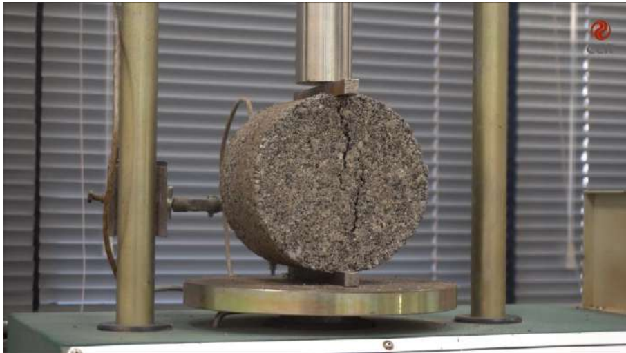
Figura 5 – Ajustar a prensa de compressão para que aplique o carregamento com crescimento constante a uma velocidade de 50 mm por minuto até a ruptura do corpo de prova, sendo 3 corpos de prova seco e 3 corpos de prova em condições úmidas.
