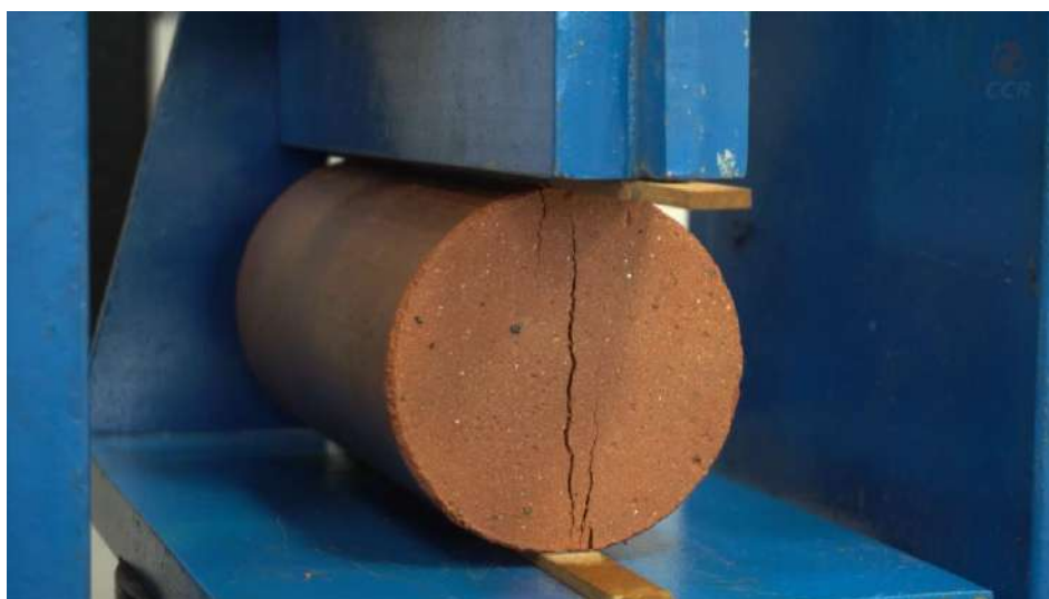
Figura 8 – Ruptura do corpo de prova.
