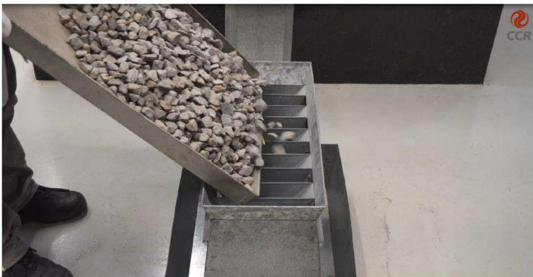
Figura 2 – Ensaio de quarteamento com agregado graúdo, divisão da amostra de agregado para obter a quantia necessária.
