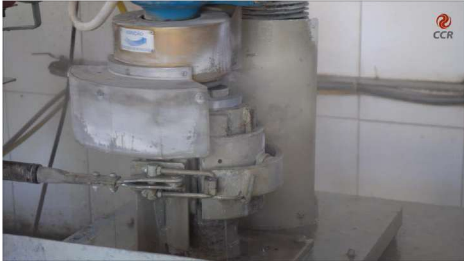
Figura 7 –Regularizar a face do corpo de prova.
