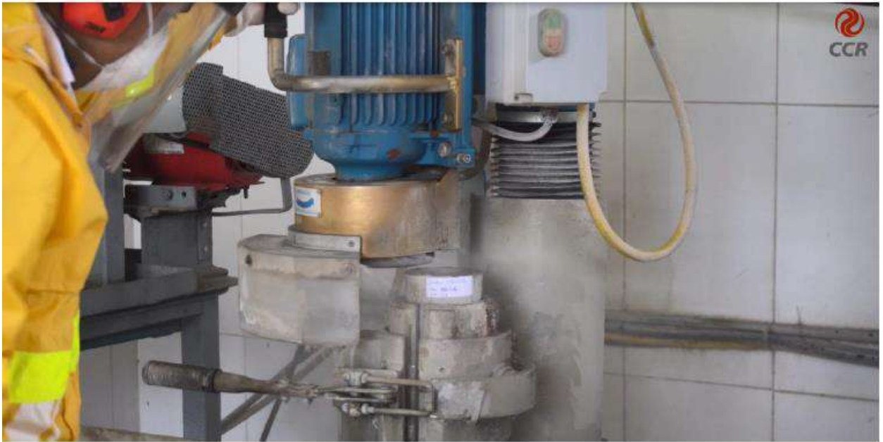
Figura 3 – Retificar os corpos de prova.
