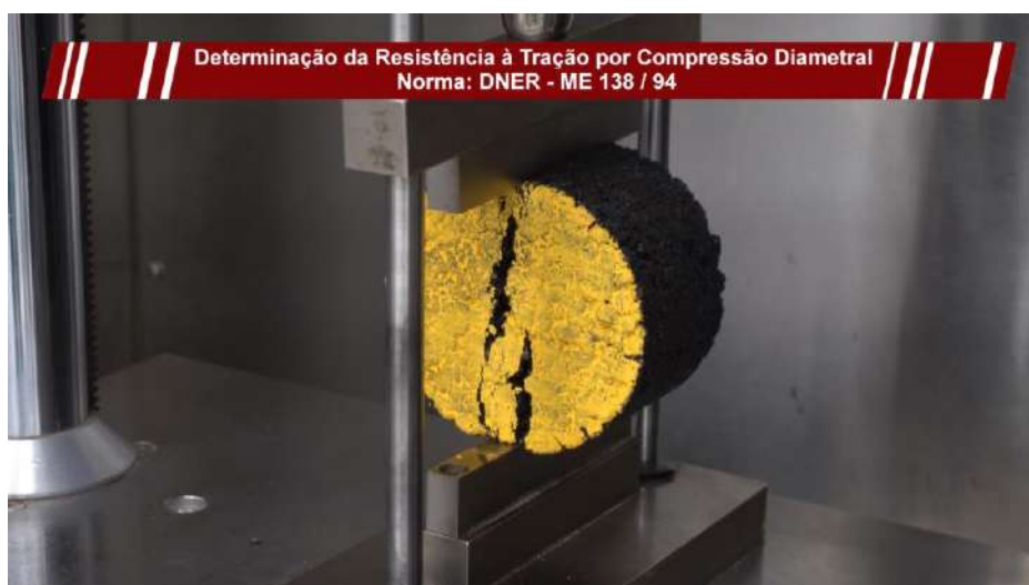
Figura 18 – Determinar a resistência à tração por compressão diametral para cada teor de ligante a 25 °C.
