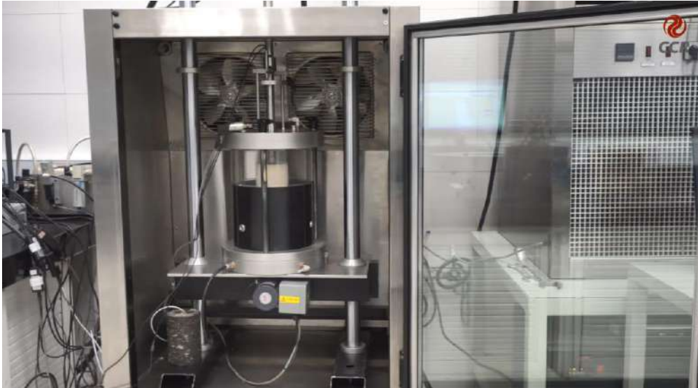
Figura 3 – Prensa universal de aplicação das tensões verticais e de confinamento.
