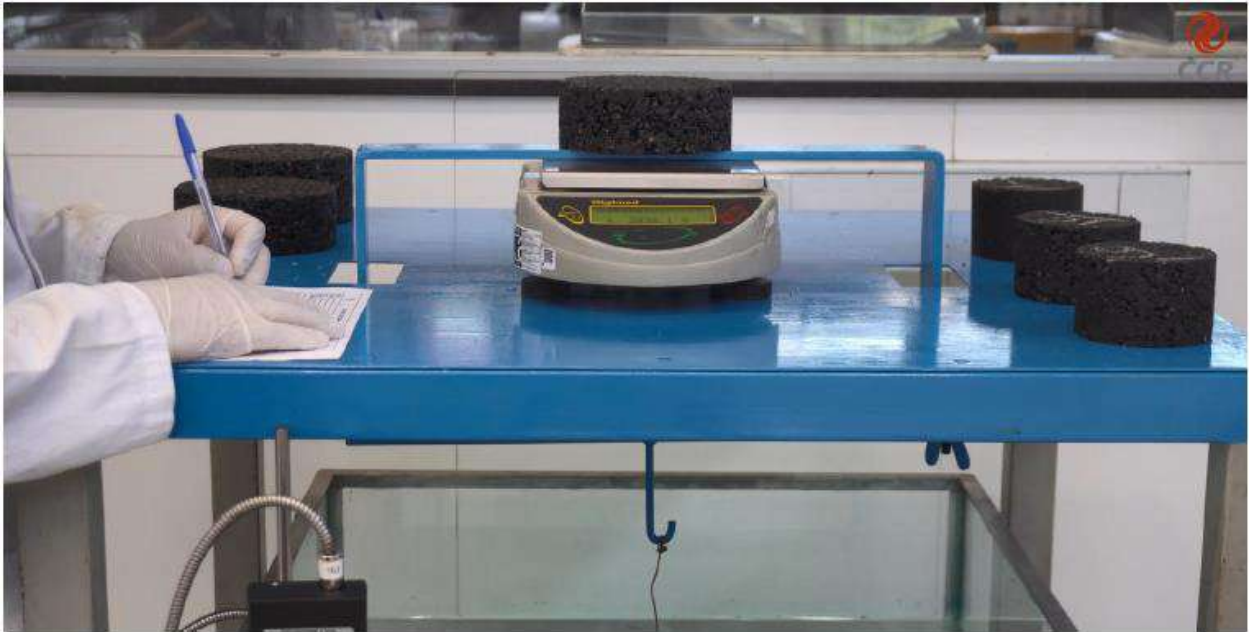
Figura 1 – Pesagem dos corpos de prova ao ar.
