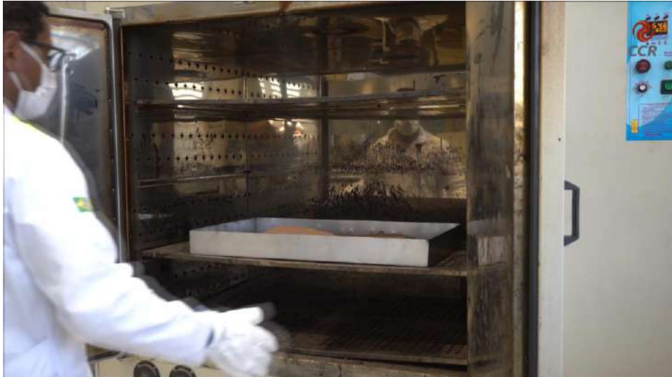
Figura 1 – Secagem do solo em estufa a 60 °C.
