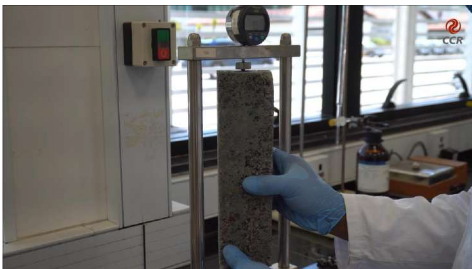
Figura 14 – Realizar a leitura do corpo de prova no equipamento medidor de comprimento a cada 24 horas por 28 dias.
