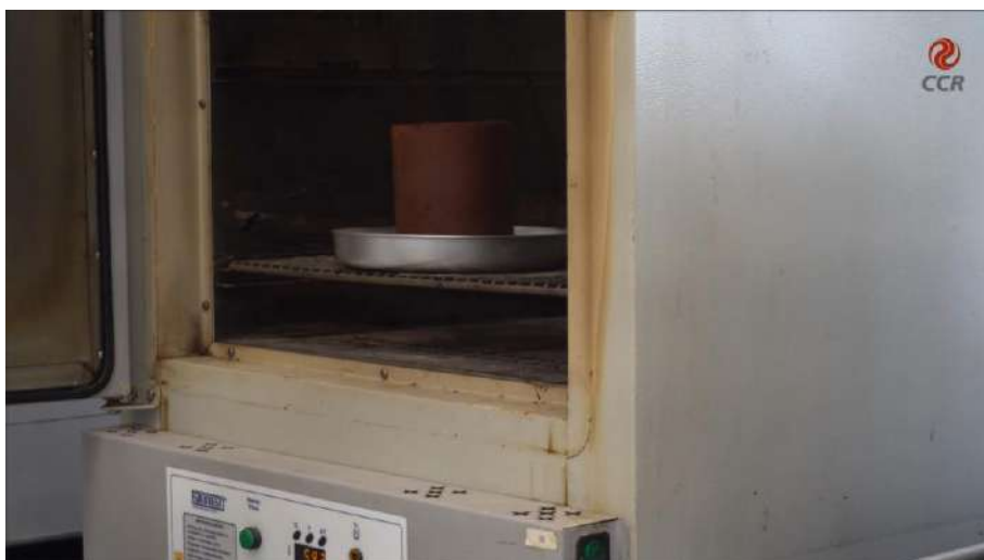
Figura 6 – Condicionar o corpo de prova para estufa por 42 horas.
