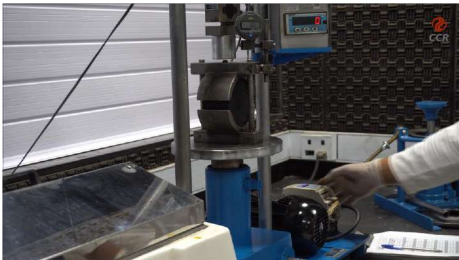
Figura 18 – Determinar a estabilidade e fluência de cada teor de ligante a 60 °C.
