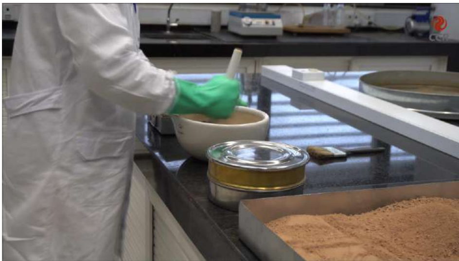
Figura 2 – Destorroar a amostra em almofariz com pilão de ponta recoberta com borracha.
