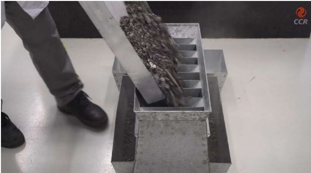
Figura 3 – Realização do processo de quarteamento do material fresado.
