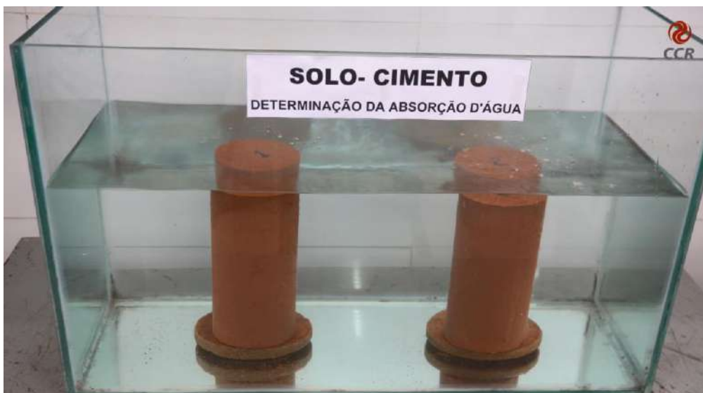
Figura 4 – Submergir os corpos de provas em água e posteriormente pesa-os.
