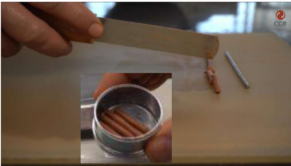
Figura 5 – Amostra cilíndrica cortada e colocada dentro da cápsula.
