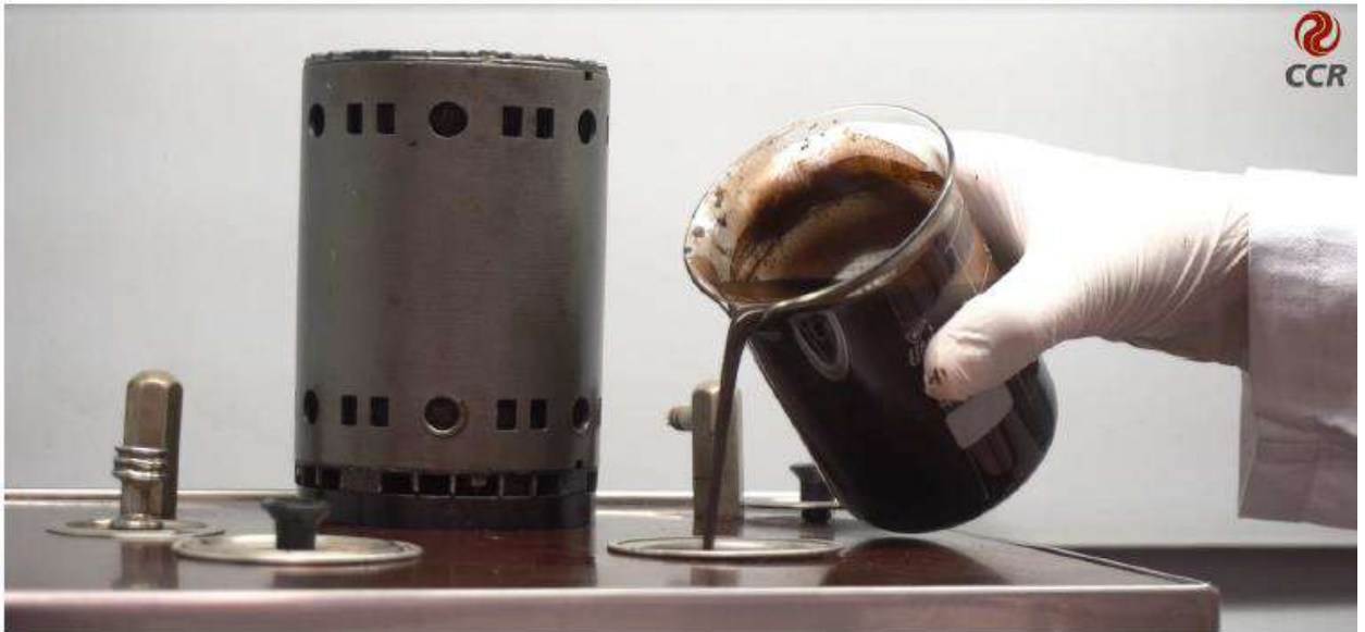
Figura 3 – Coloca-se a amostra de emulsão no reservatório específico do equipamento Saybolt Furol.
