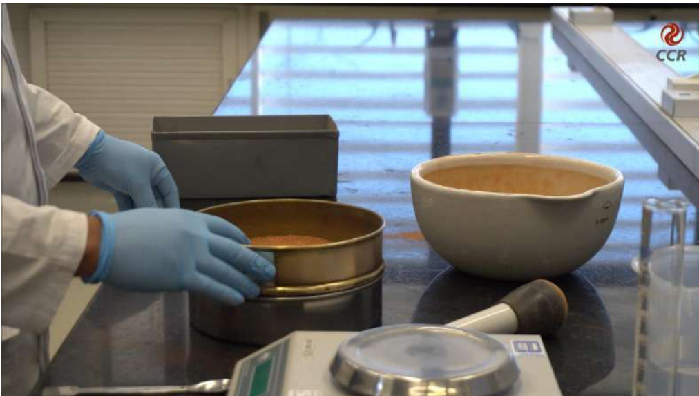
Figura 2 – Efetua-se o peneiramento da amostra de solo na peneira nº 40 (0,42 mm).
