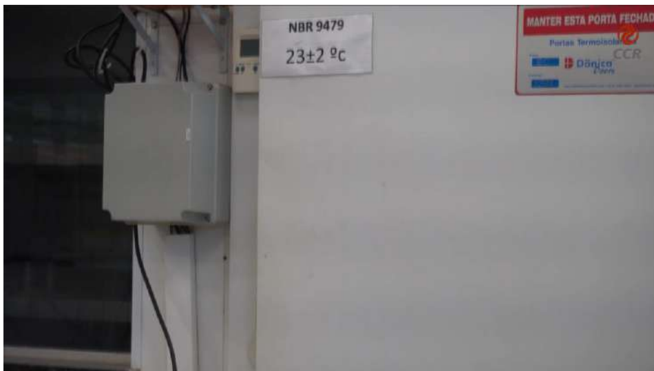
Figura 9 – Condicionar a amostra dentro da forma na câmara úmida por 72 horas.
