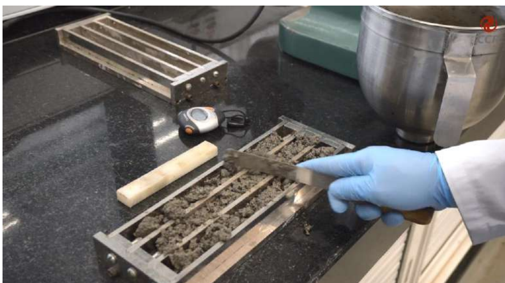
Figura 4 – Colocar a argamassa nas formas prismáticas.
