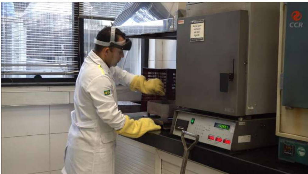
Figura 2 – Retira-se da estufa e coloca-se a amostra na vasilha metálica perfurada.
