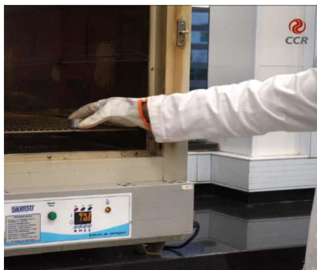
Figura 6 – Cápsula colocada na estufa para eliminar a umidade da amostra e determinar o limite de plasticidade.
