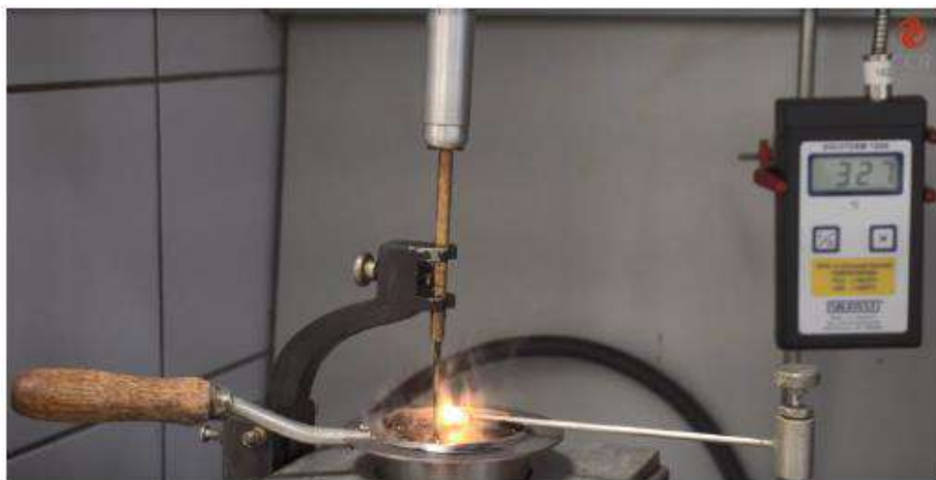
Figura 3 – Combustão da amostra de CAP.
