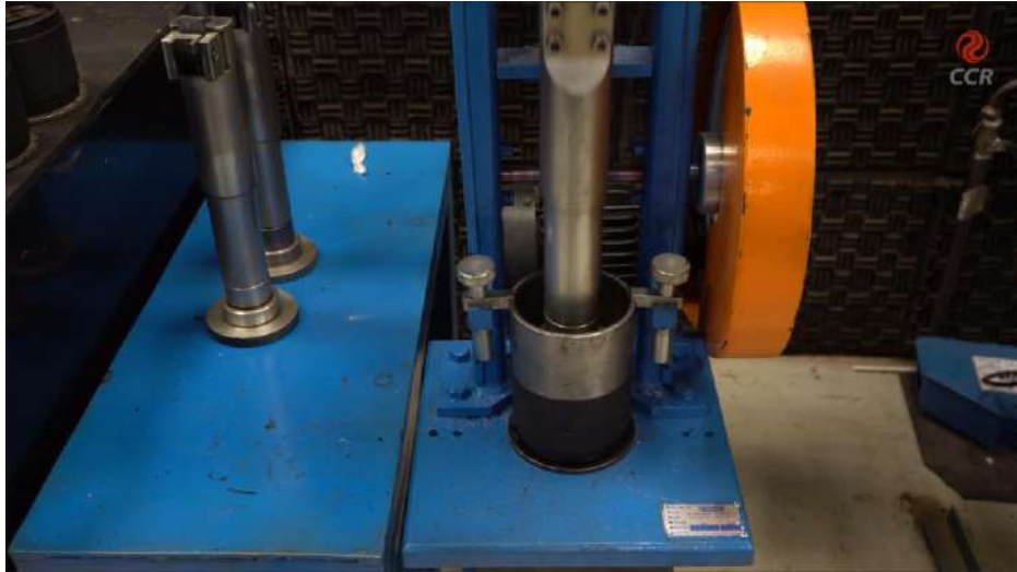
Figura 13 – Compactar a mistura asfáltica utilizando o soquete mecânico.
