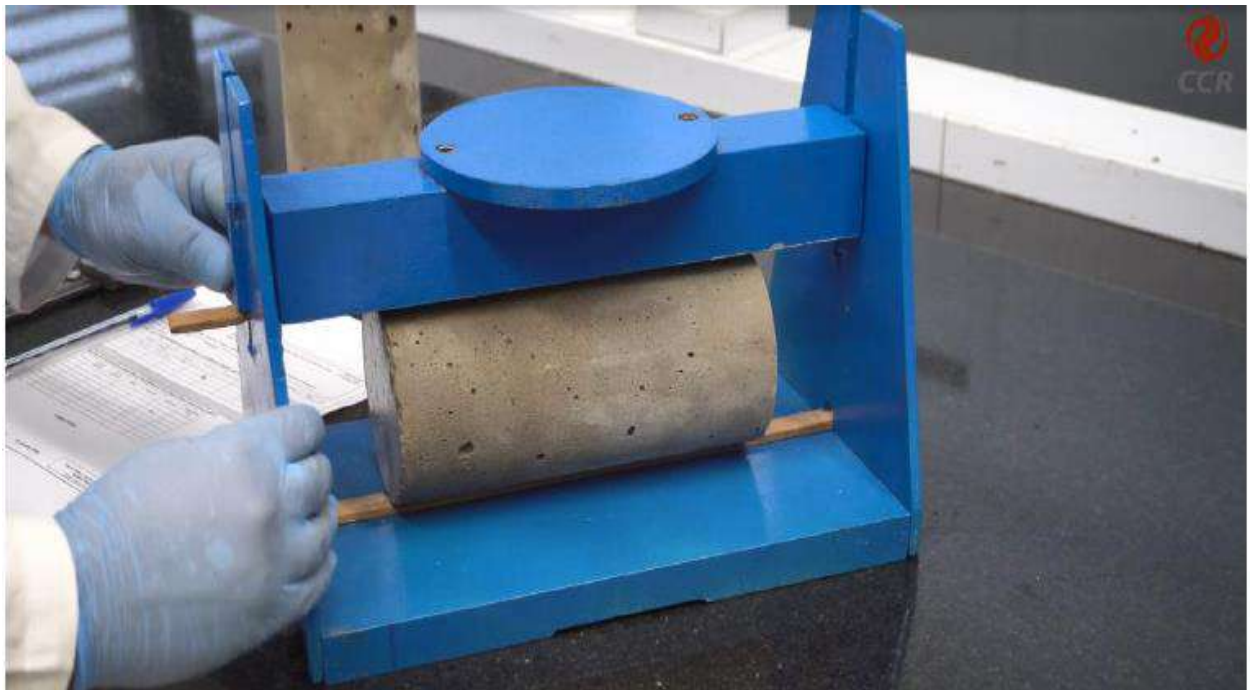
Figura 2 – Colocar o corpo de prova na prensa de compressão.
