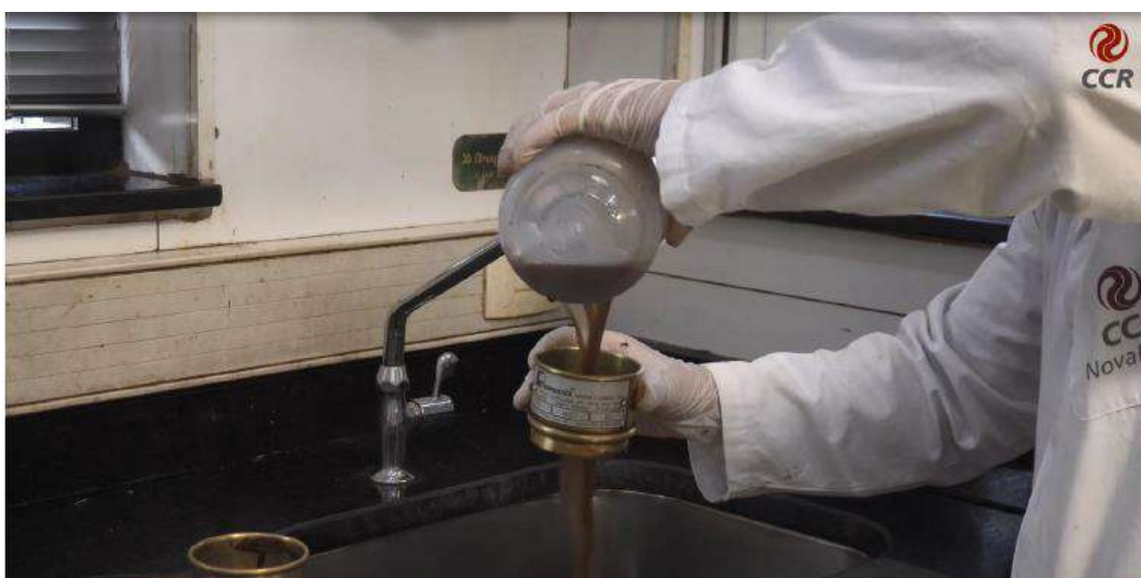
Figura 2 – Lava-se a peneira ASTM nº 20 em água corrente até uma coloração límpida.
