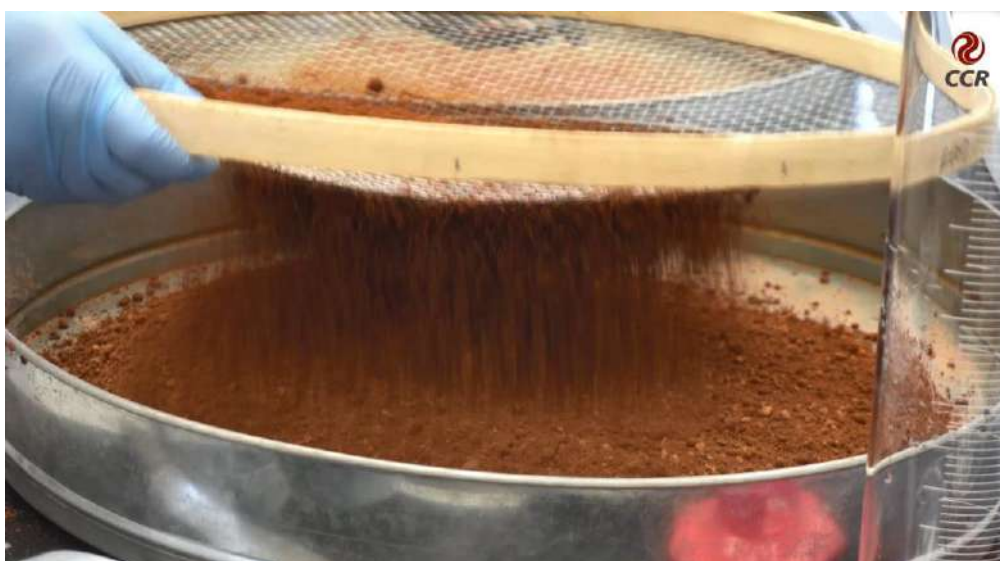
Figura 2 – Homogeneizar e peneirar o solo cimento.
