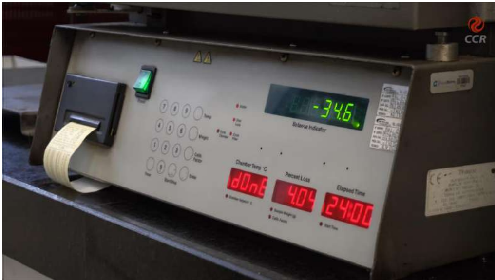
Figura 4 – Verifica-se o teor de ligante através do equipamento.
