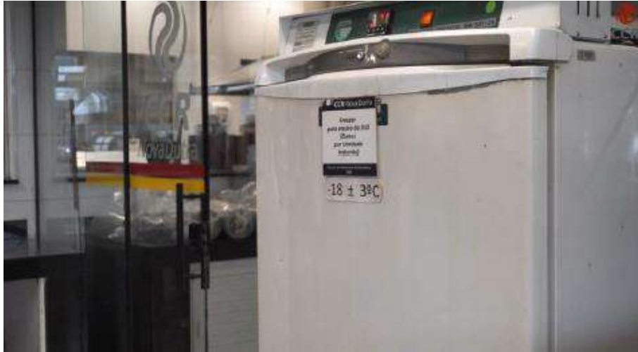
Figura 4 – Levar o corpo de prova para o congelador na temperatura de -18 \pm 3 \text{ }^\circ\text{C}
