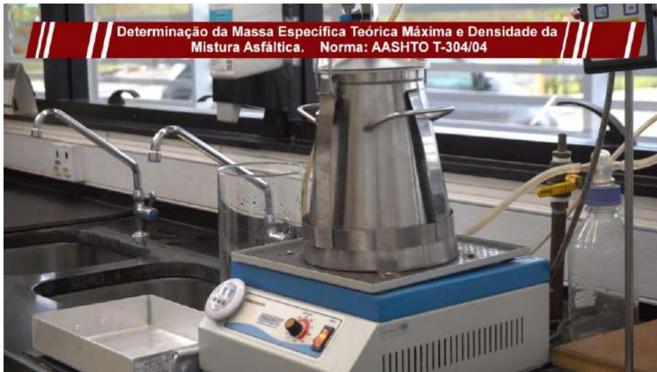
Figura 17 – Determinar a densidade máxima teórica referente a cada teor de ligante.
