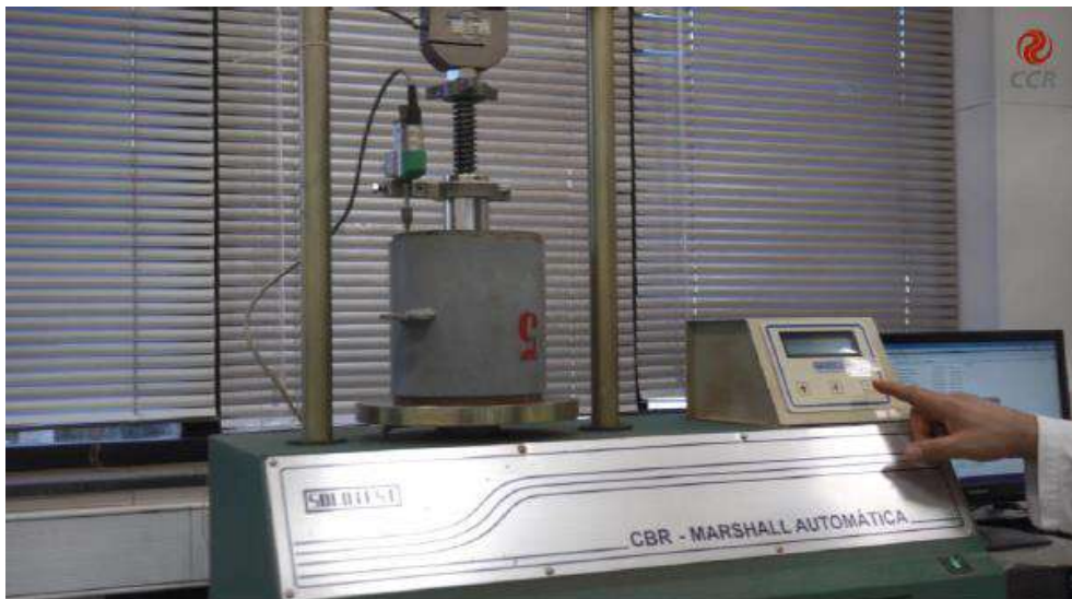
Figura 5 – Aplicar o carregamento de 1,27 mm/minuto, até a ruptura por cisalhamento do solo.
