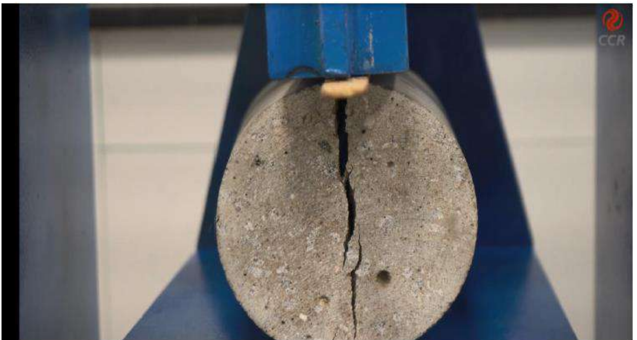
Figura 4 – Ruptura do corpo de prova finalizada.
