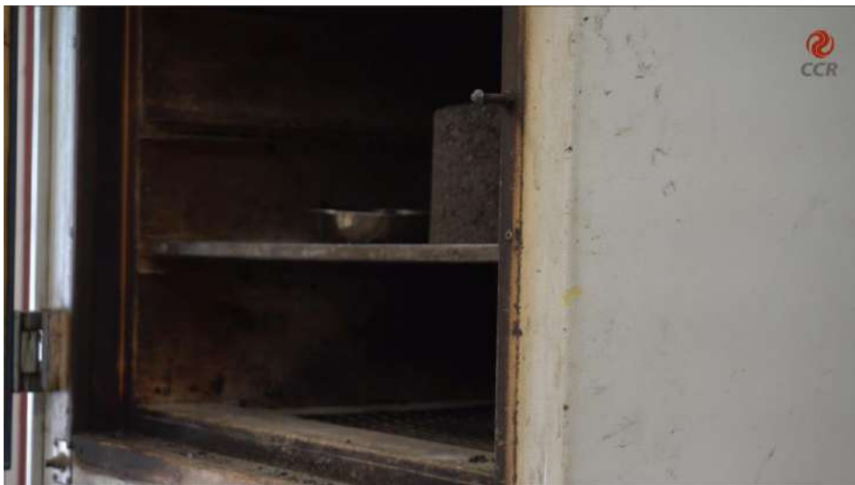
Figura 11 – Pesar e medir os corpos de prova e levá-los para a estufa, onde devem ser mantidos por 72 horas.
