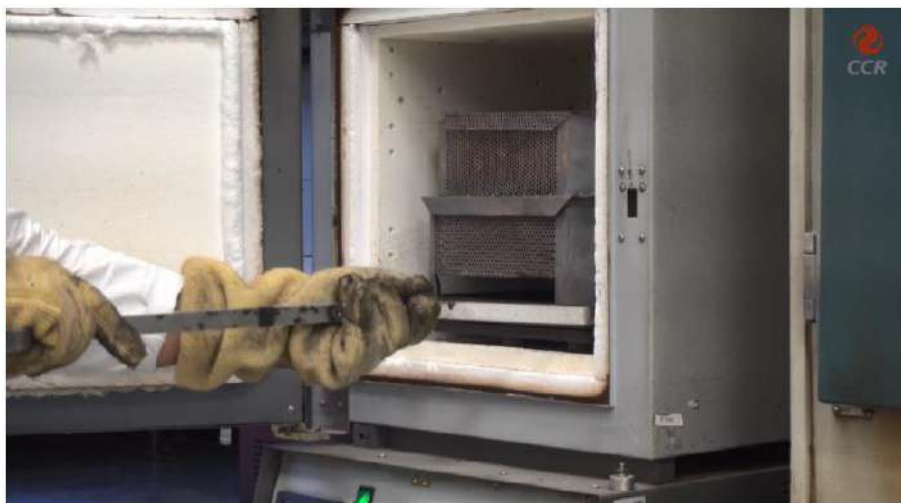
Figura 6 – Proceder à extração do betume por combustão em forno de alta temperatura.
