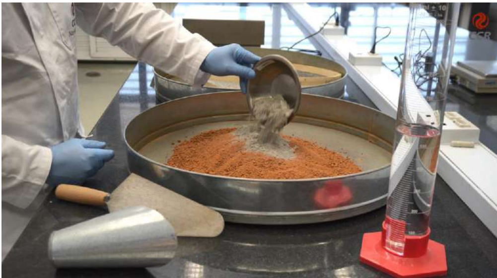
Figura 1 – Adicionar 4% em peso o cimento.
