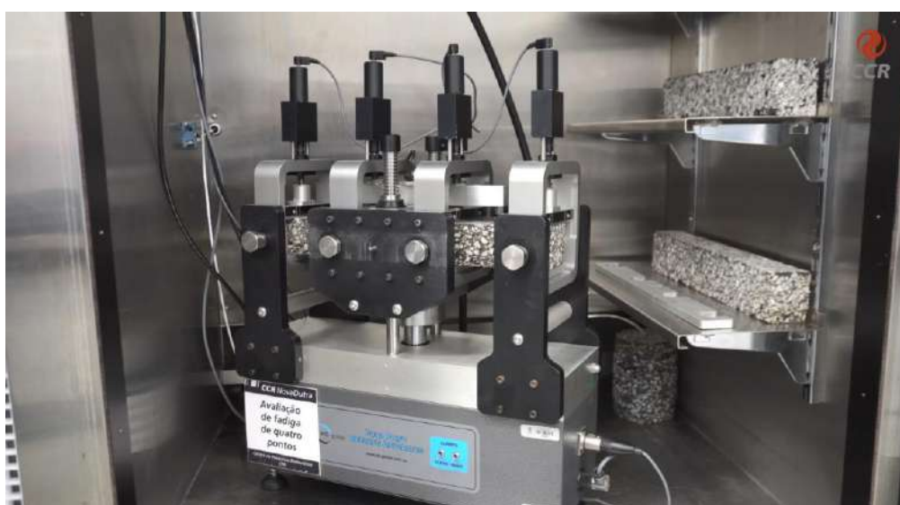
Figura 4 – Realização do ensaio no equipamento de fadiga.
