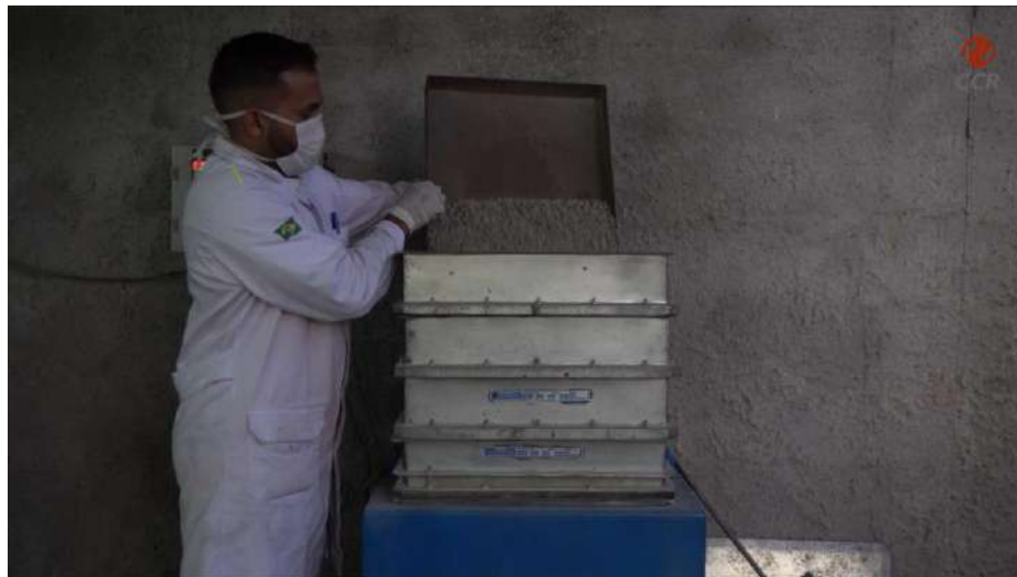
Figura 8 – Realizar o peneiramento total para a composição da dosagem para cinco teores de asfalto.
