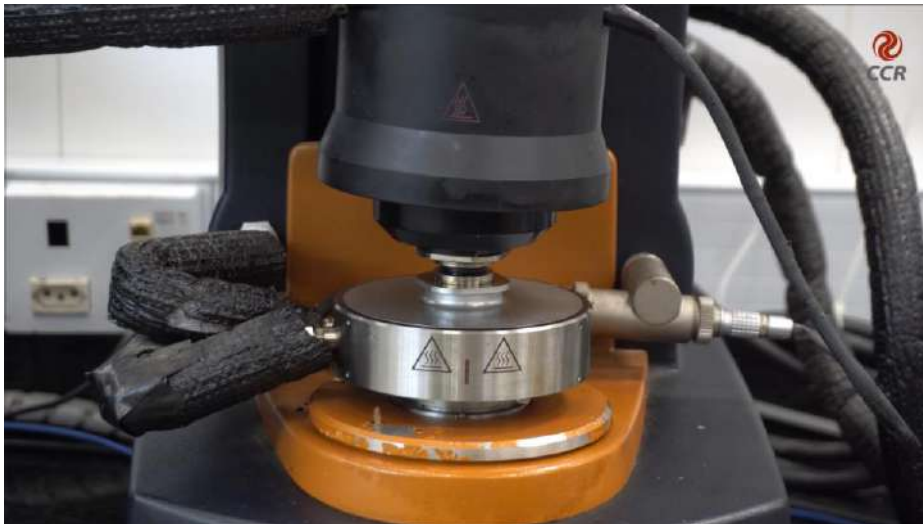
Figura 5 – Realização do ensaio com a amostra de 25 mm na varredura alta.
