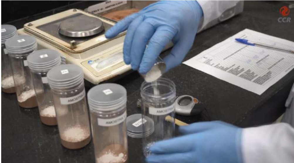
Figura 3 – Adicionar a cal ao solo com incrementos de 2%.
