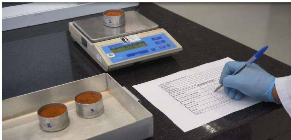
Figura 3 – Pesa-se as cápsulas iniciais para determinação da umidade.
