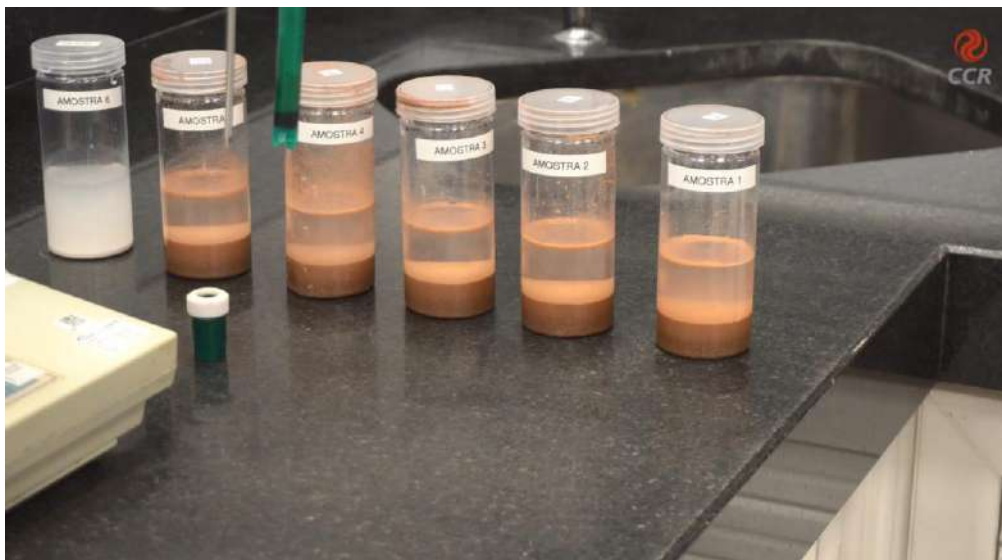
Figura 4 – Após mexer água, solo e cal deixar em repouso.
