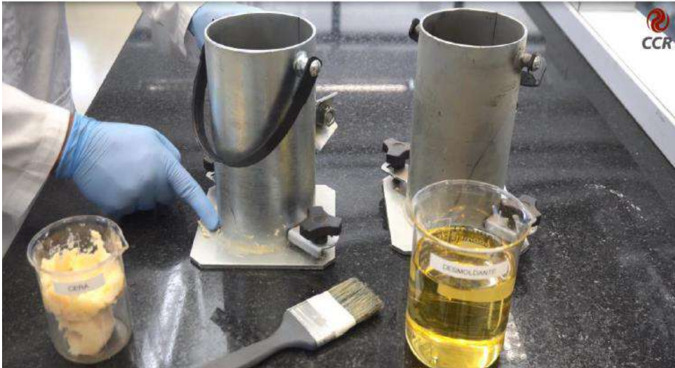
Figura 1 – Colocar a cera na base do molde.
