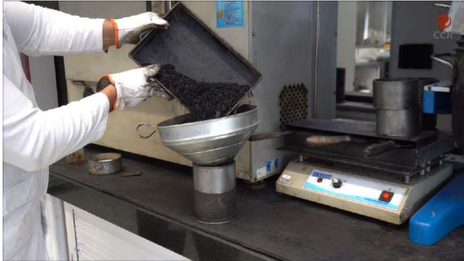
Figura 13 – Colocar a mistura asfáltica no cilindro de aço para realizar a compactação.
