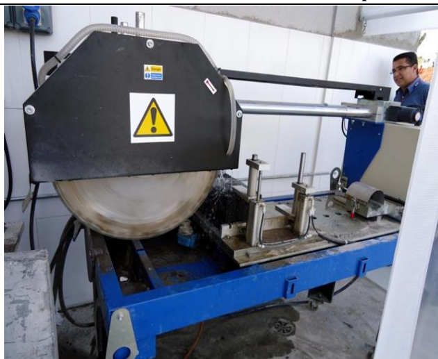
Figura 3.19: AutoSaw utilizada para serragem dos corpos de prova prismáticos e obtenção das vigotas para o ensaio de flexão de viga apoiada em quatro pontos
