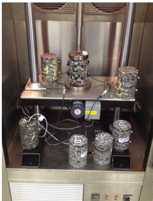
Figura 3.23: Equipamento utilizado para execução do ensaio de módulo dinâmico
