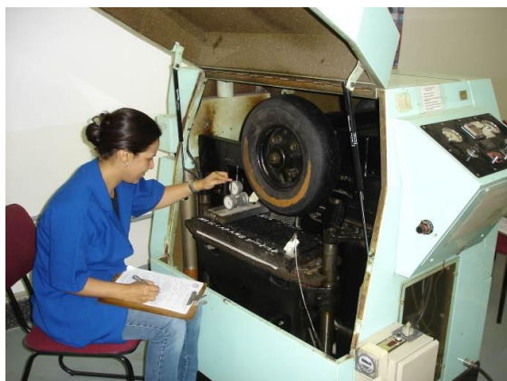
Figura 3.15: Medida de afundamento no simulador de tráfego LCPC do LTP-PTR-EPUSP
