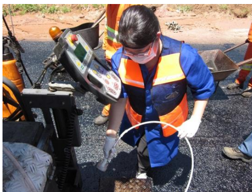
Figura 3.7: Exemplo de amostragem de emissões na pista, próximo à traseira da vibroacabadora
