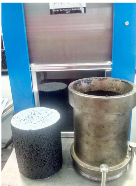
Figura 3.21: Compactação dos corpos de prova de 15cm de diâmetro no compactador giratório SUPERPAVE (CGS) para execução do ensaio de módulo dinâmico
