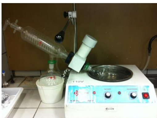
Figura 3.10: Redução da amostra após extração em evaporador rotativo
