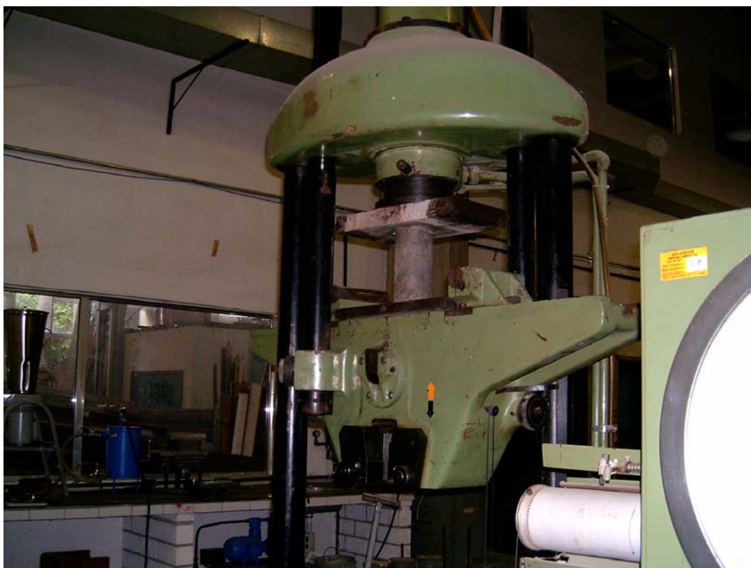
Figura 3.2.1 –Equipamento para ensaio de compressão axial – LEM-USP
