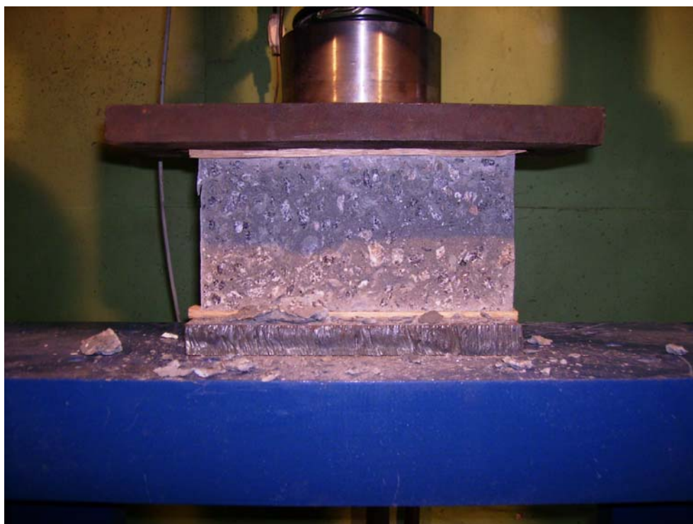
Figura 3.3.2 – Ruptura do CP no Ensaio de Compressão Diametral, LSE
