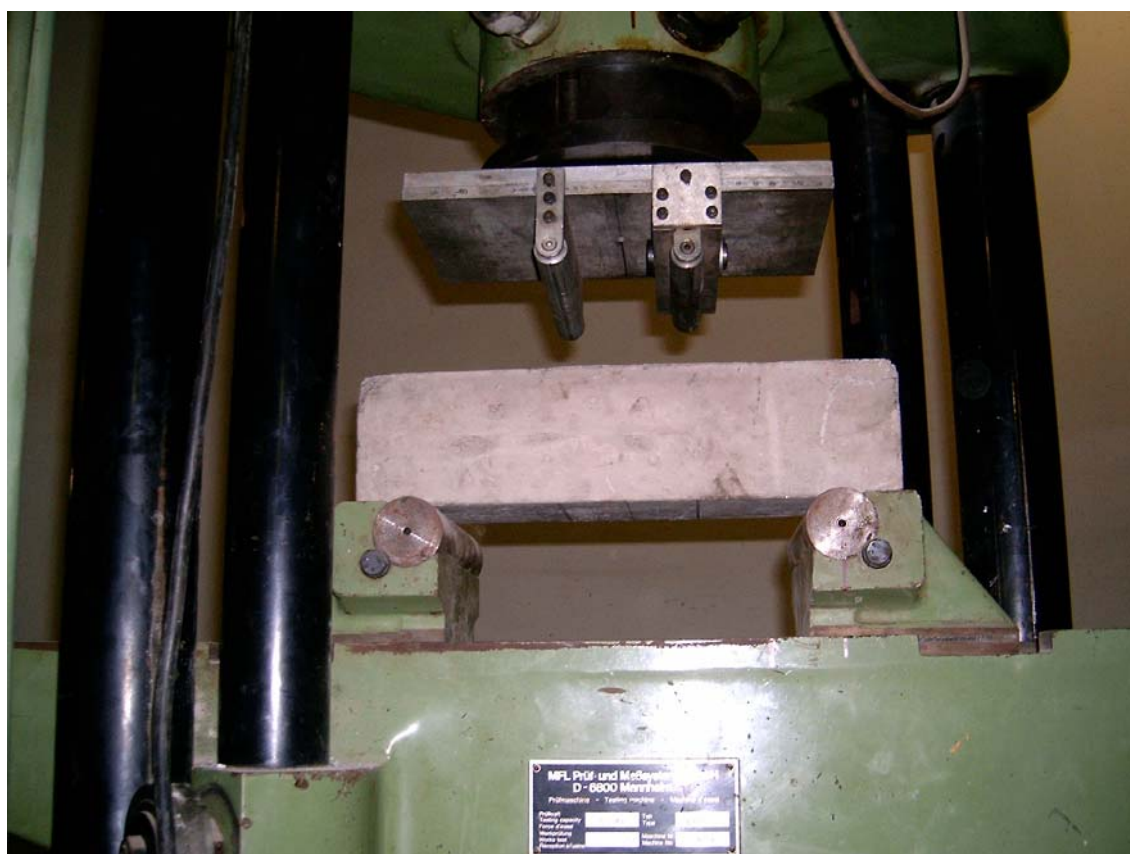
Figura 3.5.1 – Arranjo de Ensaio de Flexão, LEM-USP
