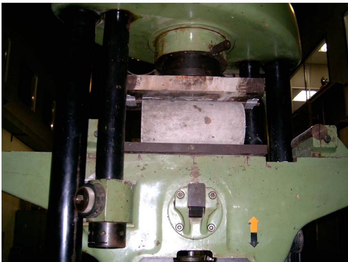
Figura 3.3.1 – Realização do Ensaio de Compressão Diametral no LEM
