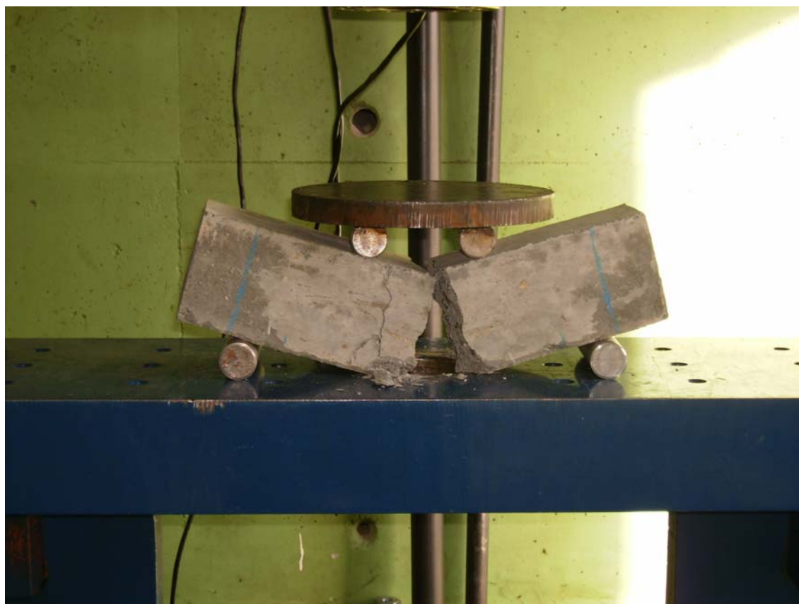
Figura 3.5.2 – Arranjo de ensaio de flexão simples, LSE
