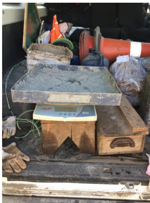
Figura 27 - Distribuição de cimento e verificação da taxa
