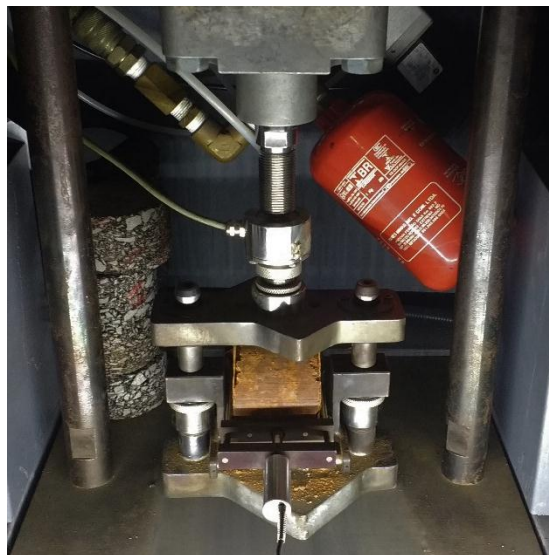
Figura 5: Configuração do ensaio de MRD
