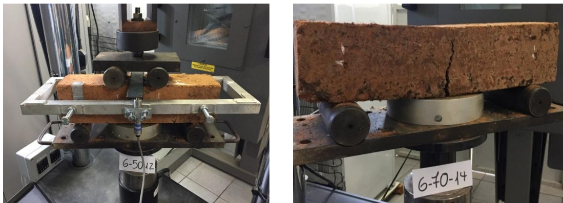
Figura 9: Configuração do ensaio de RTF
