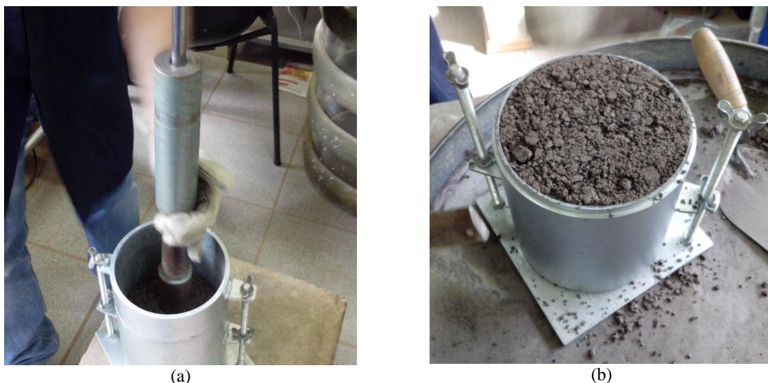
Figura 9 Ensaio de compactação: (a) processo de compactação de uma das camadas e (b) aparência da mistura de código 6-20-INT com teor de umidade igual a 8% após compactação
