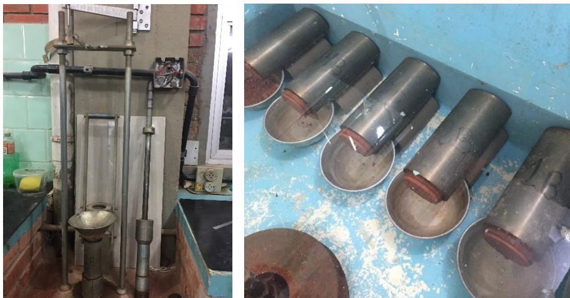
Figura 1: Equipamentos do ensaio de compactação mini-MCV e corpos de prova durante o ensaio de perda de massa por imersão
