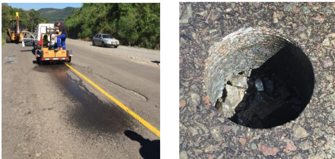
Figura 22 - Extração de testemunhos da camada asfáltica do trecho experimental
