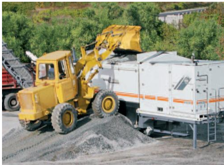
Figura 9 Usina de reciclagem a frio para realização do processo com adição de cimento (modelo Wirtgen KMA 200) (fonte: Wirtgen, 2007)
