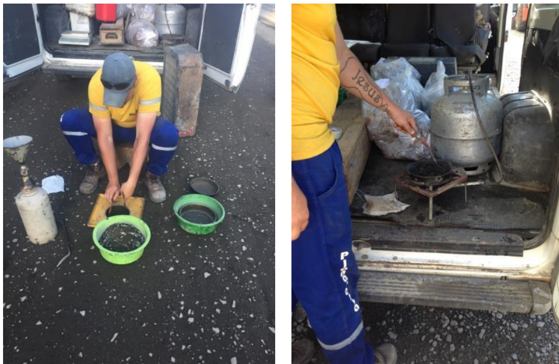
Figura 32 - Métodos do frasco de areia e da frigideira empregados na camada reciclada
