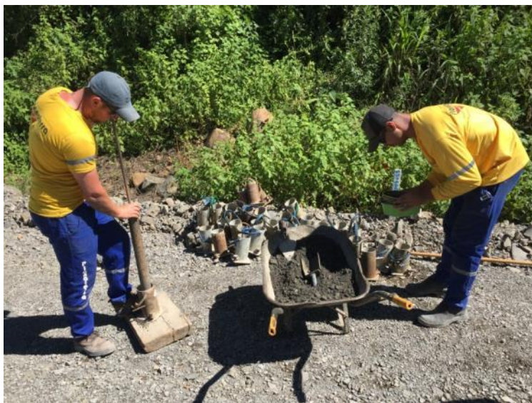
Figura 29 - Moldagem de CPs para controle de resistência da camada reciclada
