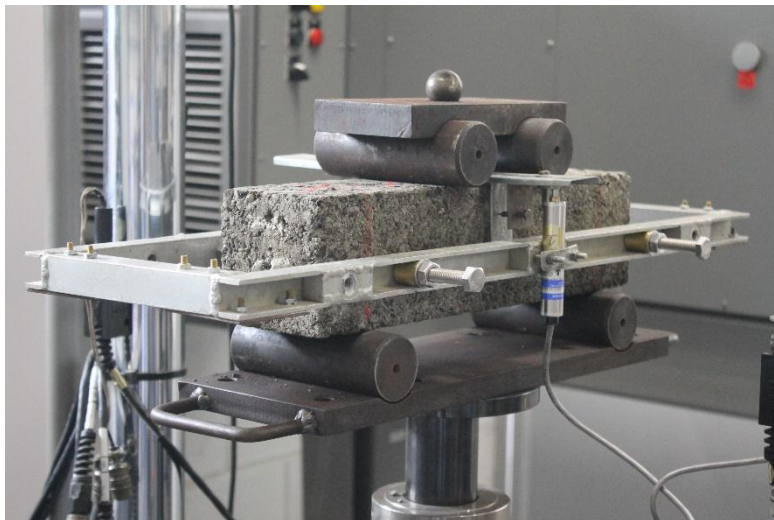
Figura 13. Configuração do ensaio do ensaio RTF em viga quatro pontos
