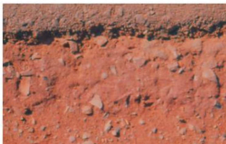
Figura 5 Corte de pavimento com base de solo lateríticos (contaminada com agregados pétreos) e revestimento em concreto asfáltico
