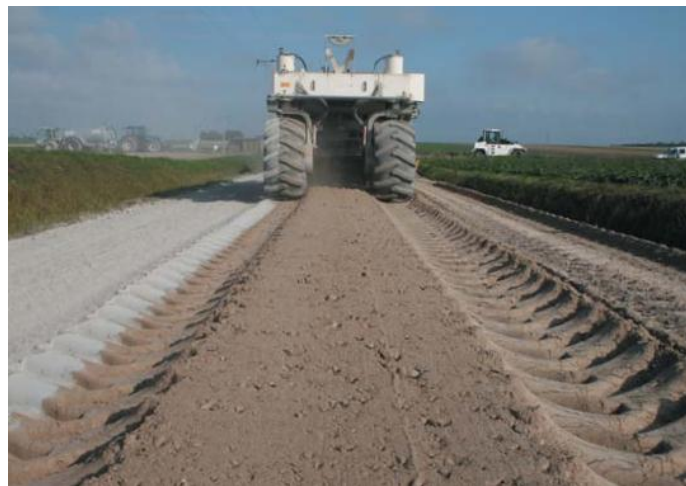
Figura 5 Equipamento para reciclagem ou estabilização em ação
