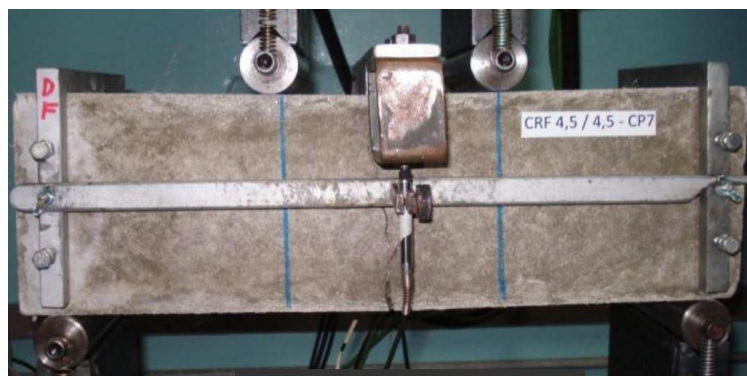
Figura 3. Esquema representativo do ensaio segundo JSCE-SF4 (1984) (SALVADOR, 2013)
