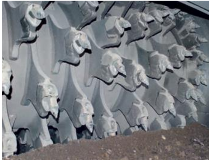
Figura 6 Cilindro e bits de corte de uma recicladora (fonte: Wirtgen, 2007)
