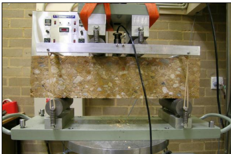
Figura 8. Dispositivo de flexão (AUSTROADS, 2008)
