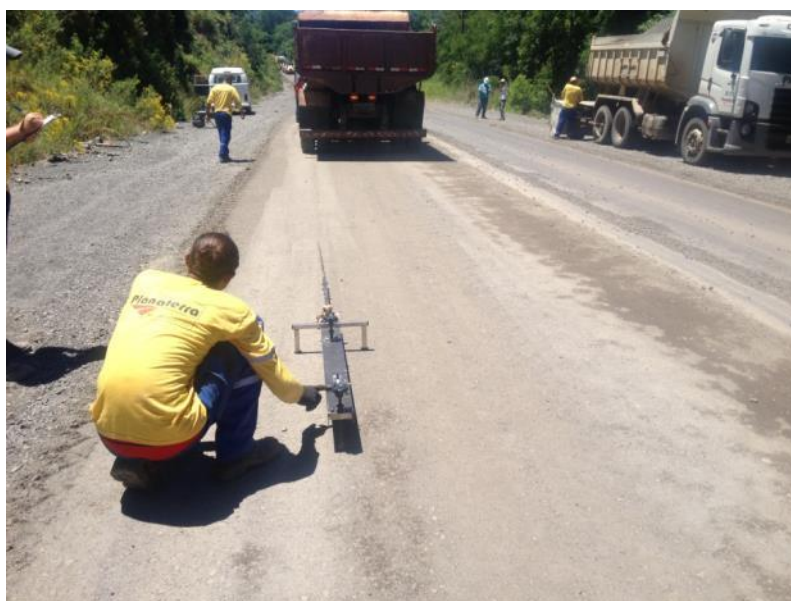
Figura 33 - Levantamento deflectométrico da camada reciclada após compactação
