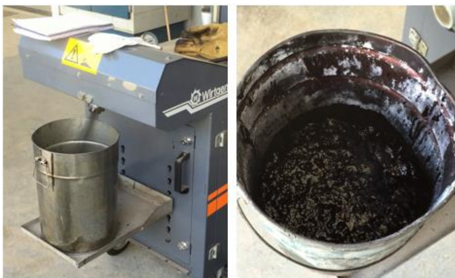
Figura 2.8: Detalhe da formação de espuma de asfalto no WLB 10S
