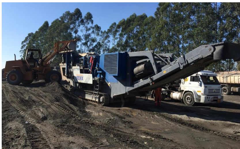
Figura 5.2: Britador móvel utilizado para britar o material fresado do km 156 SP/PN
