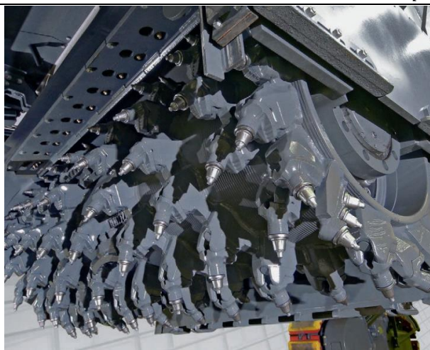
Figura 2.2: Detalhe dos “bits” ou dentes de corte fixados no tambor fresador. FONTE:
