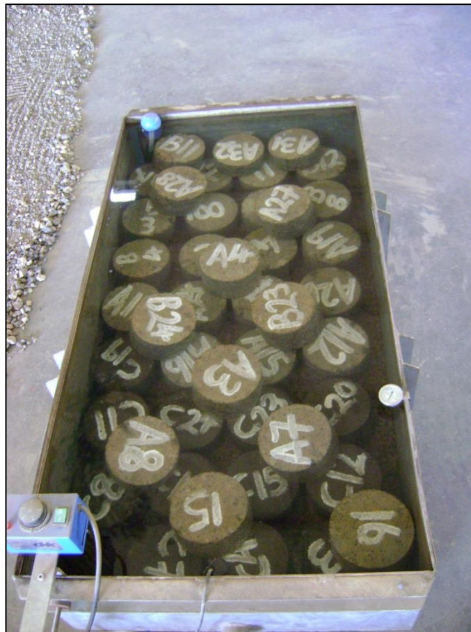
Figura 2.16: Imersão em água dos corpos de prova de material reciclado estabilizados com espuma de asfalto. FONTE: Van Niekerk (2016)
