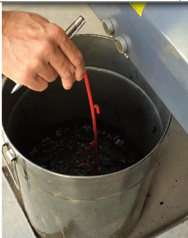
Figura 2.9: Aferição da taxa de expansão e meia vida da espuma de asfalto
