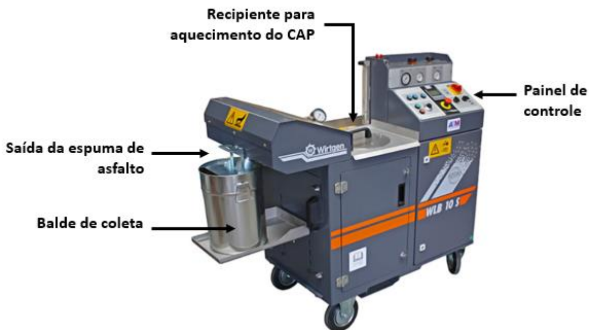
Figura 2.7: Equipamento Wirtgen WLB 10S para produzir em laboratório a espuma de asfalto
