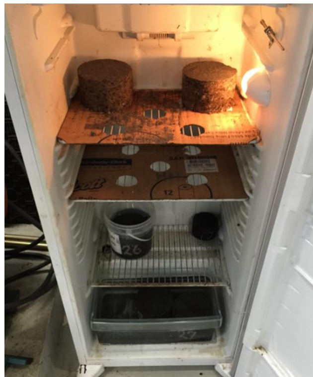
Figura 3.4: Cura dos CPs com espuma de asfalto em estufa ventilada
