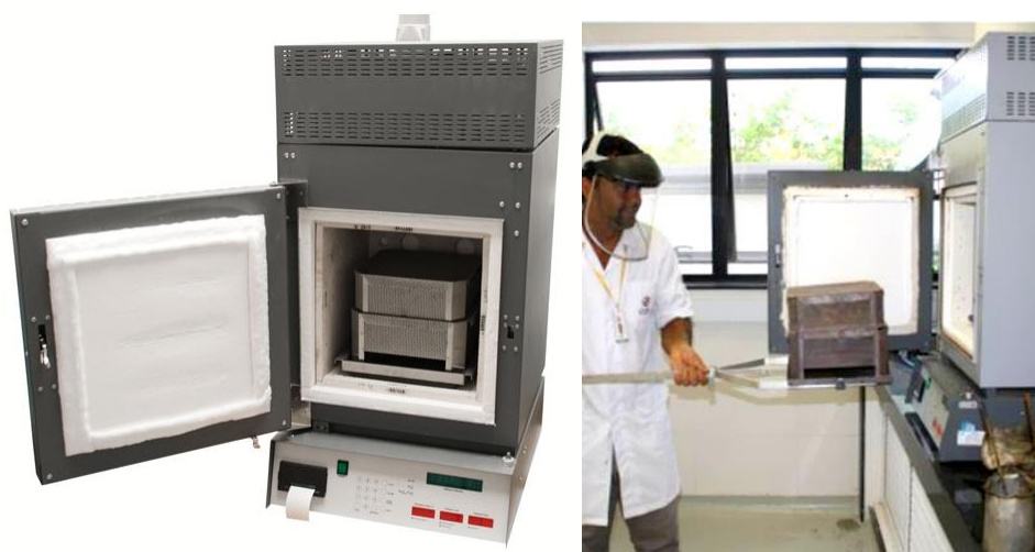
Figura 4.3: Forno de ignição utilizado para determinação do teor residual e asfalto
