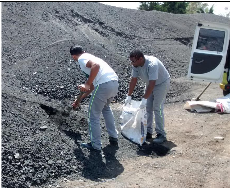
Figura 3.1: Coleta do material fresado em depósito de armazenamento da CCR NovaDutra
