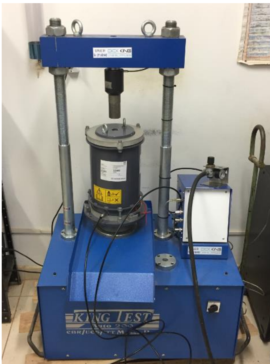
Figura 3.8: Equipamento para execução do ensaio triaxial utilizado na COPAVEL LTDA.
