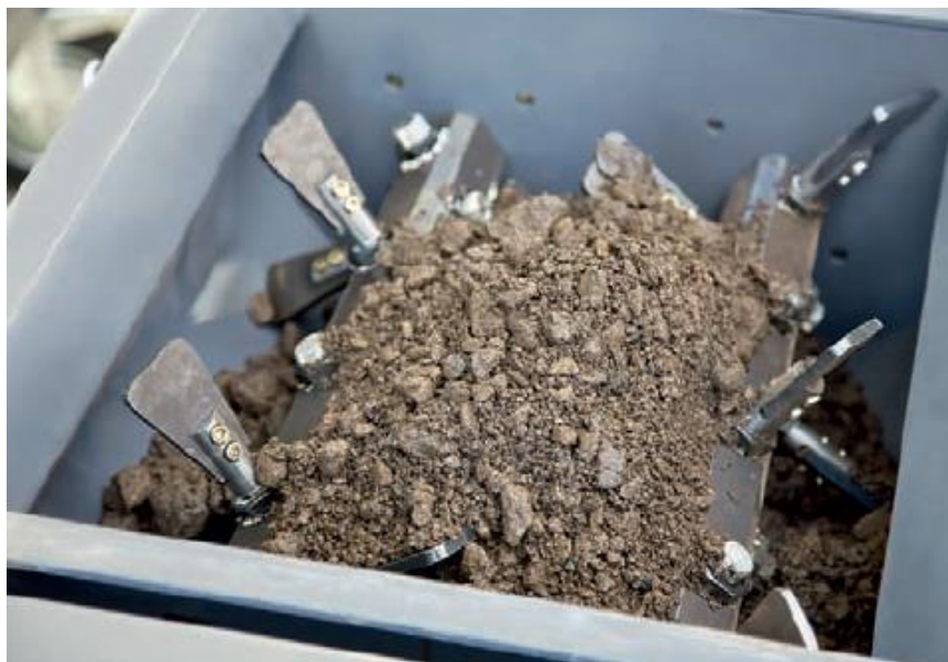
Figura 2.15: Material fresado após homogeneização com materiais novos, água e espuma de asfalto. FONTE: Wirtgen (2012)
