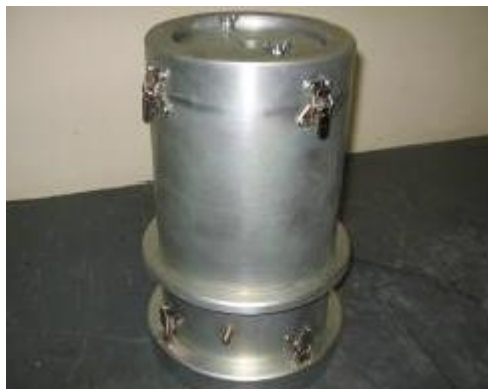
Figura 2.23: Câmara de metal para aplicação da tensão de confinamento no corpo de prova. FONTE: Mulasa (2009)
