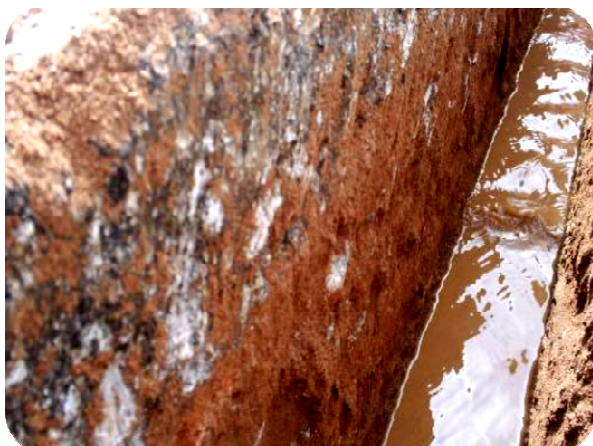
Figura 3.12 – Topo do subleito saturado Perfil longitudinal da Faixa 2
