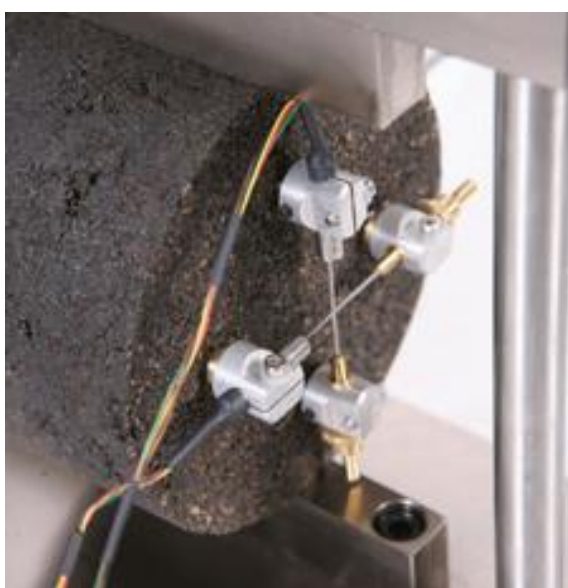
Figura 2.11: Aquisição dos deslocamentos horizontais e verticais durante o ensaio de módulo de resiliência. FONTE: IPC Global (2015)
