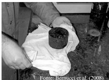
Figura 4. Pesagem hidrostática para determinação da habilidade de compactação
