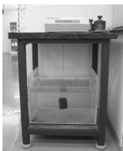
Figura 4. Pesagem hidrostática para determinação da habilidade de compactação
