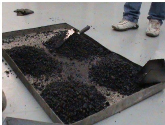
Figura 26. Quarteamento da massa asfáltica morna da usina, em laboratório
