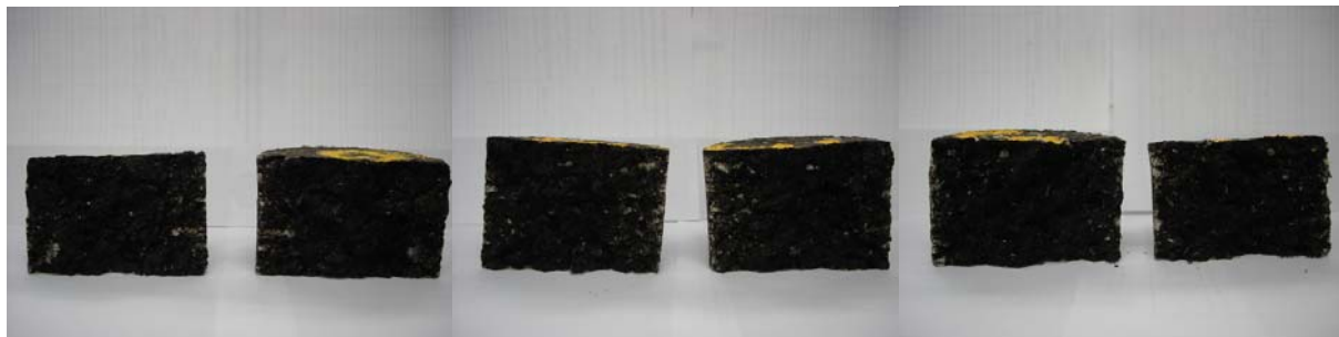
Figura 35. Corpos-de-prova da pista rompidos por compressão diametral
