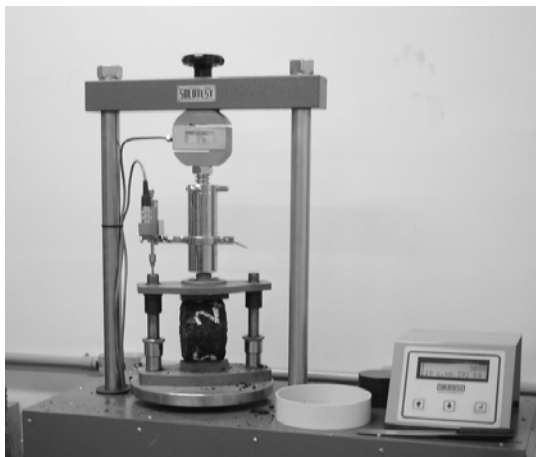
Figura 7. Ensaio de resistência à tração por compressão diametral
