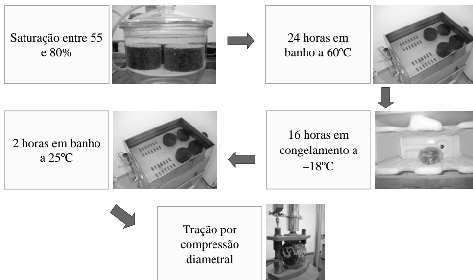
Figura 8. Condicionamento no ensaio de dano por umidade induzida
