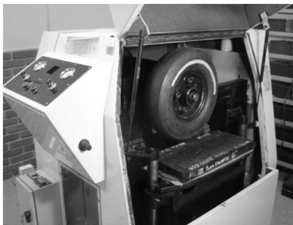
Figura 6. Simulador de tráfego francês do LTP-EPUSP
