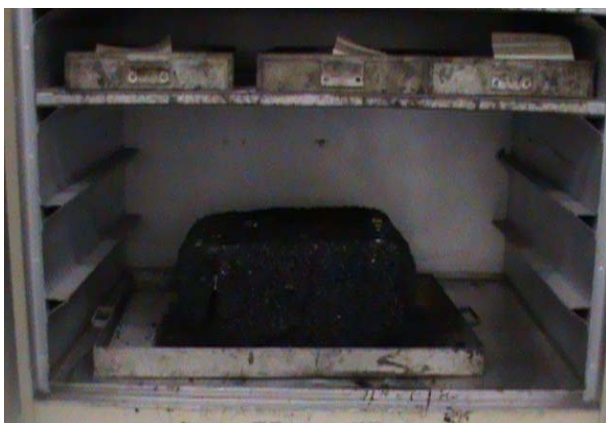
Figura 25. Amostra vinda da usina submetida à estufa em laboratório
