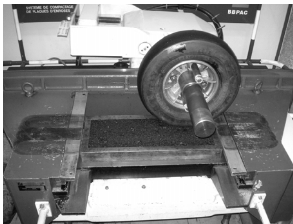
Figura 5. Compactação na mesa compactadora francesa do LTP-EPUSP
