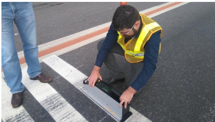
Figura 20 – Medição da retrorefletividade com o uso de retrorrefletômetro horizontal
