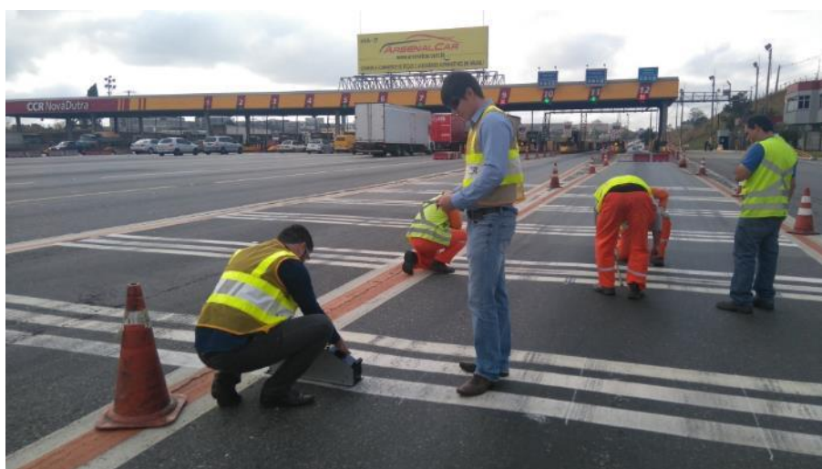
Figura 19 – Medição da retrorefletividade com o uso de retrorefletômetro horizontal
