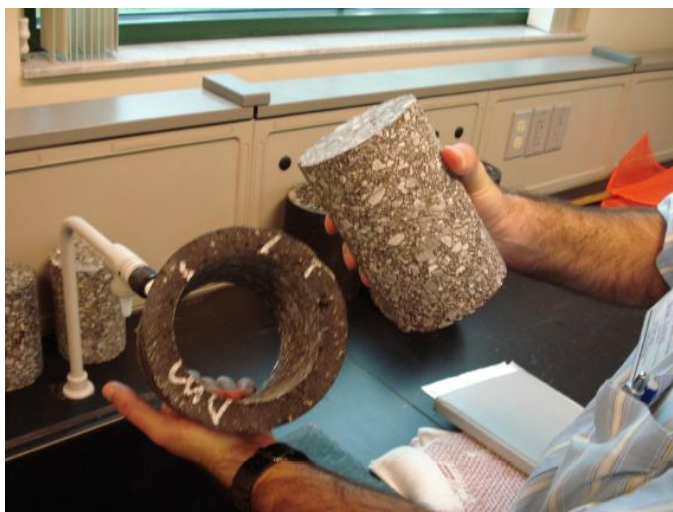
Figura3.22: Extração dos núcleos com 10cm de diâmetro dos corpos de prova
