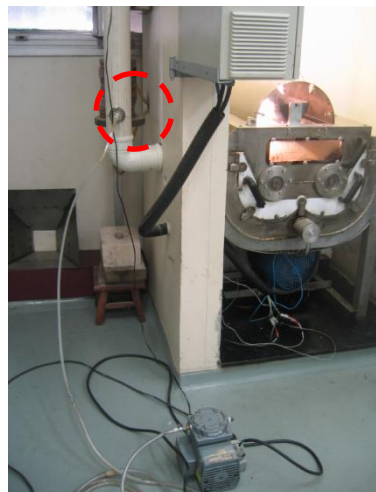
Figura 3.5: Misturadora do LTP-PTR-EPUSP (destaque para a saída lateral e para o holder acoplado)
