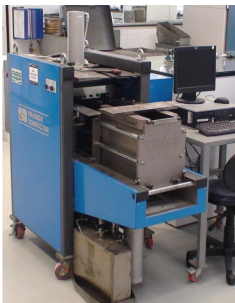
Figura 3.18: Compactador tipo PResBOX utilizado para moldar os corpos de prova
