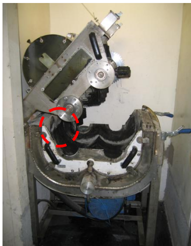
Figura 3.5: Misturadora do LTP-PTR-EPUSP (destaque para a saída lateral e para o holder acoplado)
