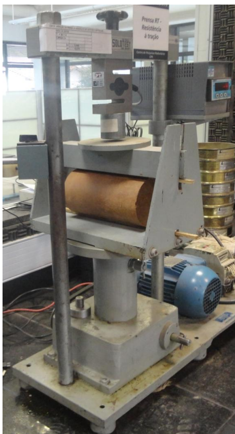
Figura 4.8: Ilustração do ensaio de RT, de acordo com a recomendação da norma DNER-ME 181/94
