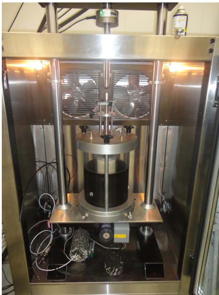
Figura 4.10: Ilustração da prensa universal (UTM-25) utilizada no ensaio de compressão triaxial cíclica
