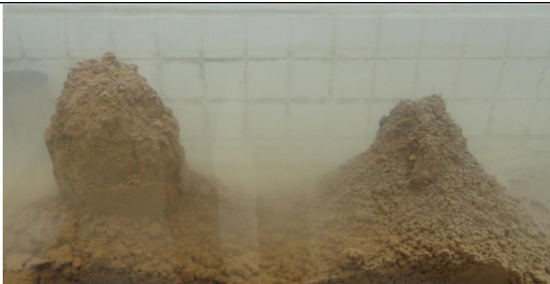
Figura 4.6: Desintegração dos corpos de prova de solo cal poucas horas após imersão em água
