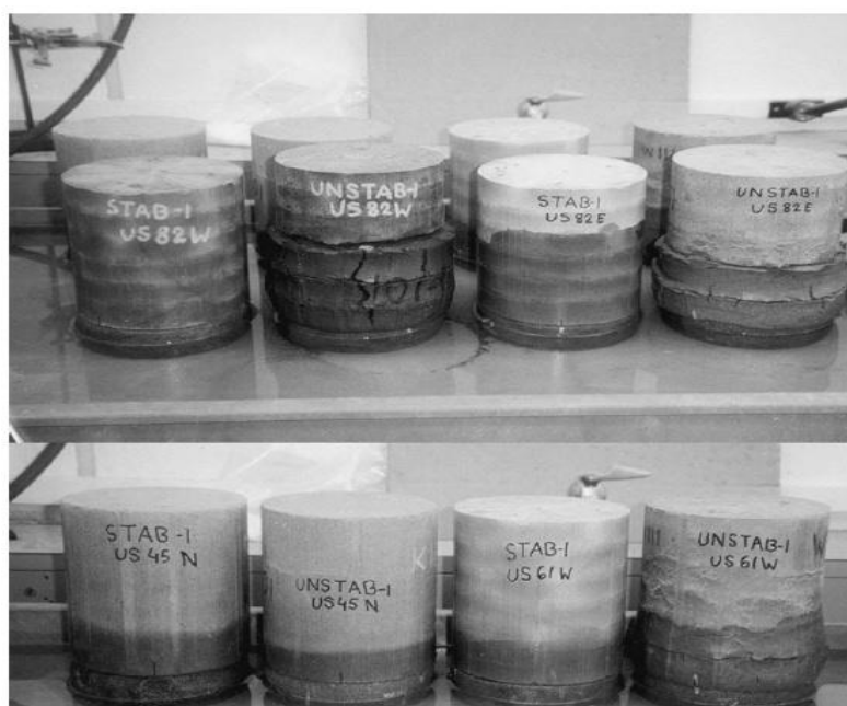
Figura 3.4: Corpos de prova de solo e de solo cal submetidos à saturação por capilaridade durante 24 horas. FONTE: Yusuf et al. 2001
