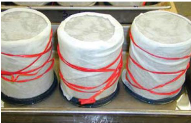
Figura 3.3: Corpos de prova submetidos à ação deletéria da água por capilaridade.
