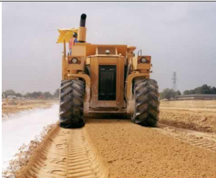
Figura 2.7: Equipamento com misturador rotativo para a mistura preliminar de solo cal. Fonte: NLA (2004)
