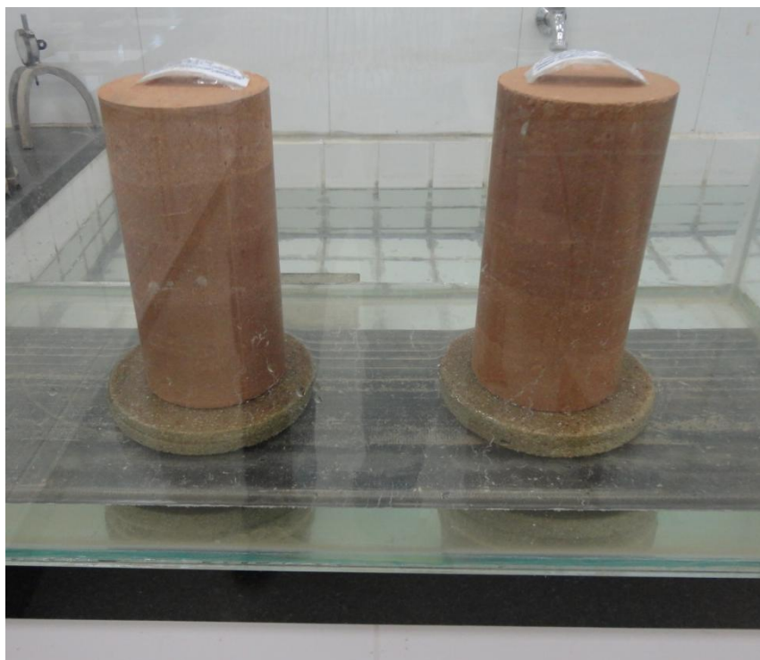
Figura 3.5: Adaptação realizada no Centro de Pesquisas Rodoviárias da Concessionária CCRNovaDutra para Saturação dos corpos de prova por capilaridade
