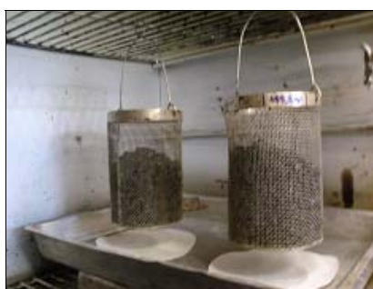
Figura 79: Cestas de arame suspensas sobre os papéis dentro da estufa para ensaio de escorrimento nesta pesquisa.
