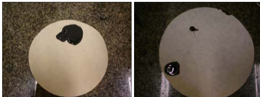
Figura 80: Ensaio de escorrimento da mistura CPA com 6,0% de ligante e 0,0% e 0,4% de fibras.
