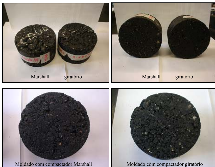
Figura 3: Exemplos de corpos de prova de CA moldados com compactadores Marshall e giratório.
