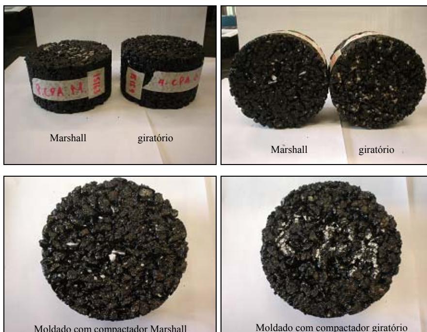
Figura 6: Exemplos de corpos de prova de CPA moldados com compactadores Marshall e giratório.
