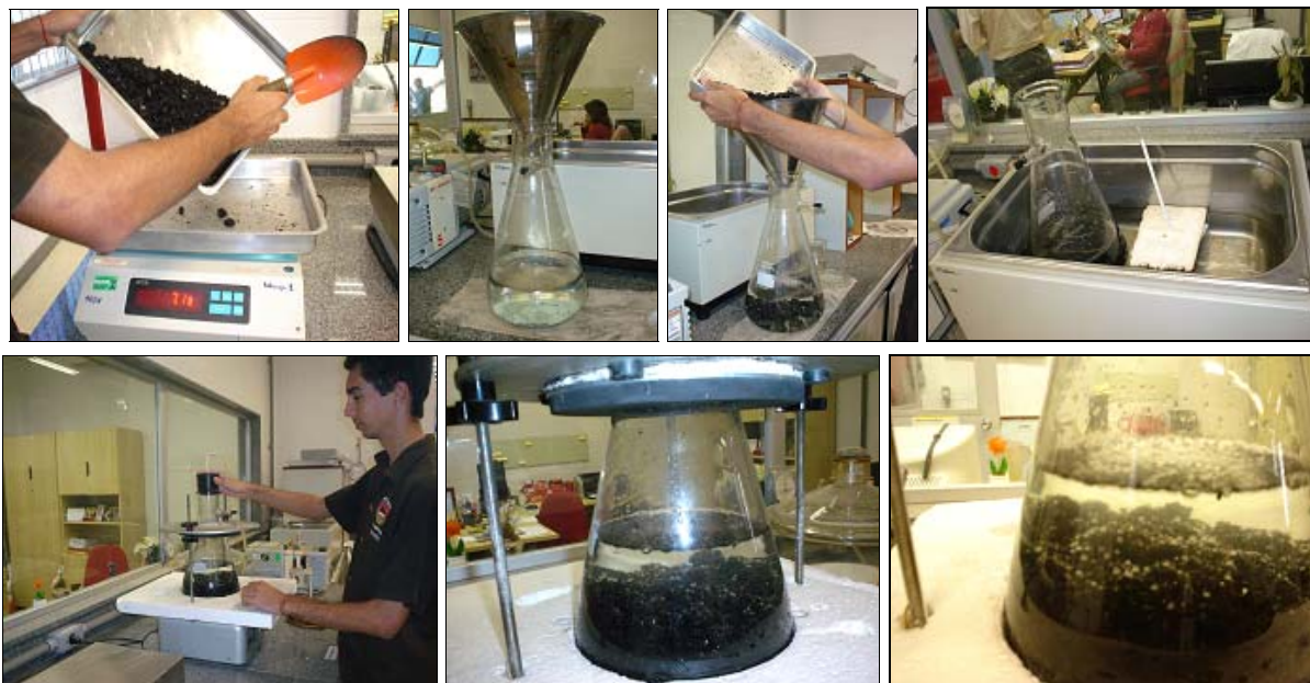
Figura 9: Ensaio Rice de determinação da densidade máxima de misturas não compactadas.
