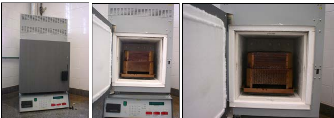
Figura 48: Forno utilizado para realizar a extração do ligante.
