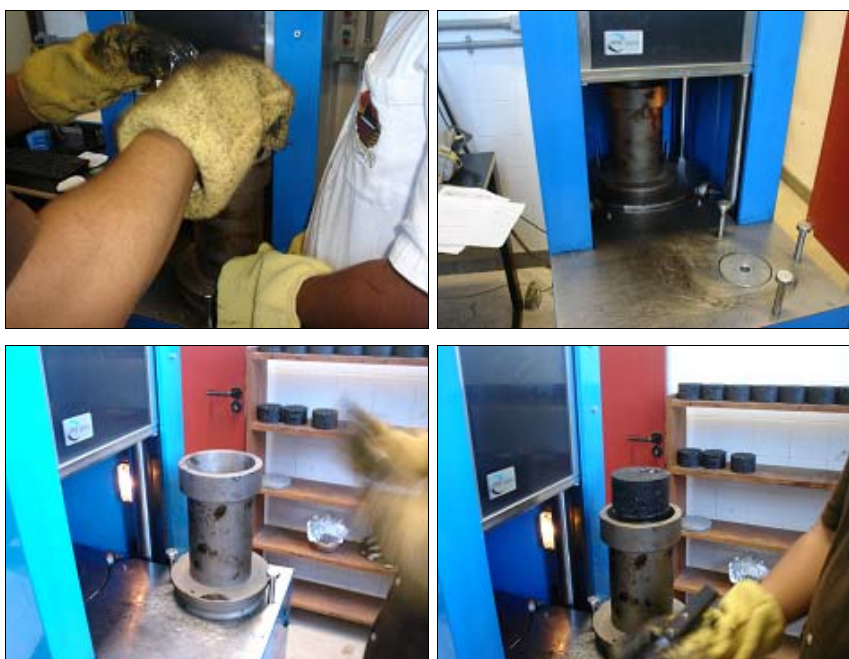
Figura 13: Moldagem de CPs com compactador giratório.
