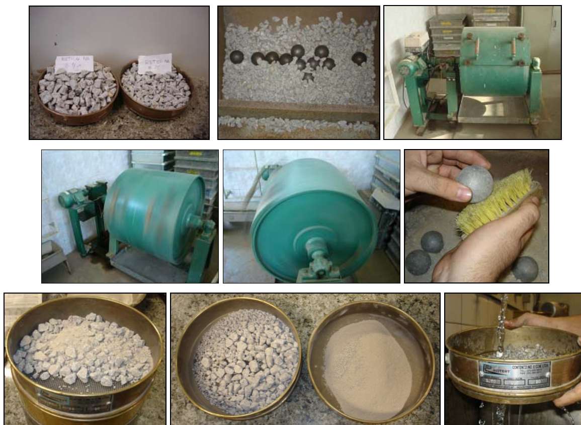
Figura 7: Ensaio de desgaste por abrasão Los Angeles.
