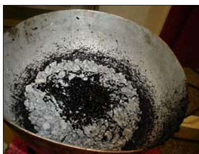
Figura 77: Exemplo da preparação da mistura asfáltica CPA com adição da fibra de celulose nesta pesquisa.
