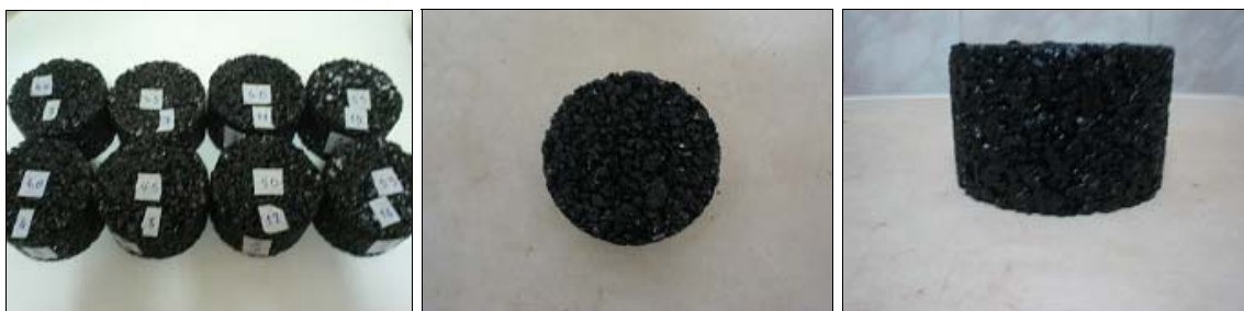
Figura 75: Corpos de prova de CPA antes de realizar o ensaio de desgaste Cantabro nesta pesquisa.
