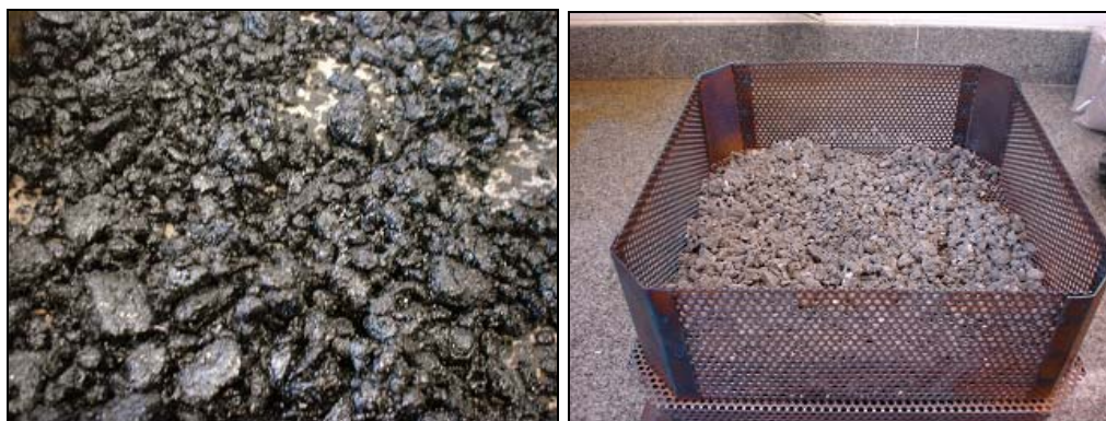
Figura 49: Mistura de SMA antes e após a extração do ligante.
