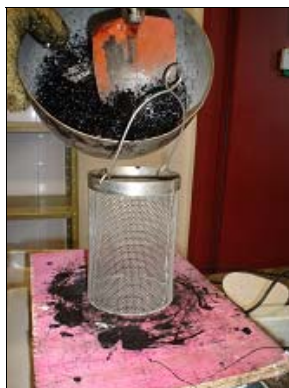
Figura 78: Mistura asfáltica sendo colocada dentro da cesta de arame para ensaio de escorrimento nesta pesquisa.
