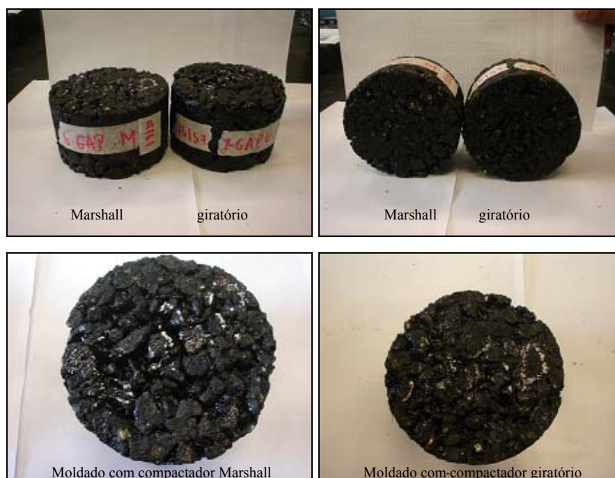
Figura 5: Exemplos de corpos de prova de GG moldados com compactadores Marshall e giratório.
