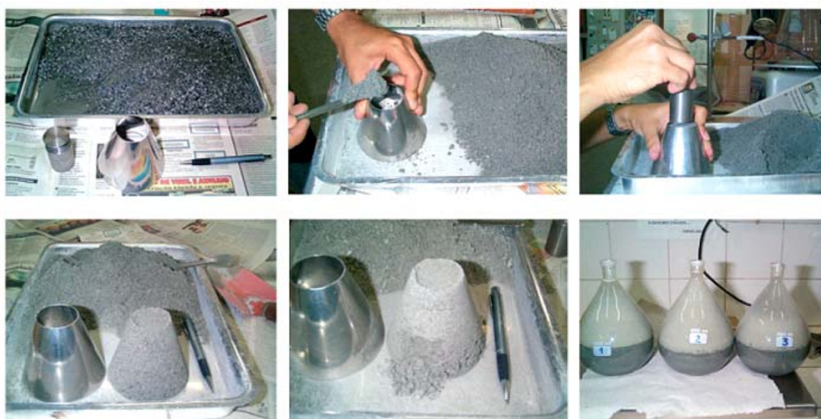
Figura 8: Ensaio de massa específica de agregados miúdos - método ASTM C 128.
