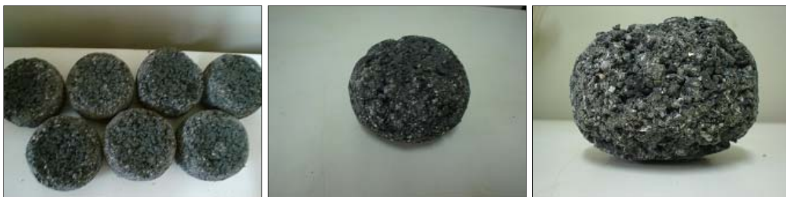
Figura 76: Corpos de prova de CPA após a realização do ensaio de desgaste Cantabro nesta pesquisa.
