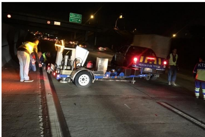
Figura 4: Levantamento com uso de FWD
