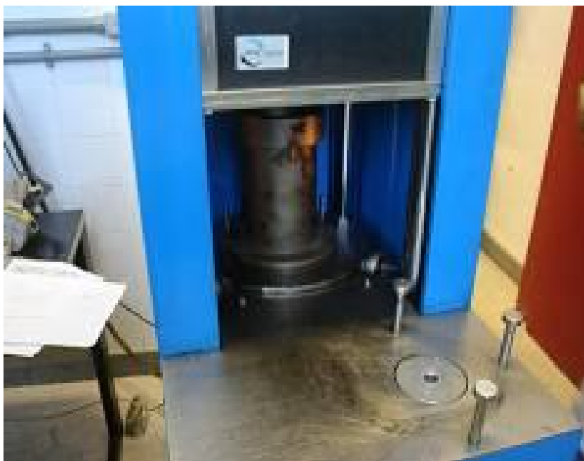
Figura 3.10: posicionamento do molde de compactação no CGS
