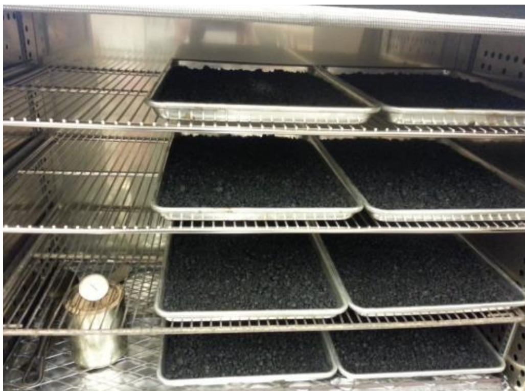
Figura 3.9: Condicionamento da mistura asfáltica em estufa durante 2 horas
