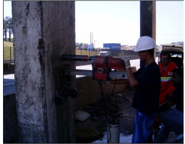
Figura 3.3 - Extração de amostras de concreto das pontes, viga e pilar
