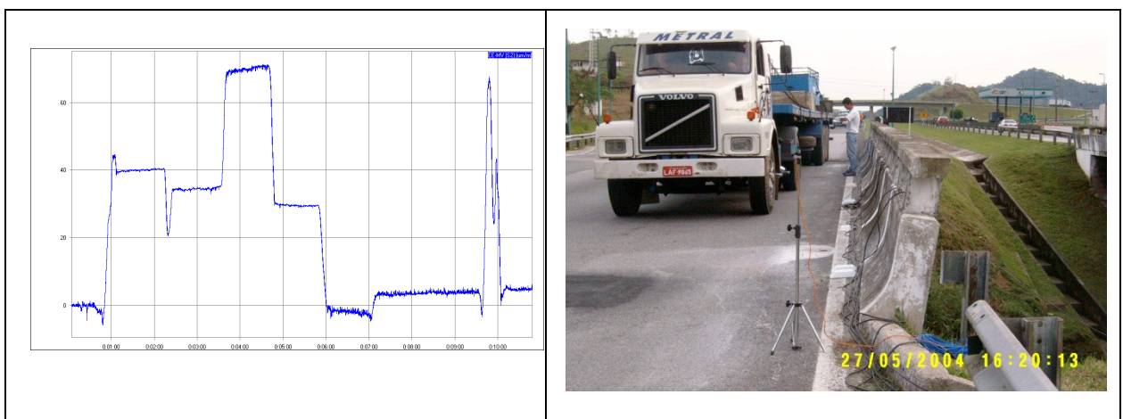
Figura 3.11 - Série temporal de deformações específicas medidas na armadura no meio do vão central da longarina durante ensaios quase-estáticos, Ponte sobre Rio Escuro
