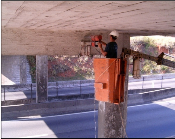
Figura 3.3 - Extração de amostras de concreto das pontes, viga e pilar
