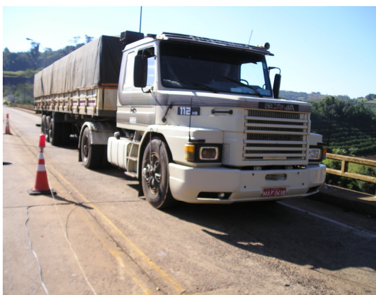
Figura 3.13 - Veículo de prova empregado nos ensaios dinâmicos e instrumentação da suspensão do veículo
