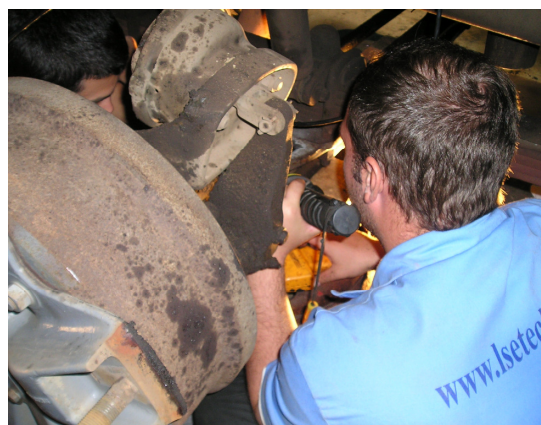
Figura 3.13 - Veículo de prova empregado nos ensaios dinâmicos e instrumentação da suspensão do veículo
