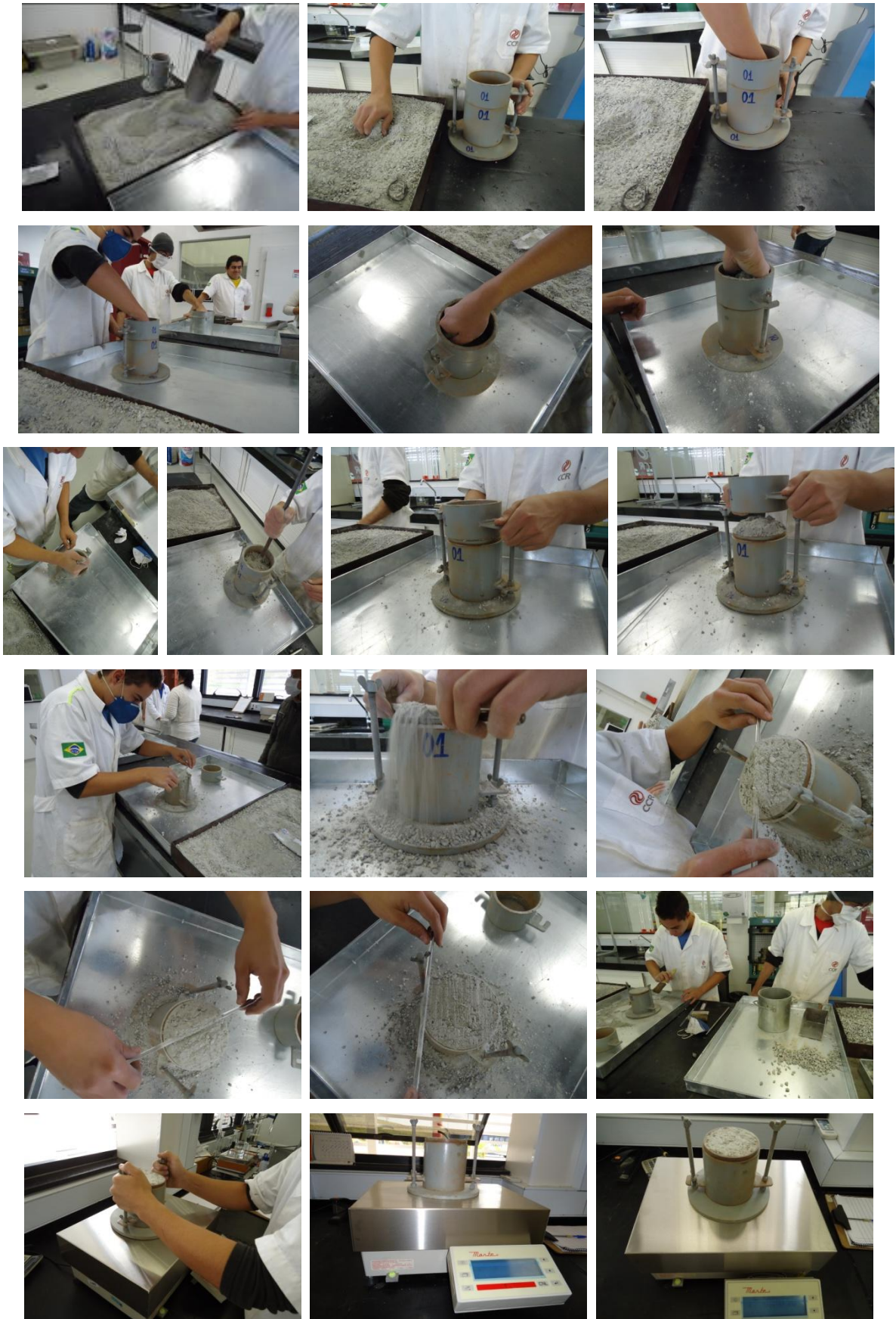
Figura 2: Determinação da massa específica solta do agregado miúdo (pó de pedra) (Fotos de Charles Magno e Ronaldo Aparecido dos Santos).
