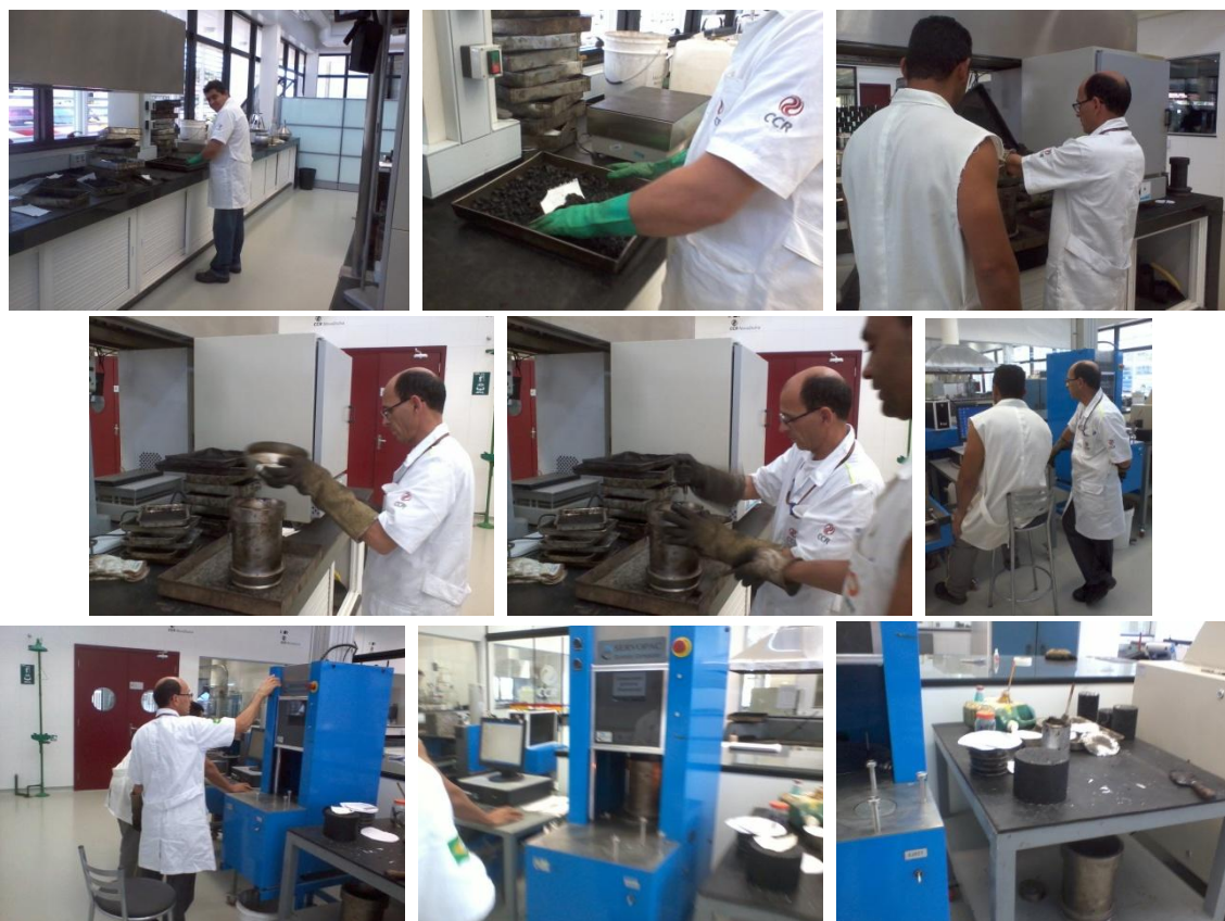
Figura 7: Aula prática de dosagem Superpave – moldagem de CP com o compactador giratório.
