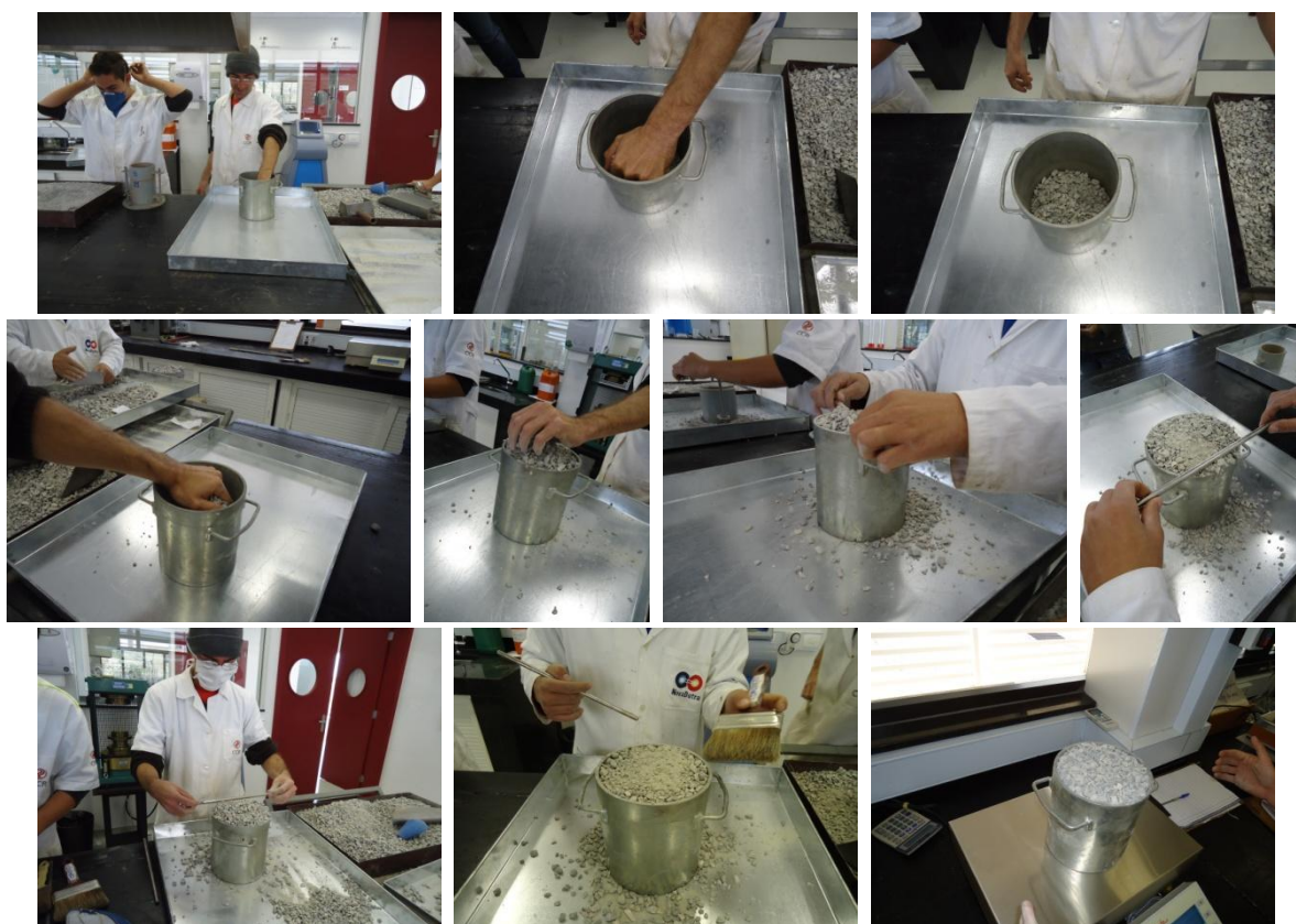
Figura 4: Determinação da massa específica compactada do agregado graúdo (Brita 0) (Fotos de Charles Magno e Ronaldo Aparecido dos Santos).
