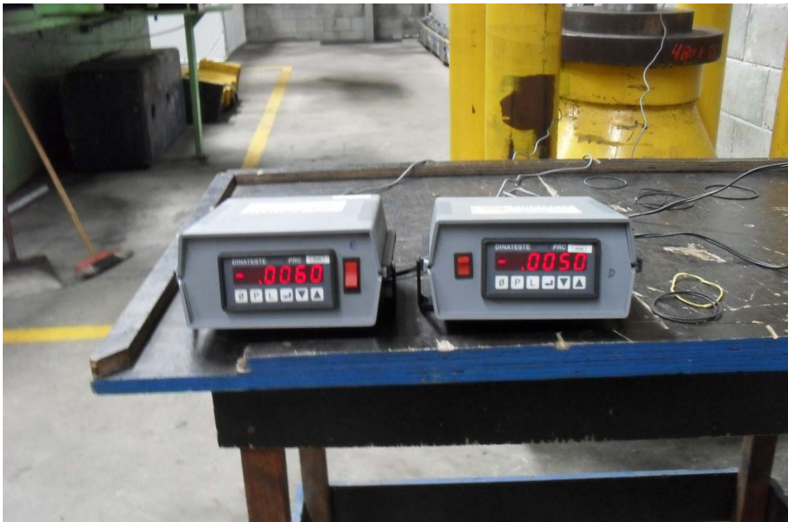
Figura 4.3 - Leitura dos deslocamentos verticais diametralmente opostos, nos clip-gages
