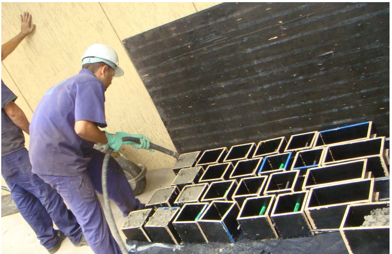
Figura 3.25 - Moldagem dos corpos-de-prova com cura em repouso dos lotes 5 e 6
