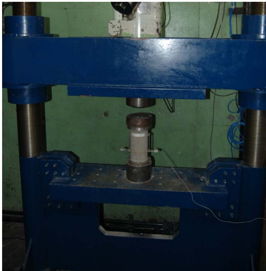
Figura 4.1 - Arranjo do ensaio de compressão simples para os lotes 1 a 4 na MED
