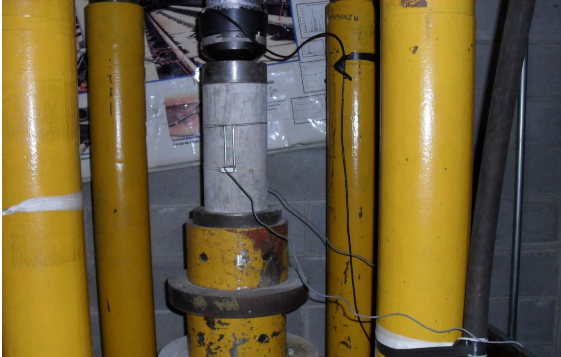
Figura 4.2 - Arranjo do ensaio de compressão simples para os lotes 5 e 6 na MEC
