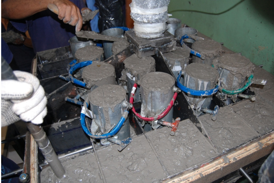
Figura 3.22 - Moldagem dos corpos-de-prova dos lotes 1 a 4 na plataforma vibratória
