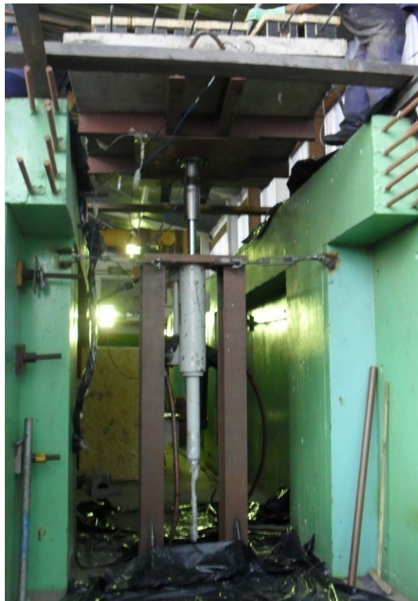
Figura 3.10 – Foto da plataforma apoiada na haste do atuador durante a moldagem dos corpos-de-prova dos lotes 5 e 6
