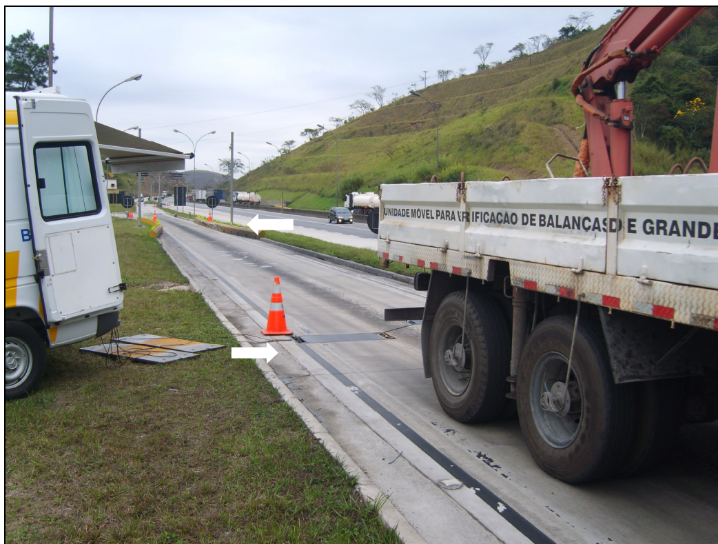
Figura 7 – Verificação metrológica das balanças de pesagem de veículos em movimento
