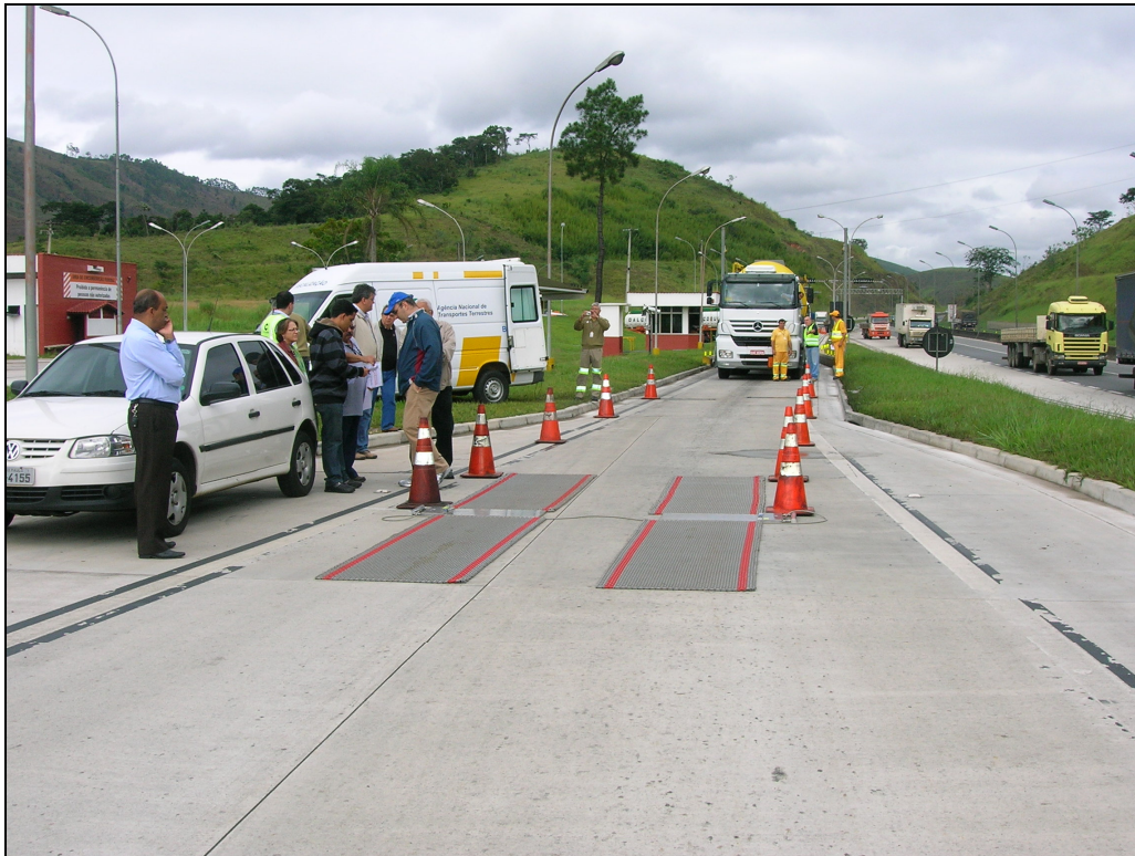
Figura 5 - Instalação do instrumento de pesagem estática portátil por eixo
