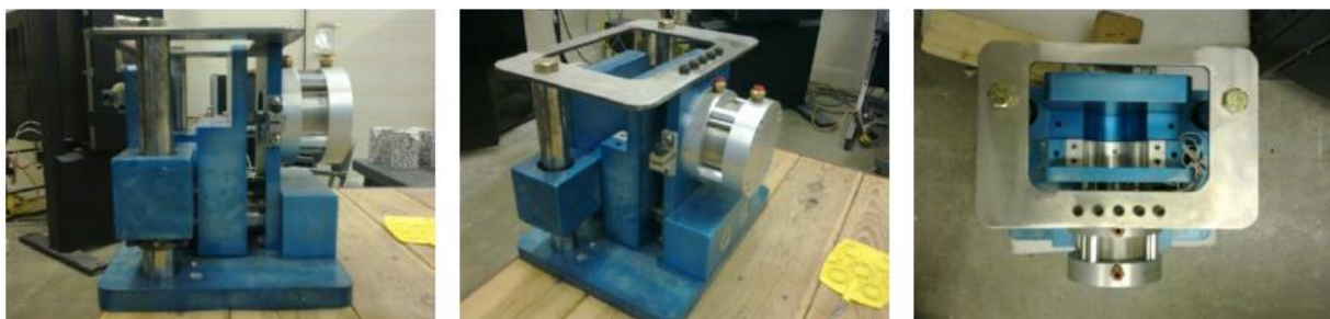
Figura 3.22: Equipamento para avaliação de aderência entre camadas de pavimentos.
