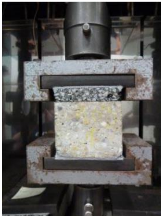
Figura 3.16; Ensaio de tração direta BBRC. FONTE: Destreé et al. (2012)
