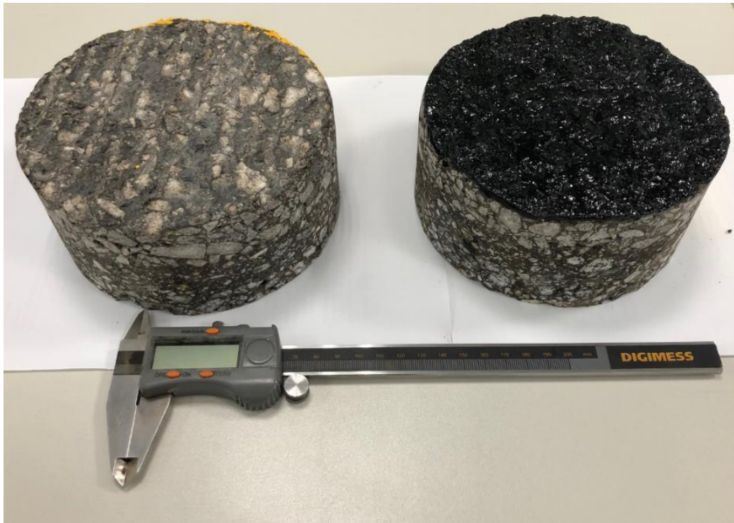
Figura 5.13: Aplicação da pintura de ligação em corpos de prova com a superfície fresada
