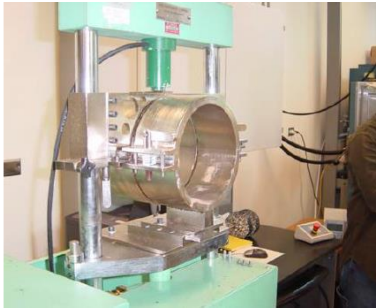
Figura 3.14: Equipamento de cisalhamento direto desenvolvido no FDOT. FONTE: West et al. (2005)
