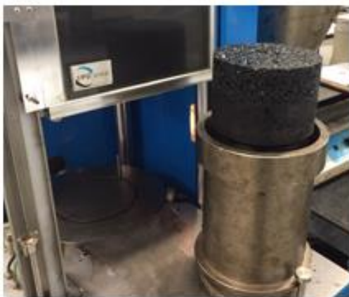
e) Desmoldagem do CP no CGS
