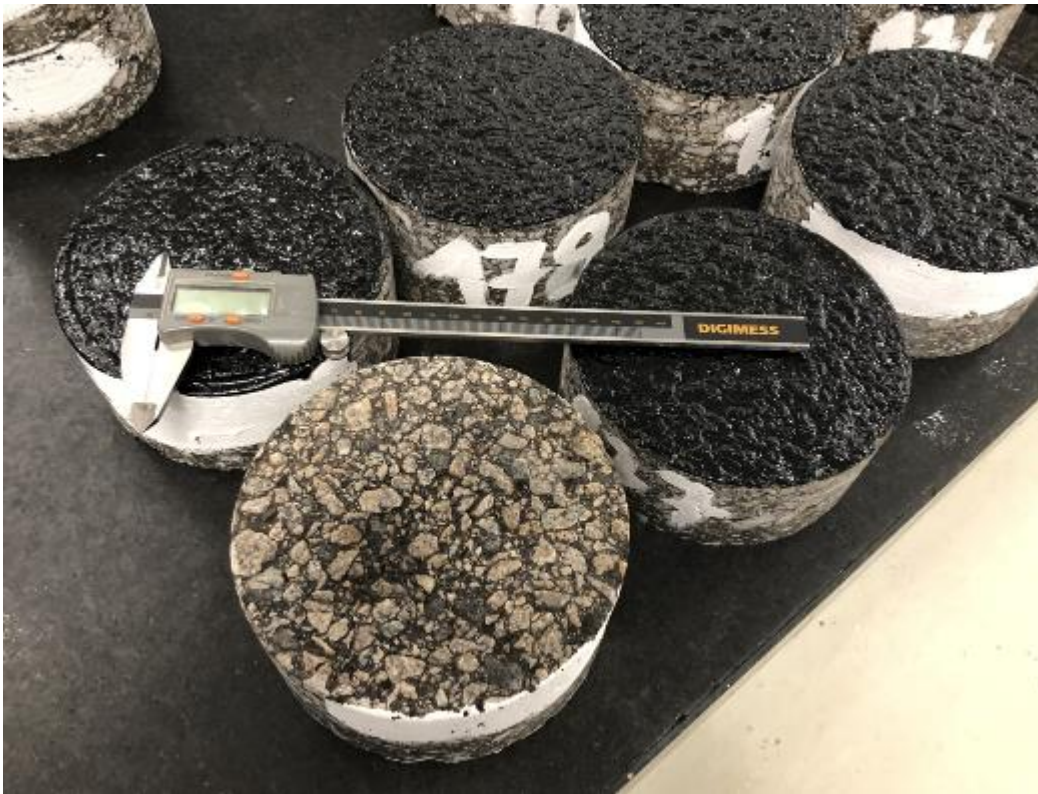
Figura 5.10: Aplicação da pintura de ligação em corpos de prova oxidados
