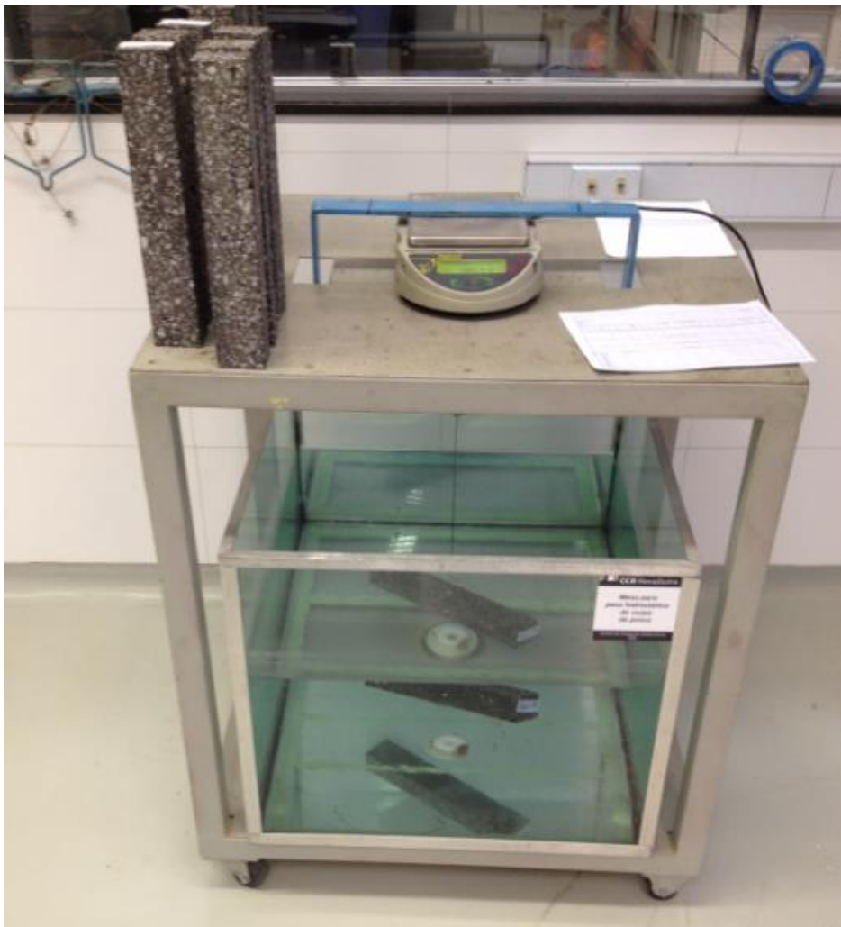
Figura 4.21: Controle do volume de vazios dos corpos de prova empregados no ensaio de fadiga
