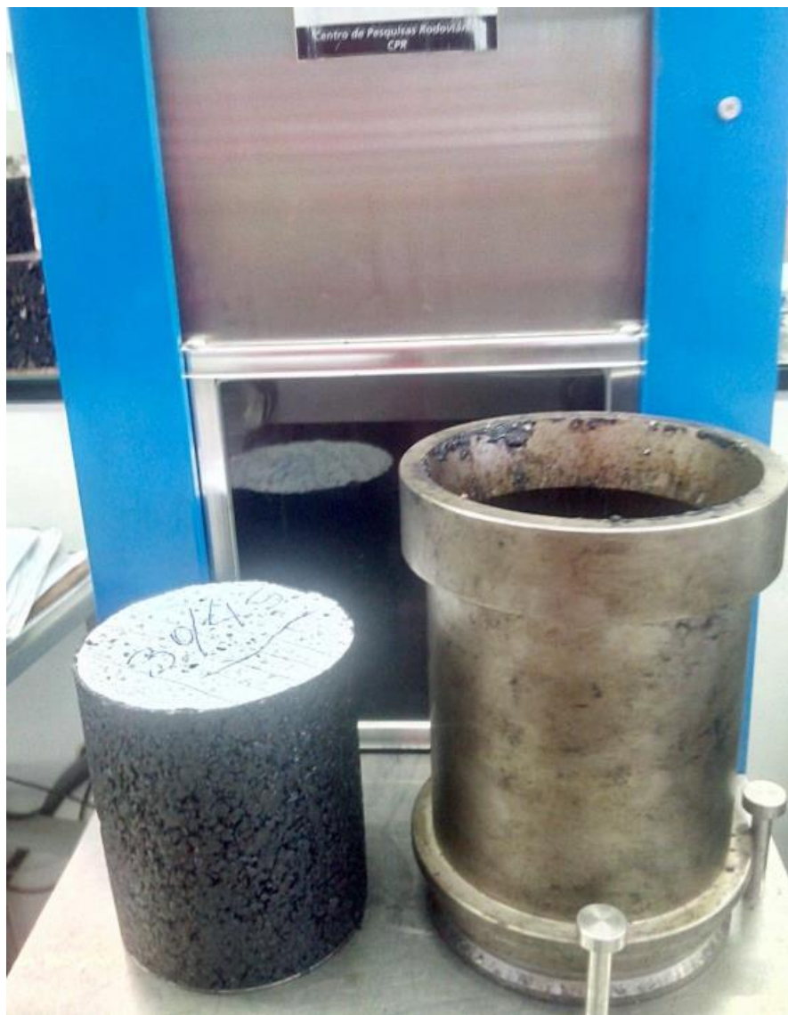
Figura 4.12: Corpo de prova produzido no Compactador Giratório Superpave
