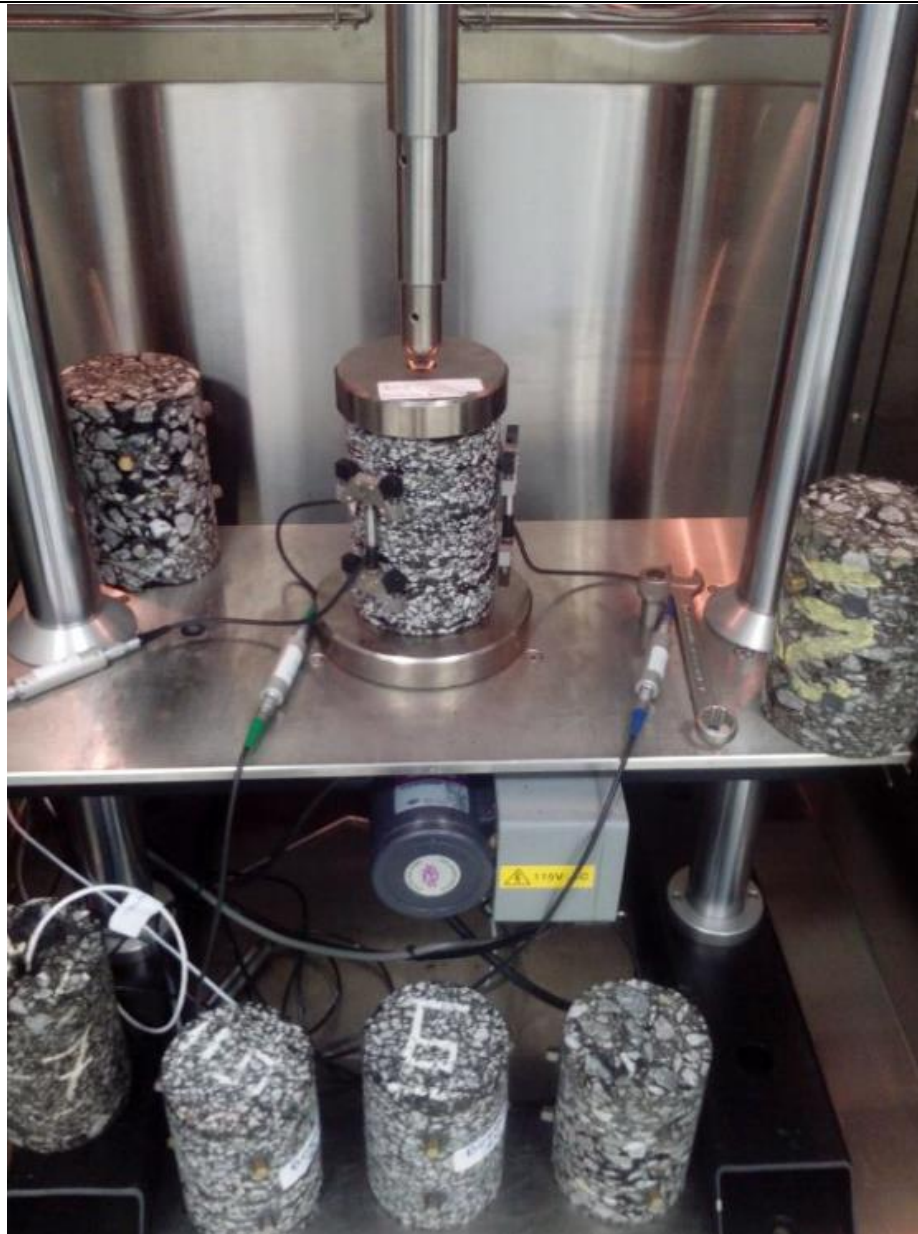
Figura 4.13: Corpos de provas empregados no ensaio de módulo dinâmico das misturas asfálticas
