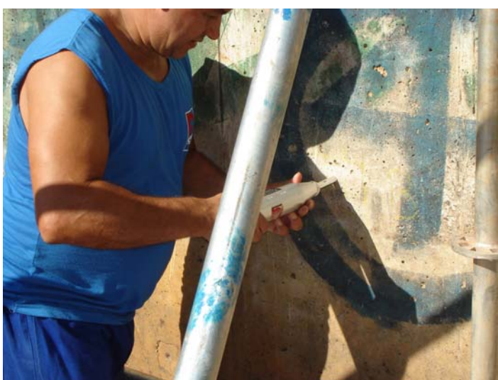
Figura 72: ensaio de esclerometria em torno da região de extração
