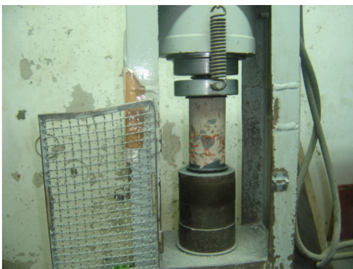
Figura 75: ensaio de ruptura à compressão axial em prensa normalizada
