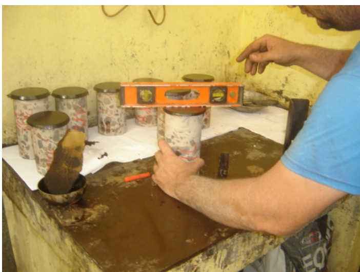
Figura 74: capeamento com enxofre para regularização e nivelamento dos cp's
