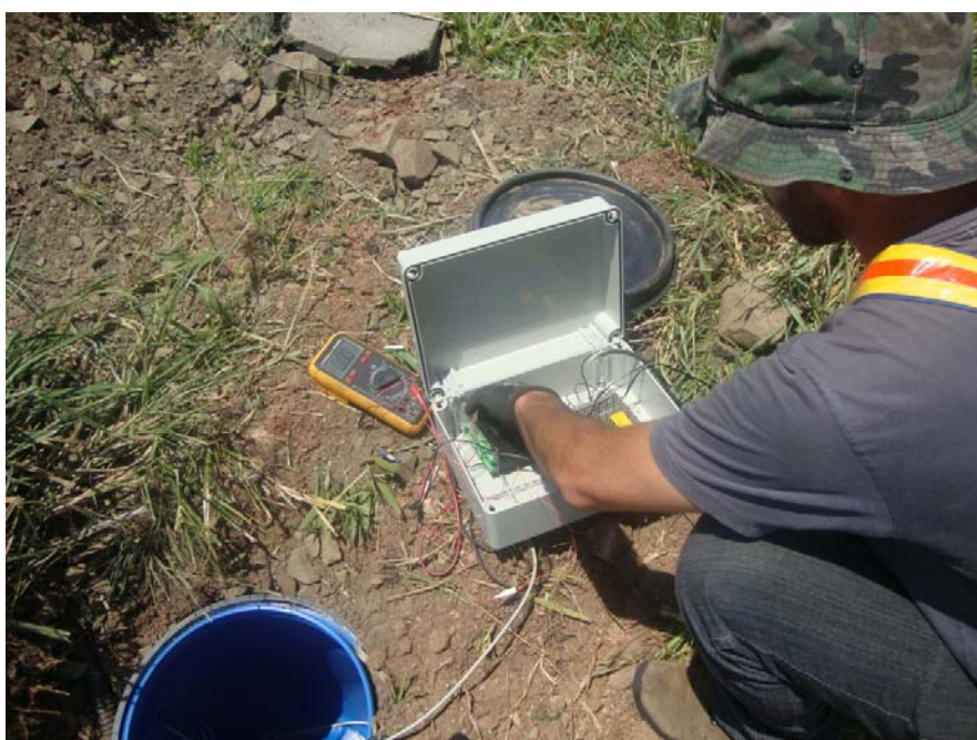
Figura 54: Montagem do sistema de aquisição eLogger.
