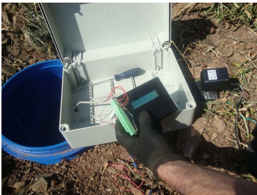
Figura 56: Ligação, em campo, do equipamento do sistema de aquisição eLogger
