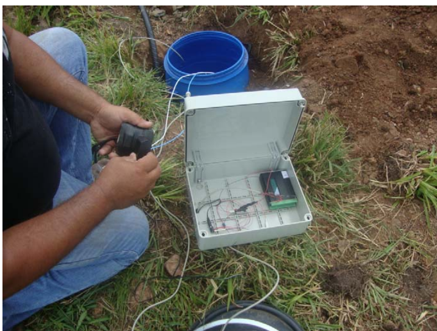
Figura 52: Montagem do sistema de aquisição eLogger equipamento desenvolvido nesta pesquisa.
