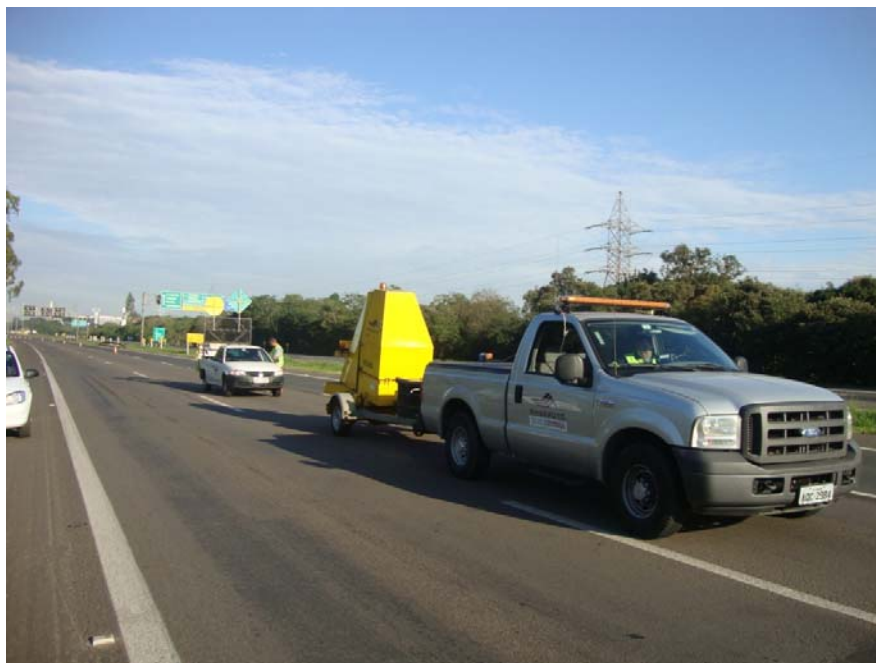
Figura 68: Veículo de apoio e FWD em campo
