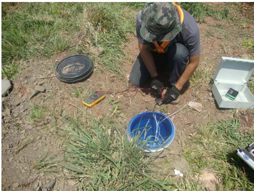
Figura 53: Montagem do sistema de aquisição eLogger dentro de um recipiente – bombona – para evitar infiltração de água.
