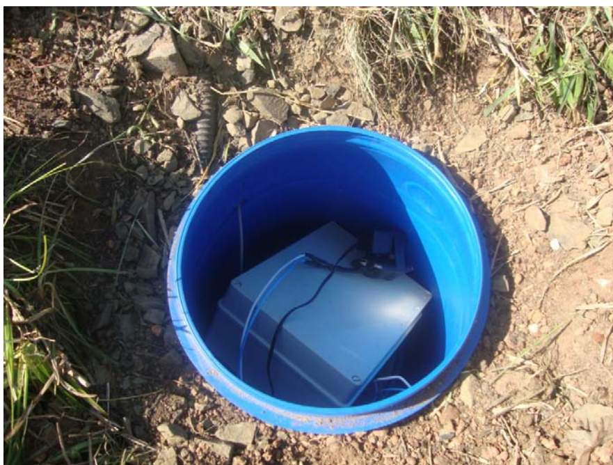
Figura 58: Equipamento do sistema de aquisição eLogger instalado em campo.
