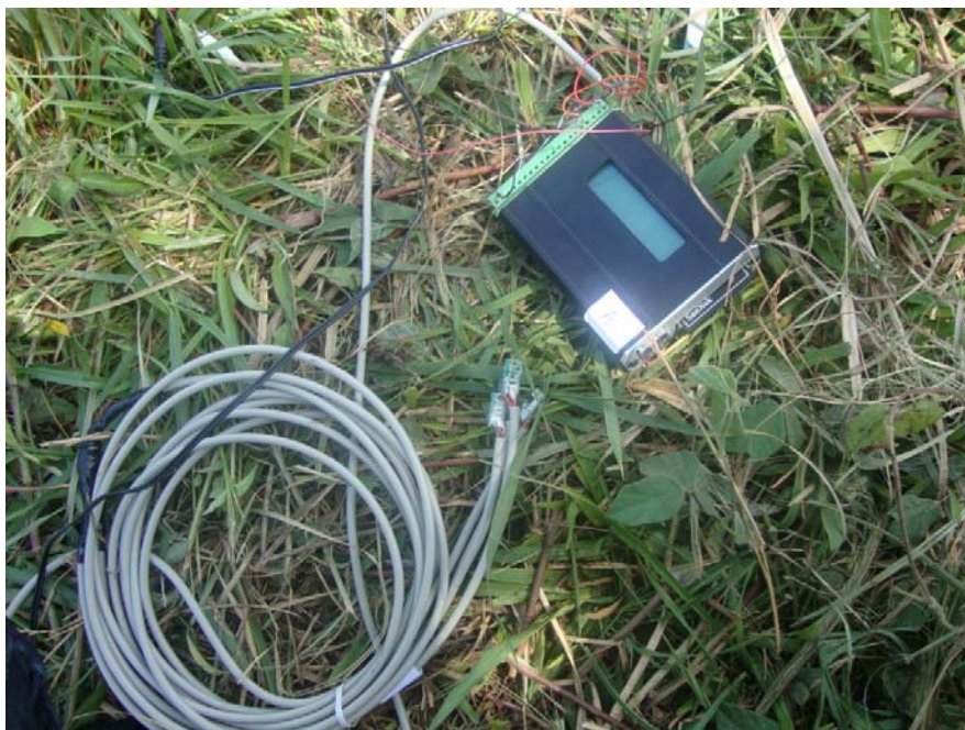
Figura 39: Sistema de aquisição eLogger desenvolvido nesta pesquisa.
