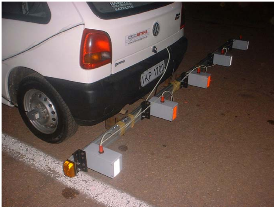
Figura 71: Perfilômetro inercial laser acoplado em veículo
