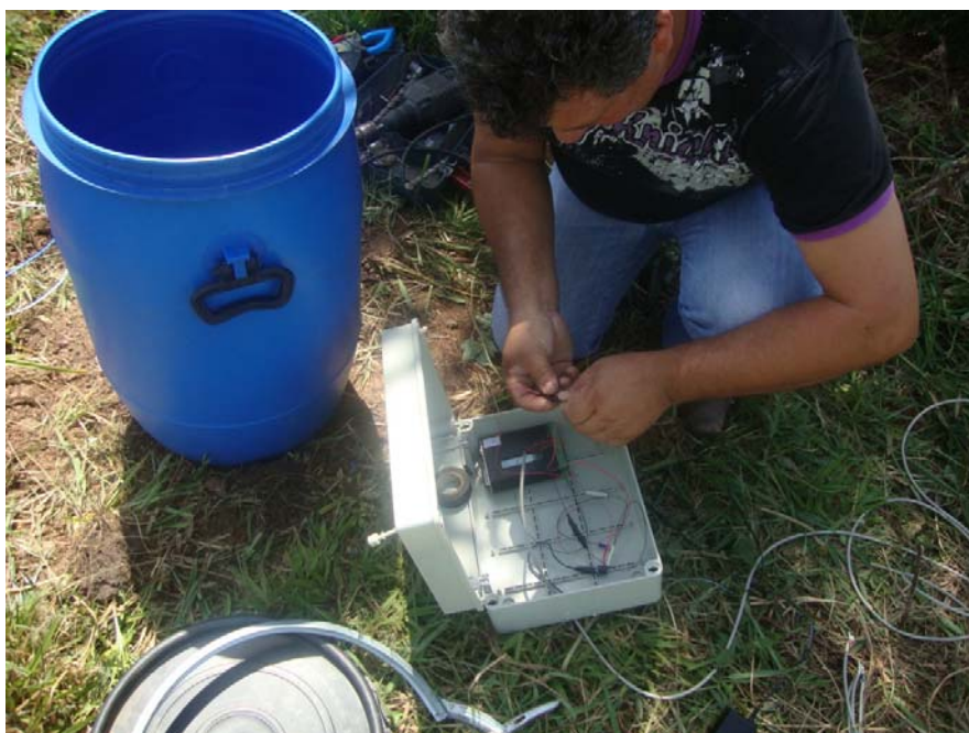
Figura 51: Montagem do sistema de aquisição eLogger equipamento desenvolvido nesta pesquisa.
