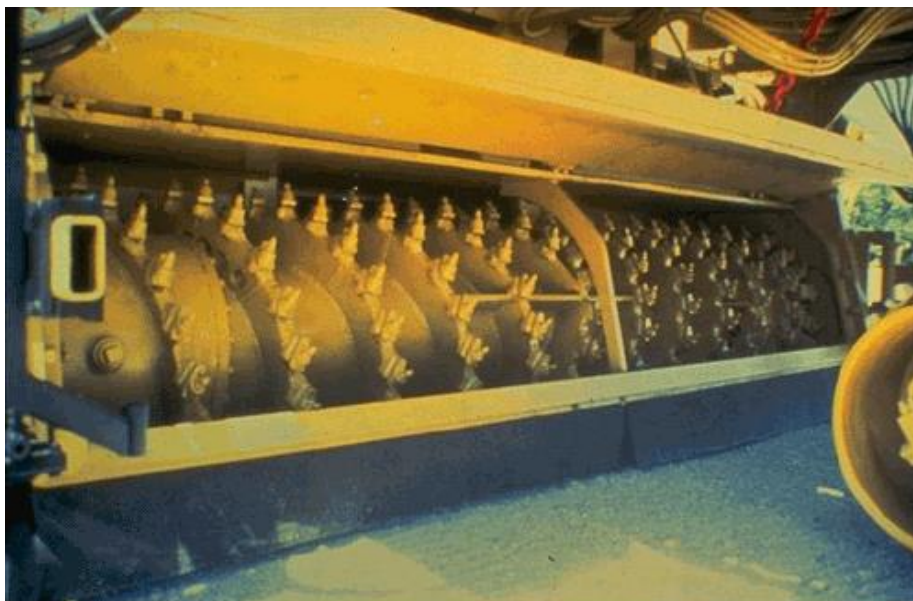
Figura 6: Vista do cilindro fresador de uma máquina fresadora
