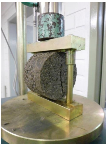
Figura 38: Ensaio de resistência à tração por compressão diametral.
