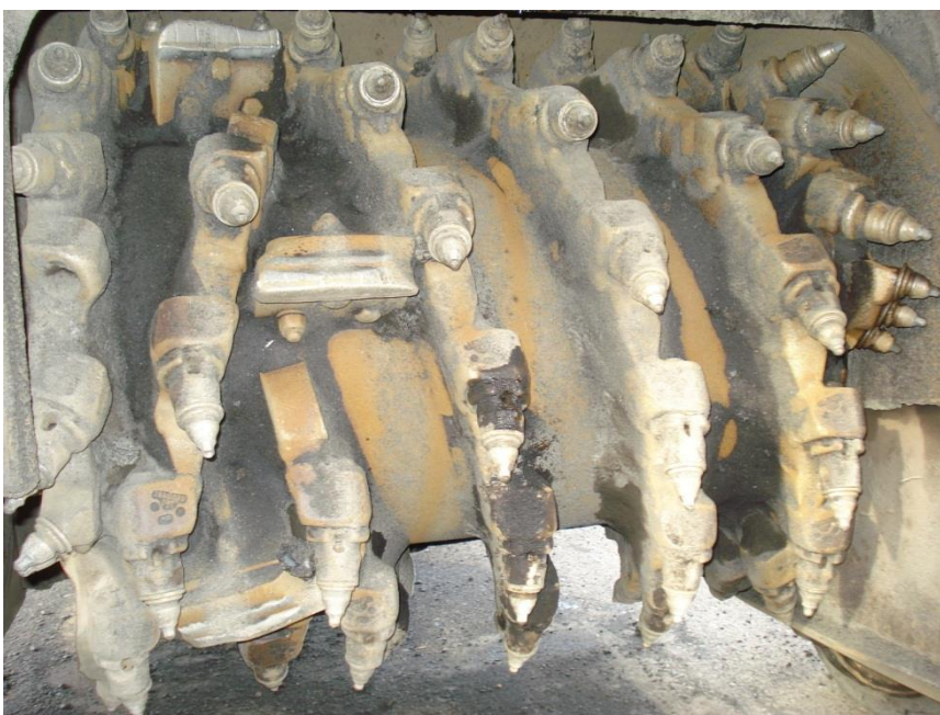
Figura 31: Detalhe do cilindro de corte da fresadora Caterpillar PM102
