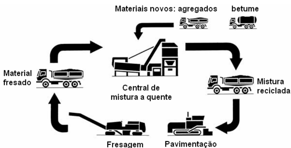
Figura 26: Esquema do processo de reciclagem a quente em usina.
