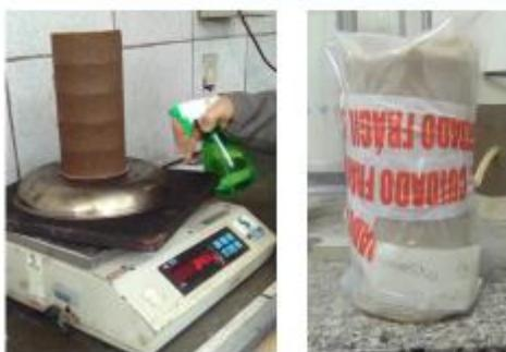
✓ Amostras moldadas em condições de umidade pré-determinadas, submetidos a umedecimento e secagem.
