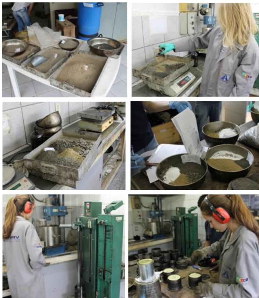
Figura 93 – Preparação de material para mistura asfáltica – auxílio em pesquisas a nível de mestrado e doutorado
